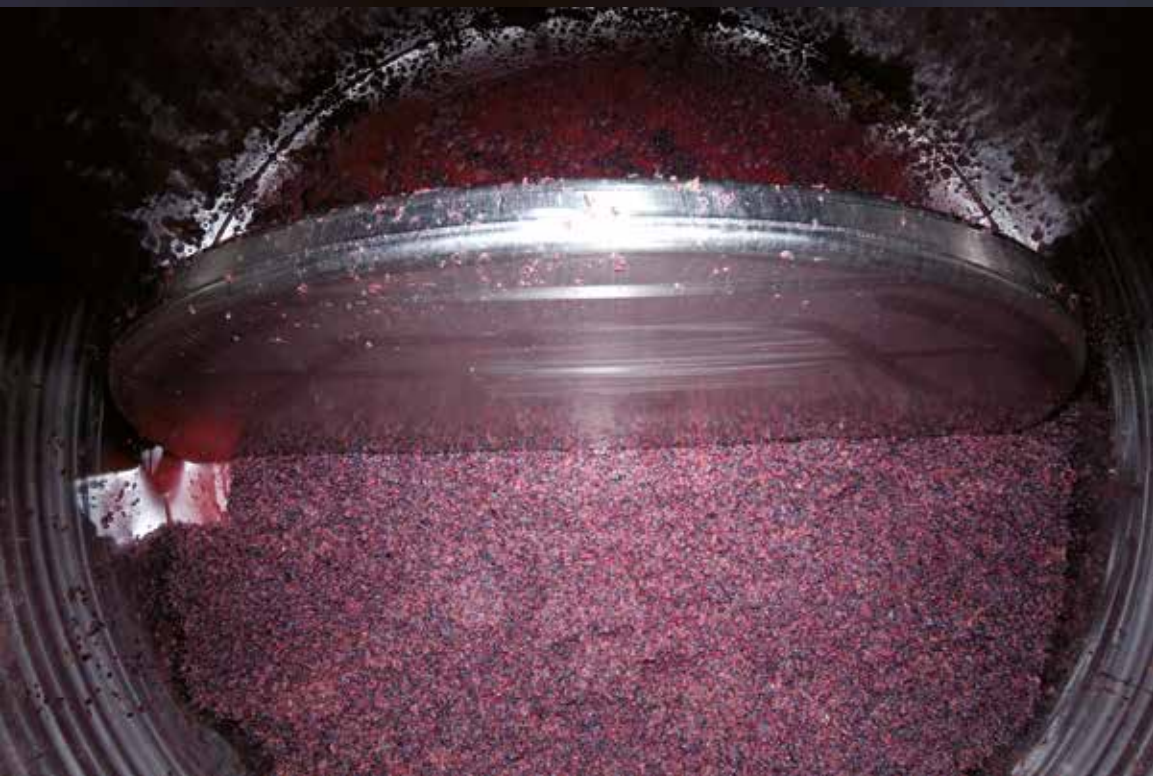
Pala rotante, brevettata Albrigi, posta in verticale con vinaccia appassita, in fase di pausa
