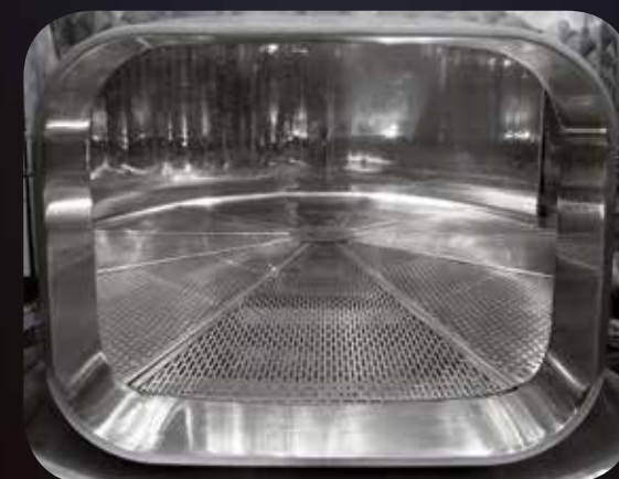
Griglia mobile sul fondo per separare e drenare l'uva dal mosto
