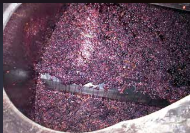
Pala di follatura che affonda nelle vinacce autopulente brevettata Albrigi
