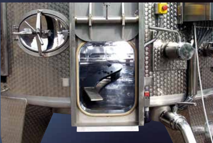
Porta con apertura a ghigliottina con meccanismo di scarico meccanico delle vinacce "Meccanotank"
