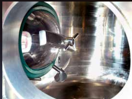
Portella aperta con braccio di sostegno interno
