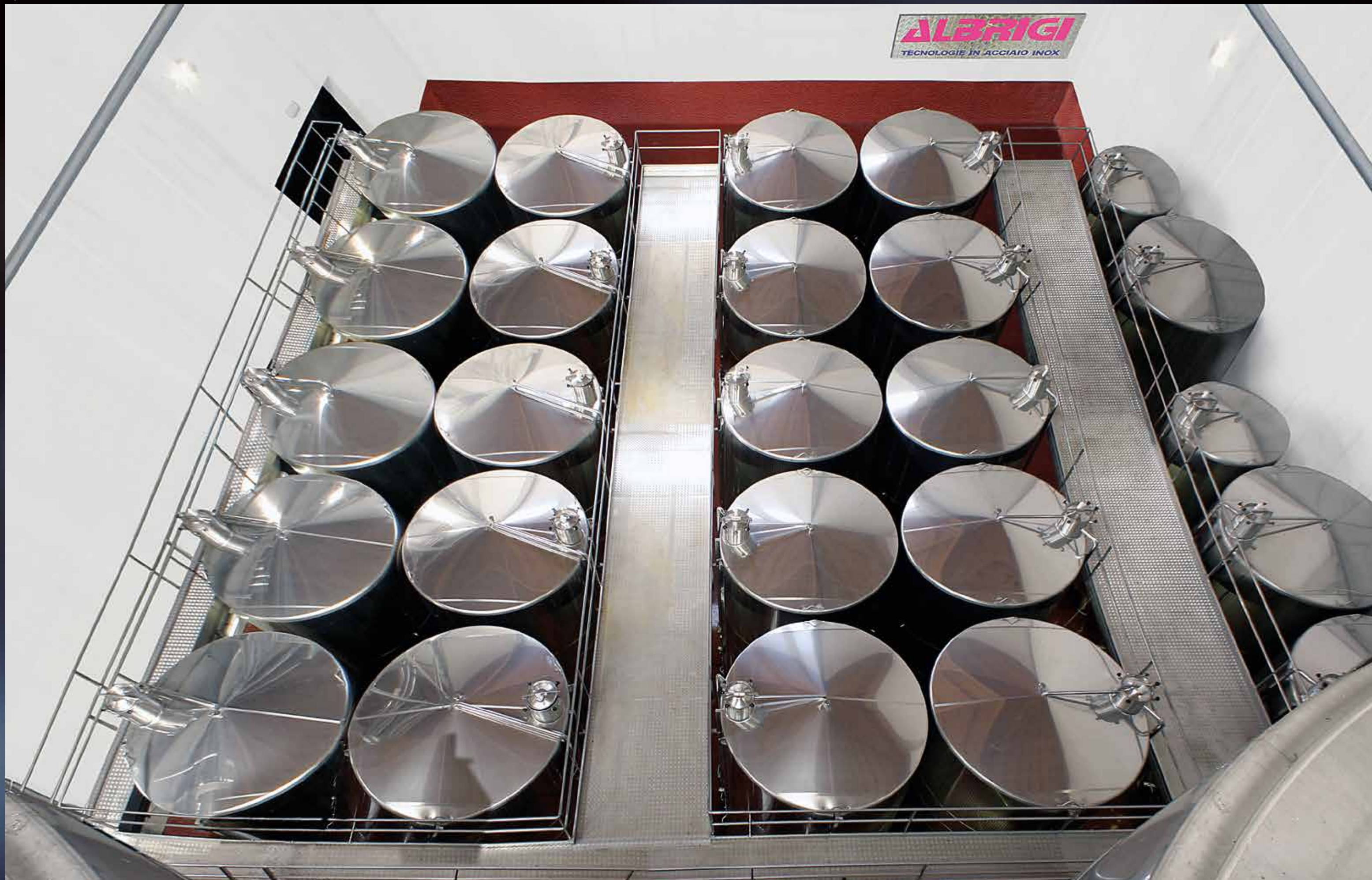
Cantina di stoccaggio composta da Vinotank da hl 300 con impianto di lavaggio Cleanfix
