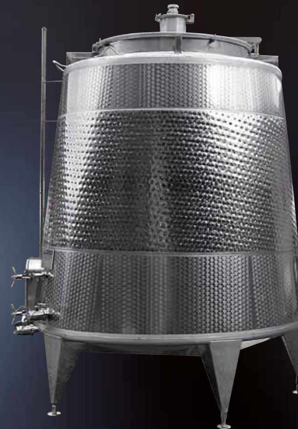
Vista laterale di Tinotank con fondo piano inclinato del 3% in avanti ed intercapedine Thermostat
