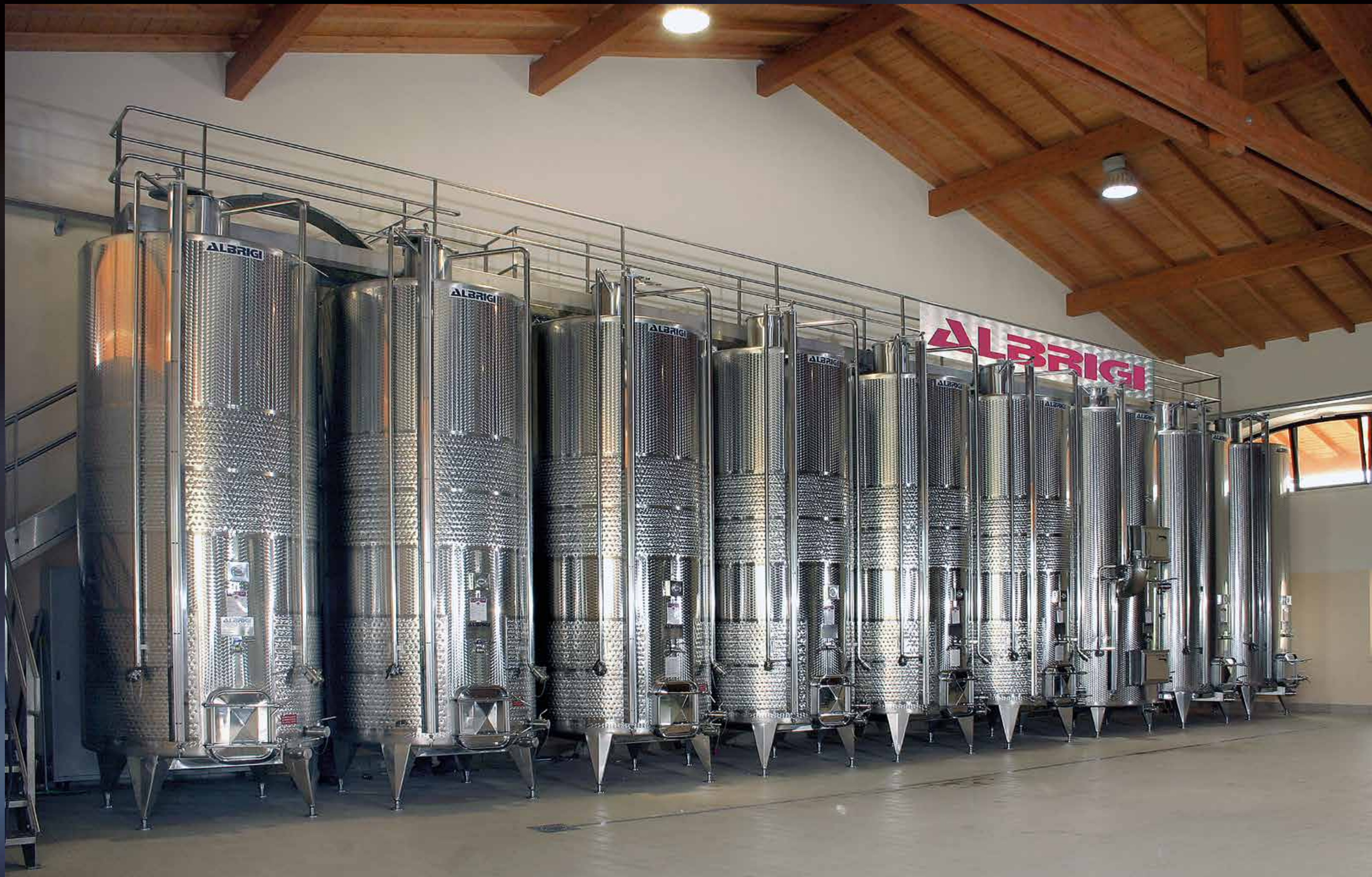
Specialtank Termo Double da 150 hl e Frigotank/Politank da hl 50 + hl100 termocondizionati con Termostar e isolati con Isotank e Vinotank da hl 150
