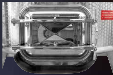
Porta di scarico delle vinacce
