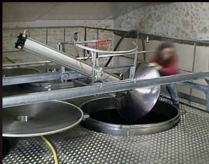
Uso e regolazione del meccanismo di follatura a monopiede autopulente brevettato Albrigi
