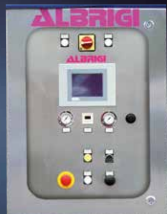
Quadro elettrico, in acciaio inox, completo di tenda di protezione in Pvc arrotolabile e PLC per programmare tutte le fasi di pausa/avoro
