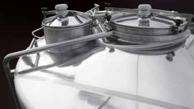
Vista dall'alto dei due chiusini
