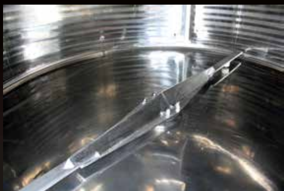
Pala di estrazione meccanica della vinaccia
