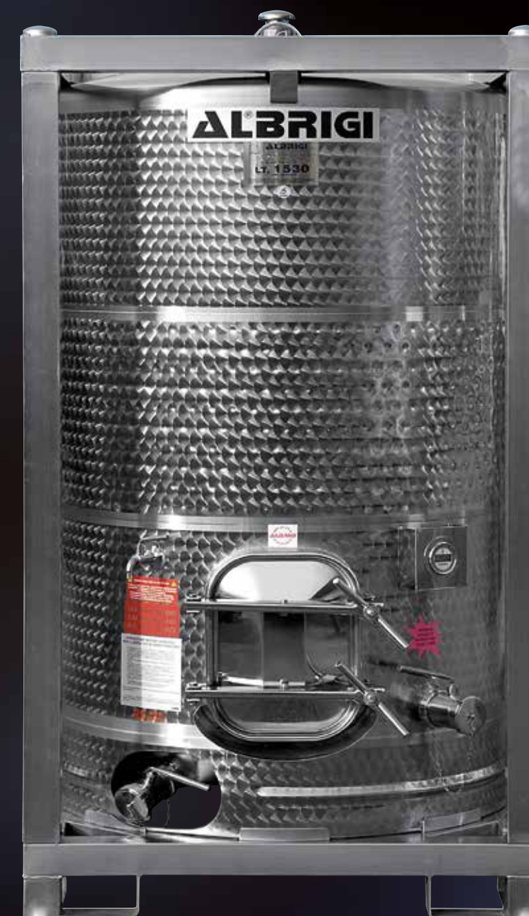
Enopallet da It 1530 con porta rettangolare e intercapedine di condizionamento, con termometro e sonda temperatura con 2 valvole ideale per microfermentazioni
