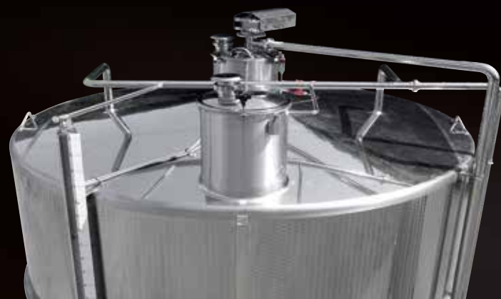
Cielo di fermentatore con doppio chiusura, irroratore Motofly motorizzato e impianto di lavaggio Cleanfix"
