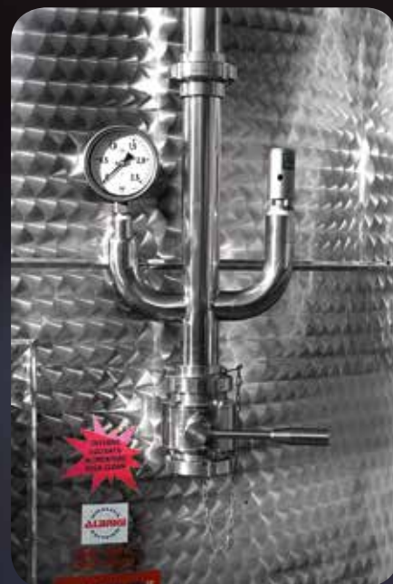
Gruppo di sicurezza con manometro e valvola di sicurezza tarata PED
