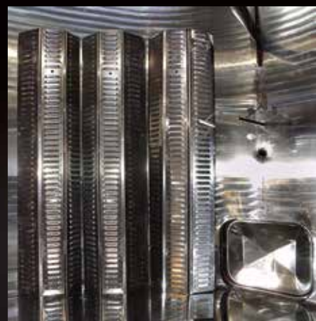
Serie di pannelli di griglie drenanti da mm 250x1000 mobili per fermare le bucce durante il délestage
