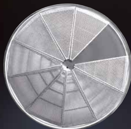
Vista dall'alto di meccanismo di griglia mobile poggia sul fondo per tenere separate le uve intere dal mosto
