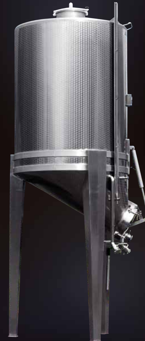
Il fondo a tronco di cono decentrato favorisce lo scarico delle vinacce per gravità
