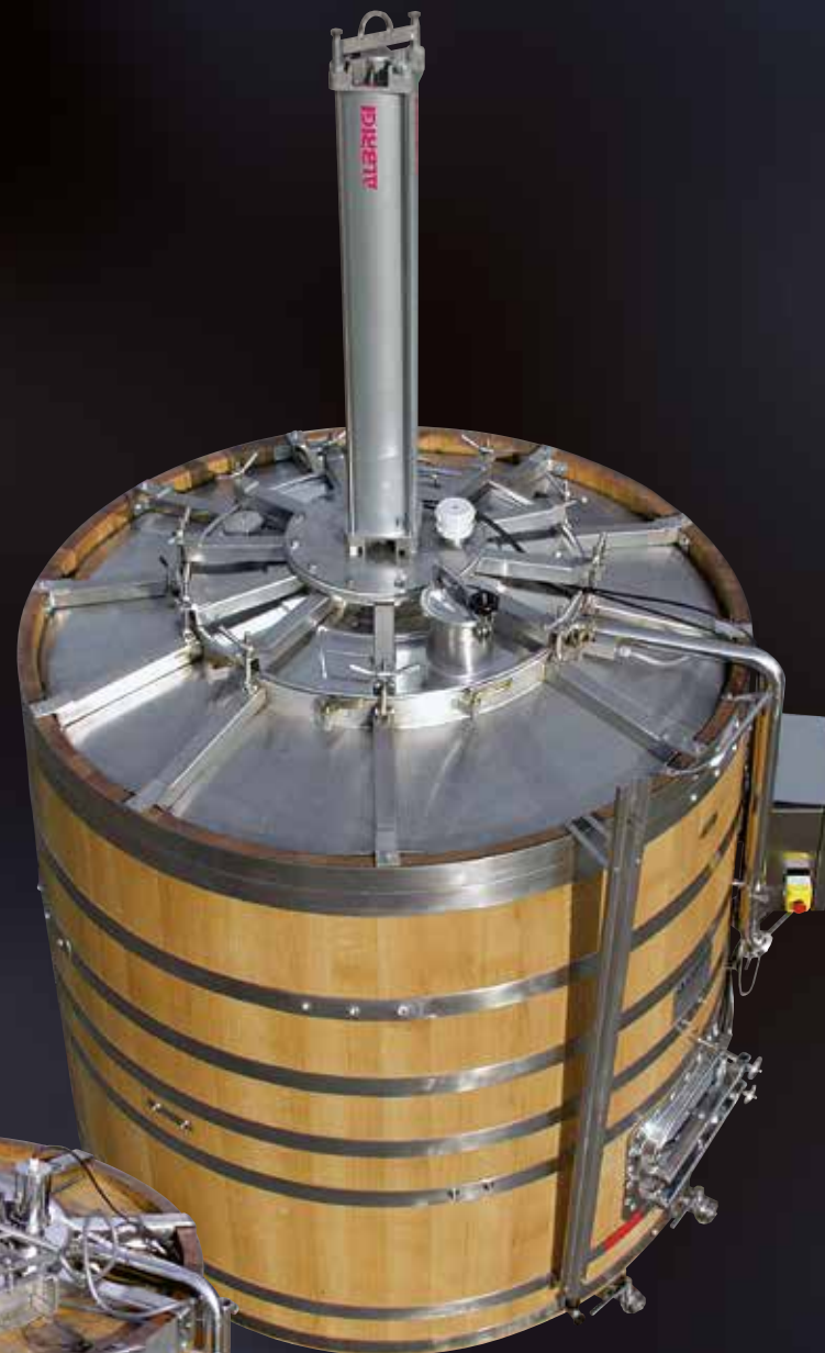
Vista di sistemi di rinforzo del cielo in acciaio e di legno su tini di legno con meccanismo Monofolltank
