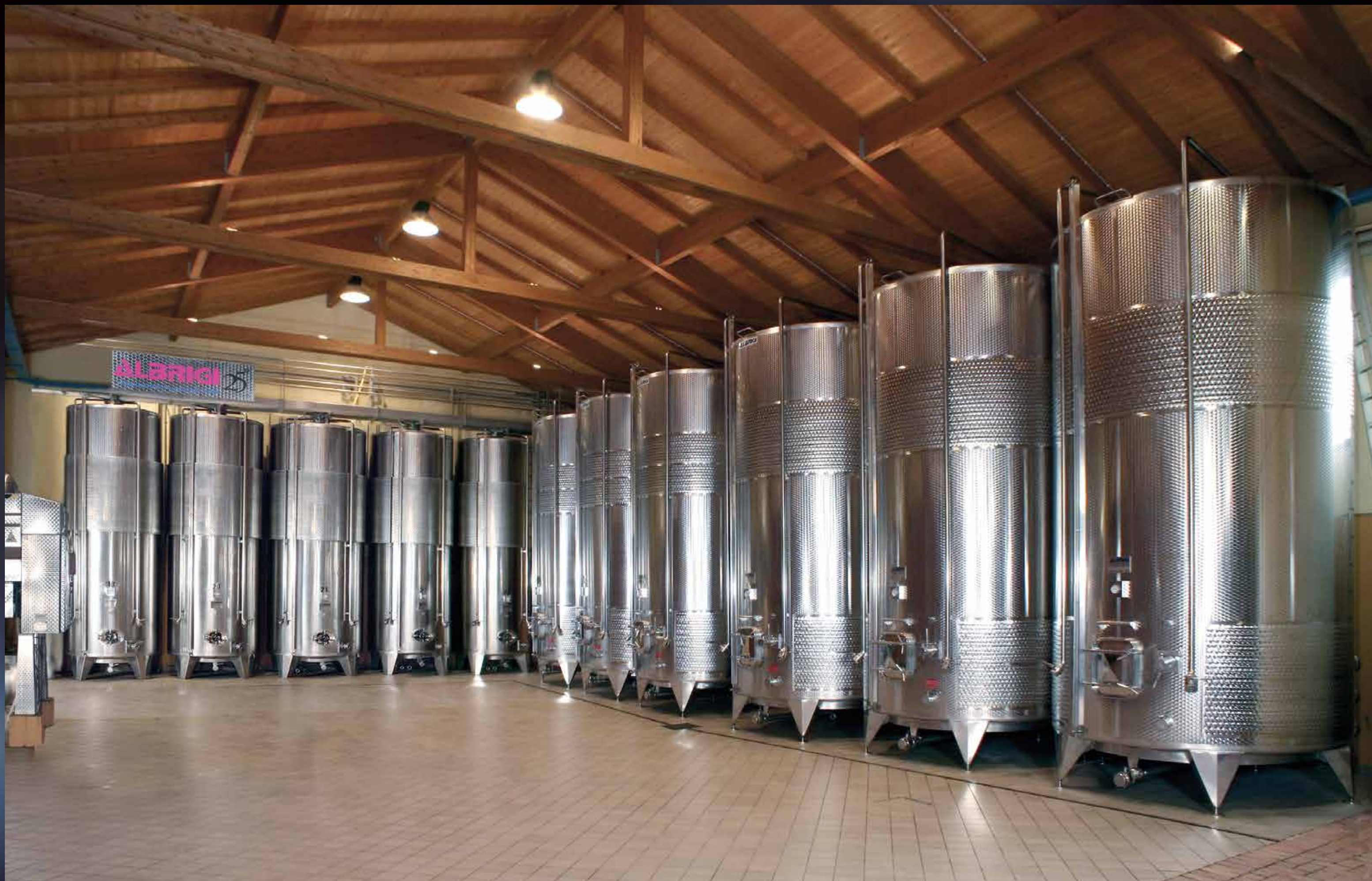
Termotank da hl 150 termocondizionati con Termostar e isolati con Isofix Termotank da hl 200 termocondizionati con Termostar Double ed entrambi con impianto di lavaggio Cleanfix
