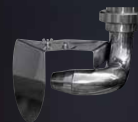
Irroratore autorotante Autofly per disperdere il mosto sul cappello di vinacce in modo omogeneo
