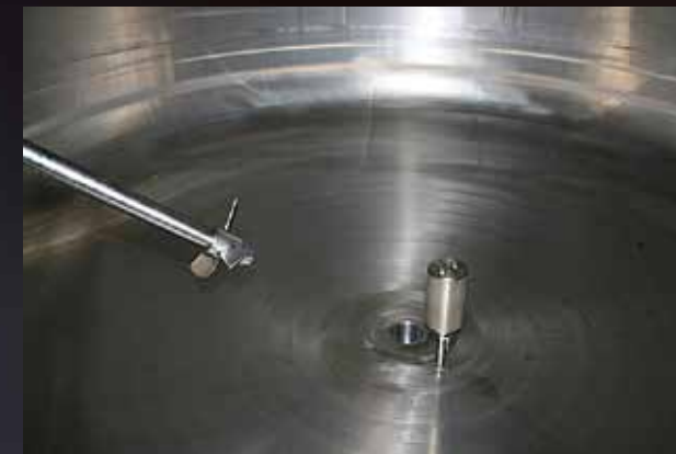
Candela porosa in acciaio inox Aisi 316L sinterizzato per fare la frizzantatura
