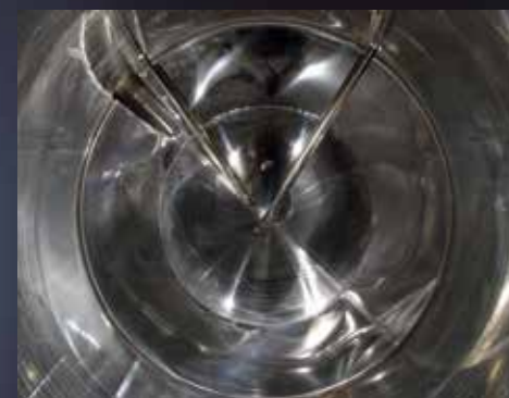
Vista dal basso di fondo brevettato Albrigi Superbottom con canali di sfato aria del chiusino
