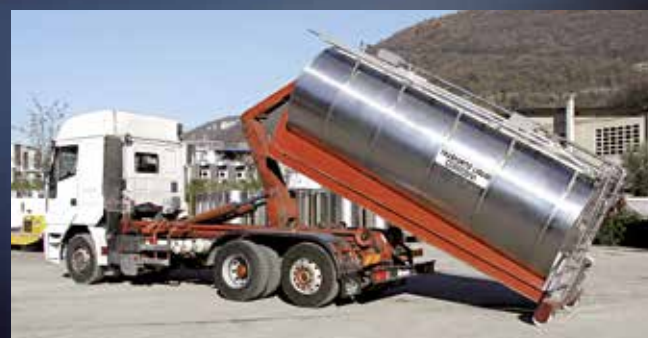
Droptank, serbatoio scarrabile isolato da 15.000 lt per alimenti
