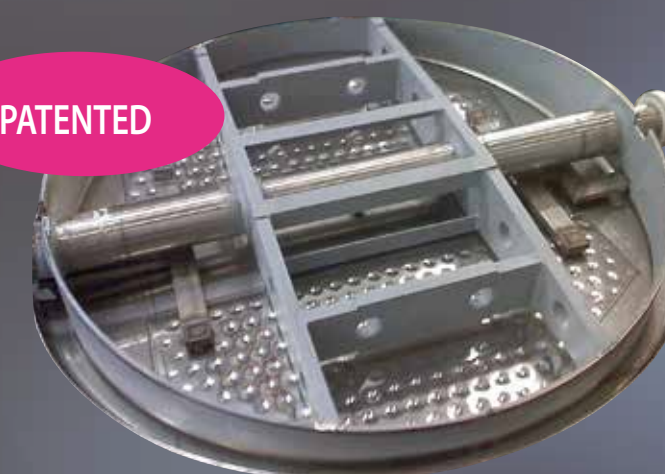
Vista della pala di rotazione brevettata da Albrigi in fase di costruzione
