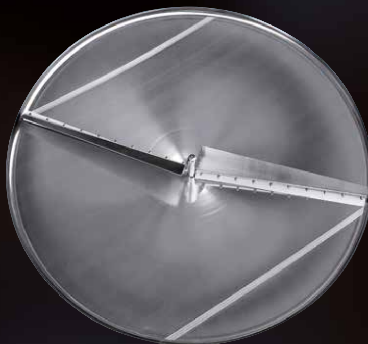
Vista della pala rotante di Bâtonnage sul fondo
