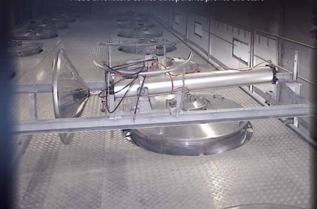
Piede di follatura conico autopulente pronto allo start
