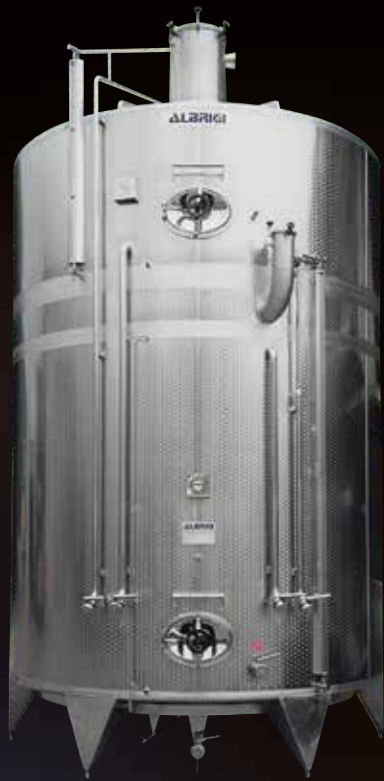
Politank da hl 200 + 100 con impianto di lavaggio Cleanfix, e scarichi totali e parziali degli scomparti prolungati in basso
