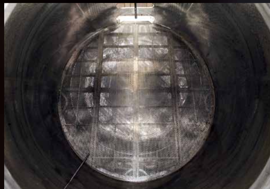
Vista dall'alto della griglia di separazione delle vinacce dal mosto, inclinata in avanti di 45°
