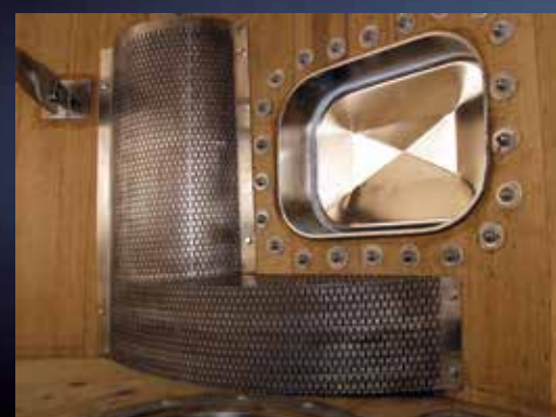
Griglie drenanti applicate su tini in legno alla valvola di scarico totale
