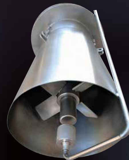
Parte inferiore della turbina con candela porosa per l'iniezione dell'ossigeno
