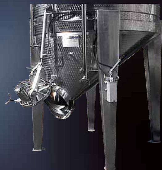
Vista laterale di Gravitank con porta aperta, apertura idraulica
