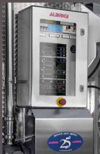
Pompa di carico dello scomparto superiore con ossigenatore e quadro elettrico di comando
