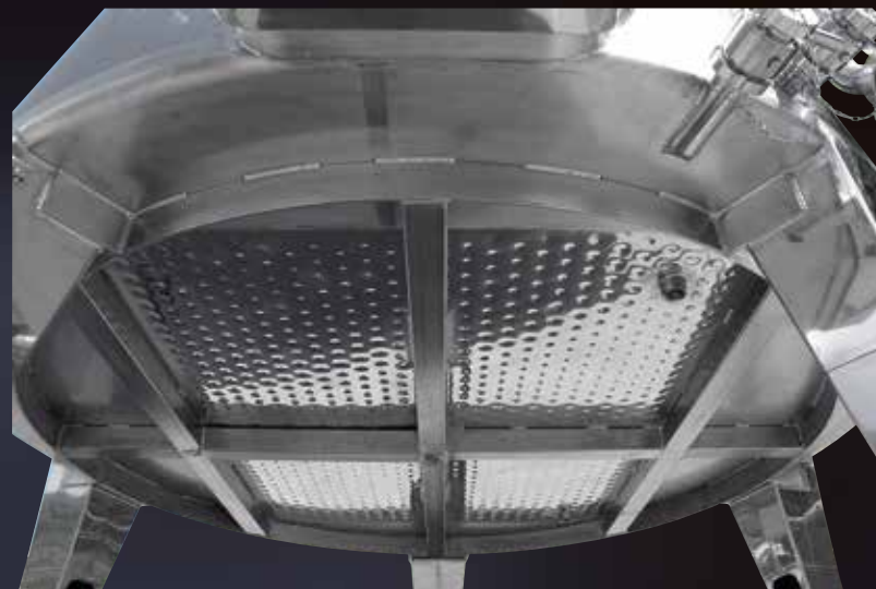
Fondo piano inclinato del 3% in avanti termocondizionato con Termostar
