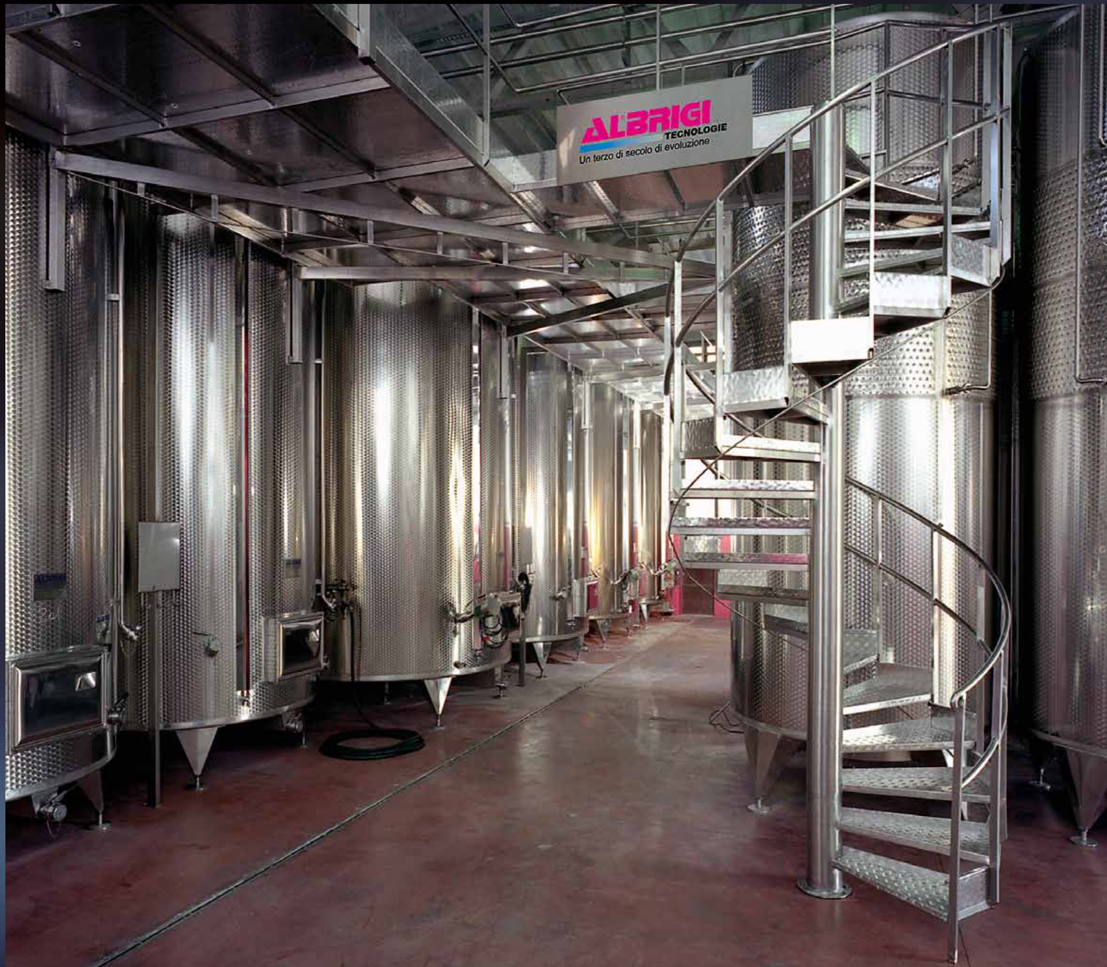
Frigotank da hl 300 e hl 100 termocondizionati con Termostar; isolati con Isotank Termotank da hl 300 e hl 150 termocondizionati con Termostar e impianto di lavaggio Cleanfix
