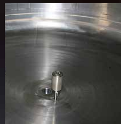
Candela porosa in AISI 316 sinterizzato posto sul fondo per la emissione della CO 2 dal basso
