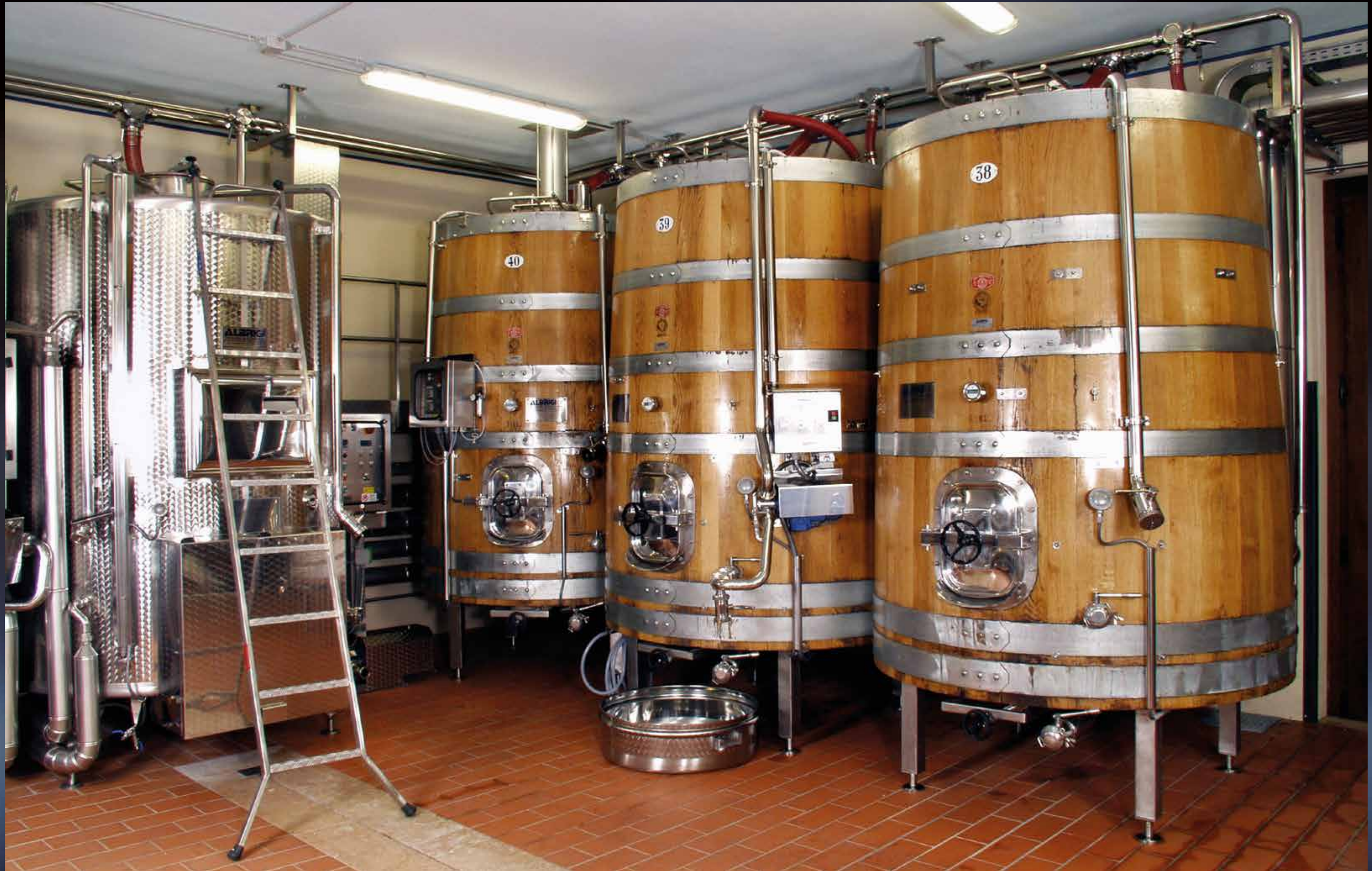
Criotank in acciaio inox e Monofoltank - Palitank / délestage - Supertank in rovere
