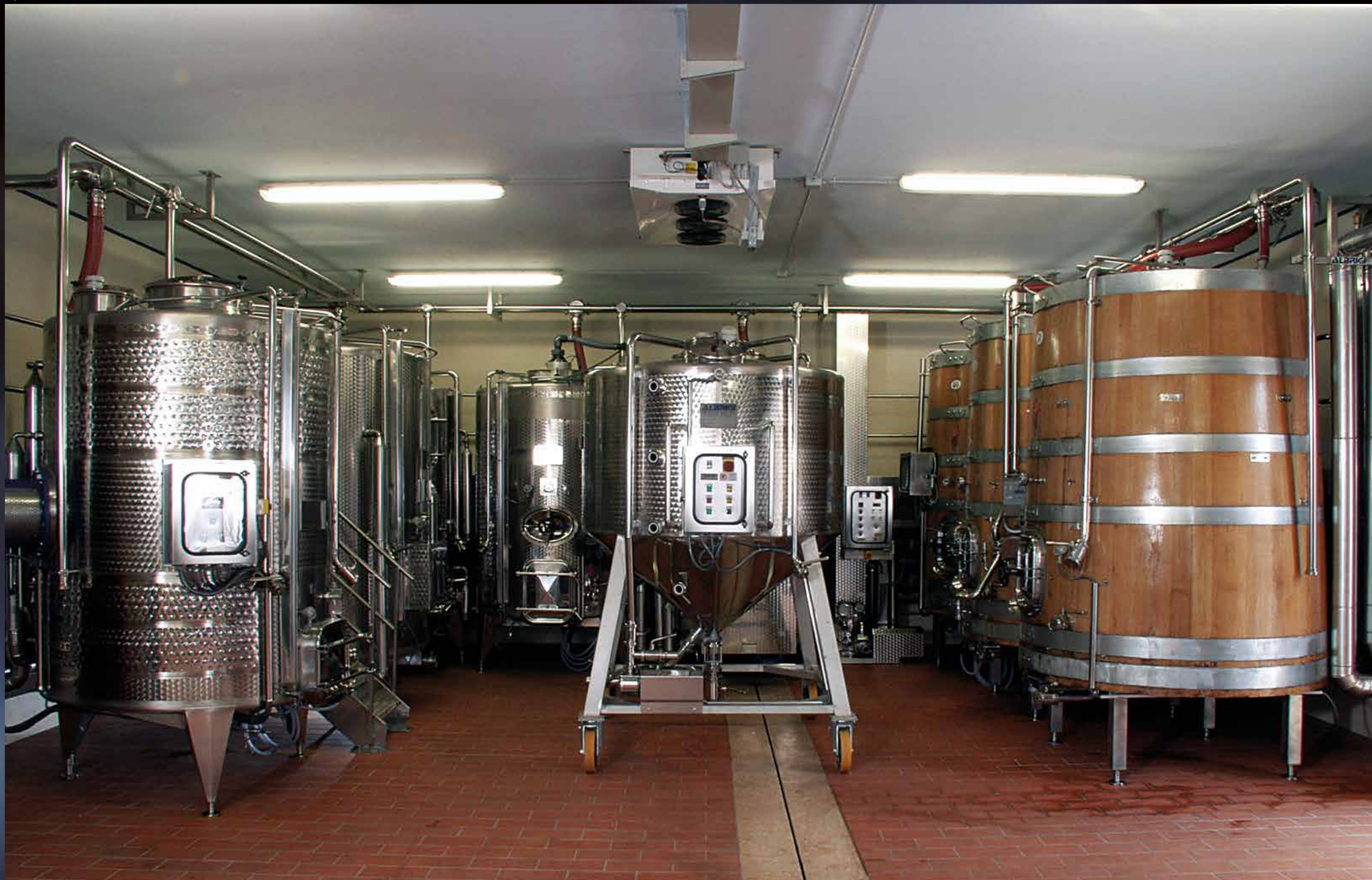
Bâtonnage - Délestage - Separtank - Volvotank - Frigotank - Noveltank - Pluviatank - Criotank - Monofoltank Supertank Cantina sperimentale di fermentazione con 9 tipi diversi di fermentatori e un separatore di vinaccioli statico
