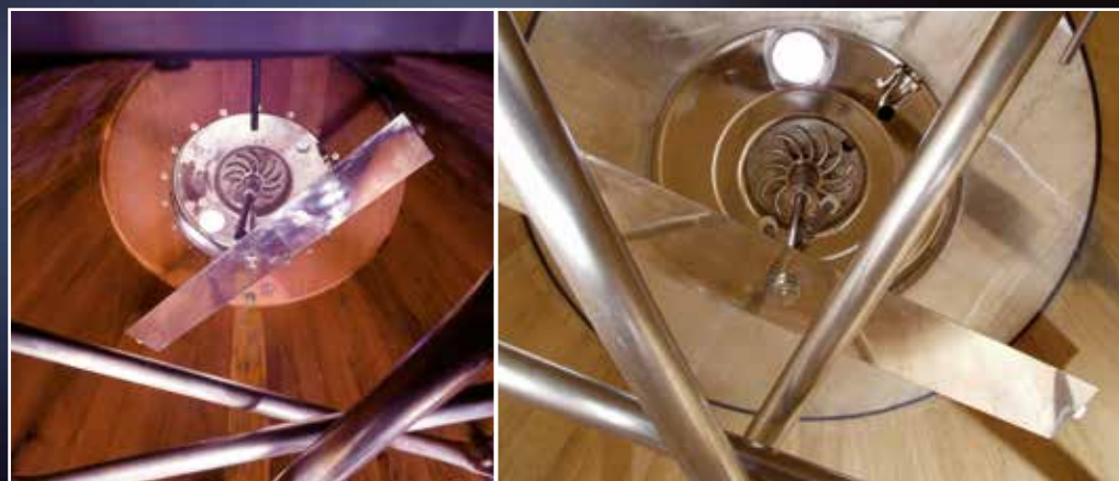
Vista dall'interno di tini di legno con pala autorotante brevettata e pali rompiscappello per fare la follatura e il délestage
