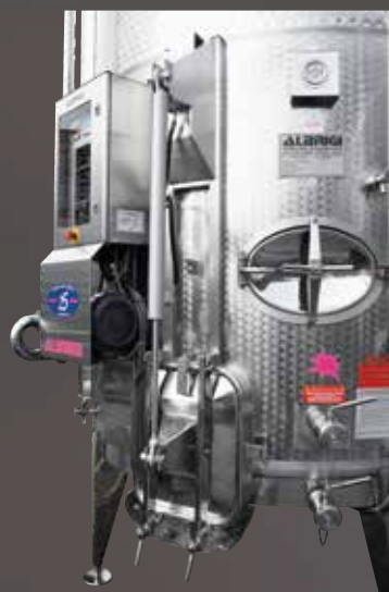
Pompa di carico dello scomparto superiore con ossigenatore e quadro elettrico di comando
