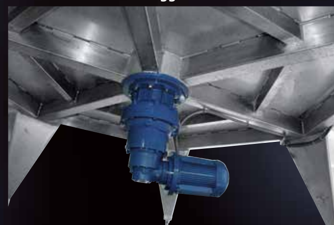
Fermentatore Meccanotank da hl 600 con fondo piano inclinato, pala di estrazione, pompa di montaggio e Palitank
