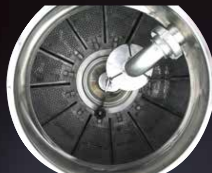
Disco dispersore per mosto sopra il meccanismo di cappello sommerso
