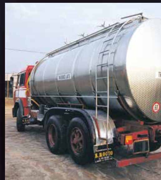
Transtank, serbatoio da 16.000 lt fisso su autotreno
