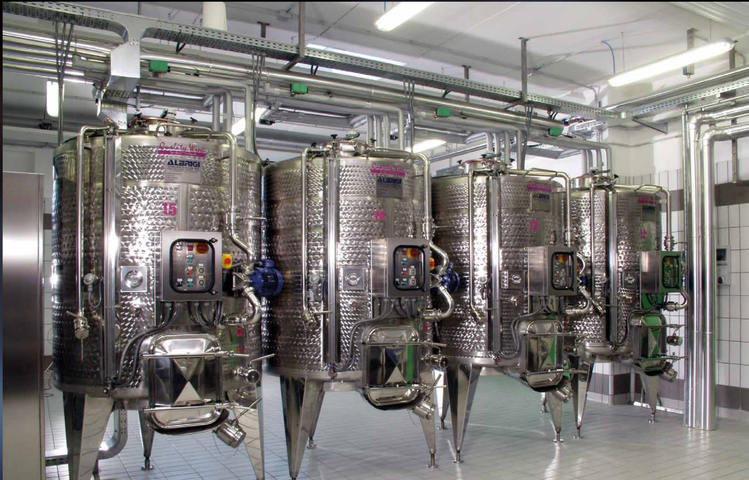
Vinificatori Specialtank termocondizionati con Termostar da 25 e 20 hl con délestage e pompa di rimontaggio
