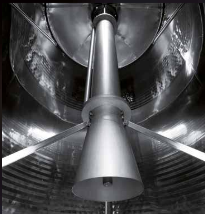
Turbotank "Termo", brevettato da Albrigi, applicato all'interno di un fermentatore da hl 600
