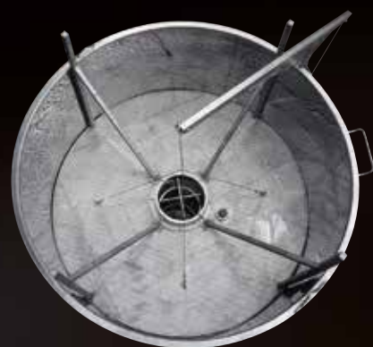
Vista di griglia posta su un Semprepieno Variotank
