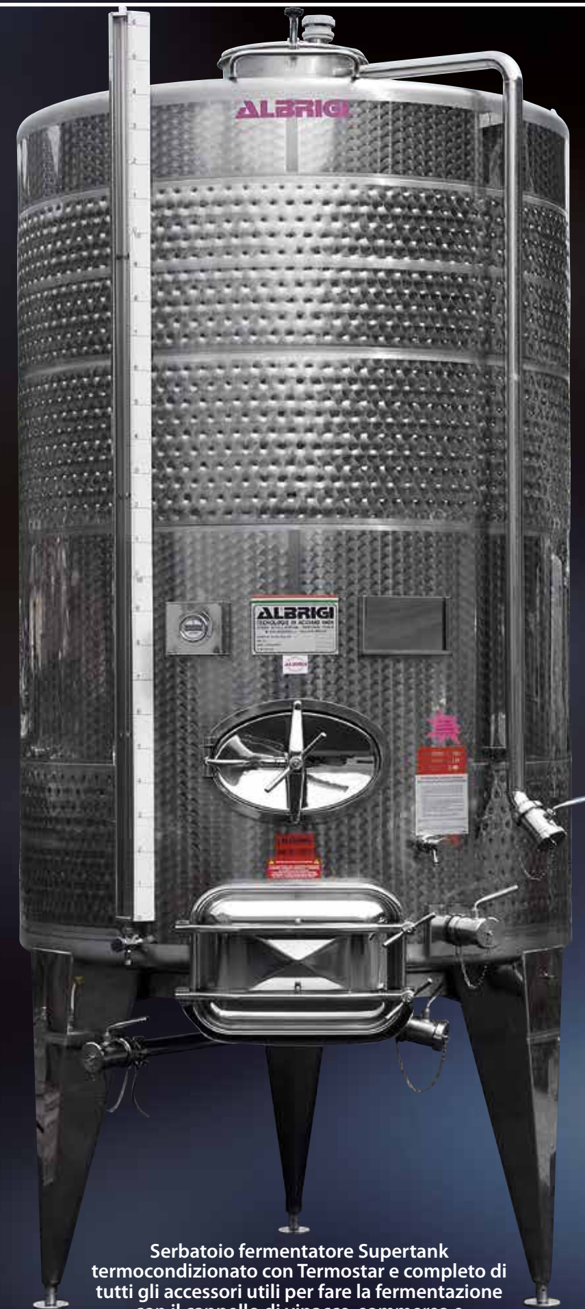
Con la portella aperta avviene il ciclo di rimontaggio naturale del mosto; con la portella chiusa si fa il ricircolo forzato utilizzando la pompa tramite il tubo di rimontaggio
