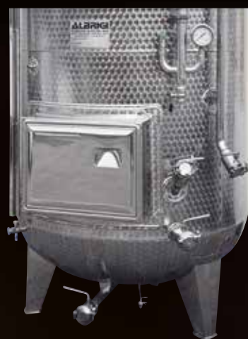
Frigotank con serie di valvole di scarico totale e parziale, e per agitatore estraibile Mobilmix e iniettore di CO 2 dal basso
