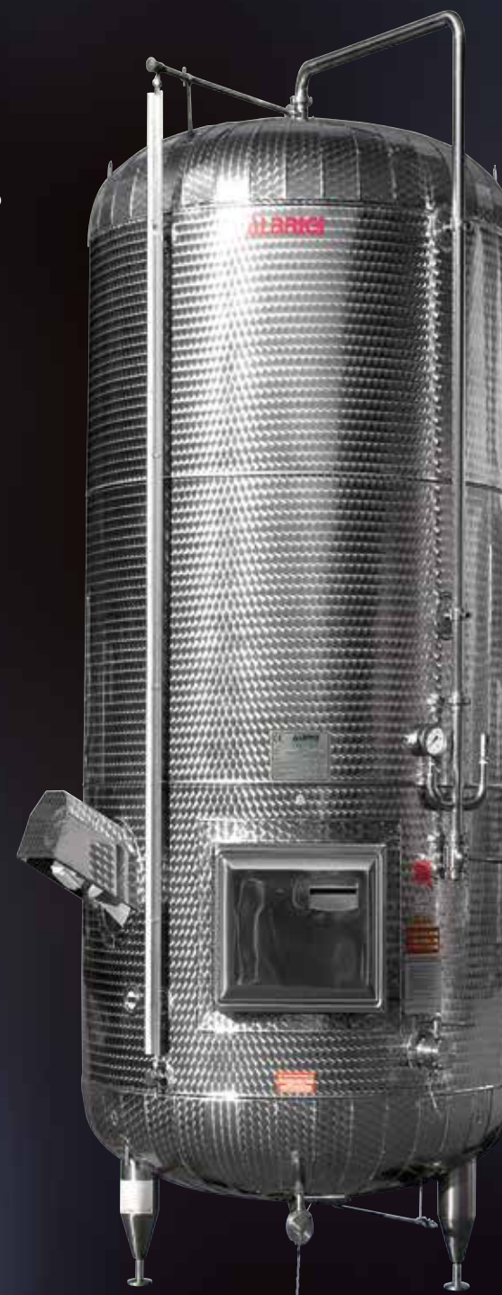
Pressuretank isolato con Isotherm, completo di agitatore e del necessario per fare le rifermentazioni o la frizzantatura
