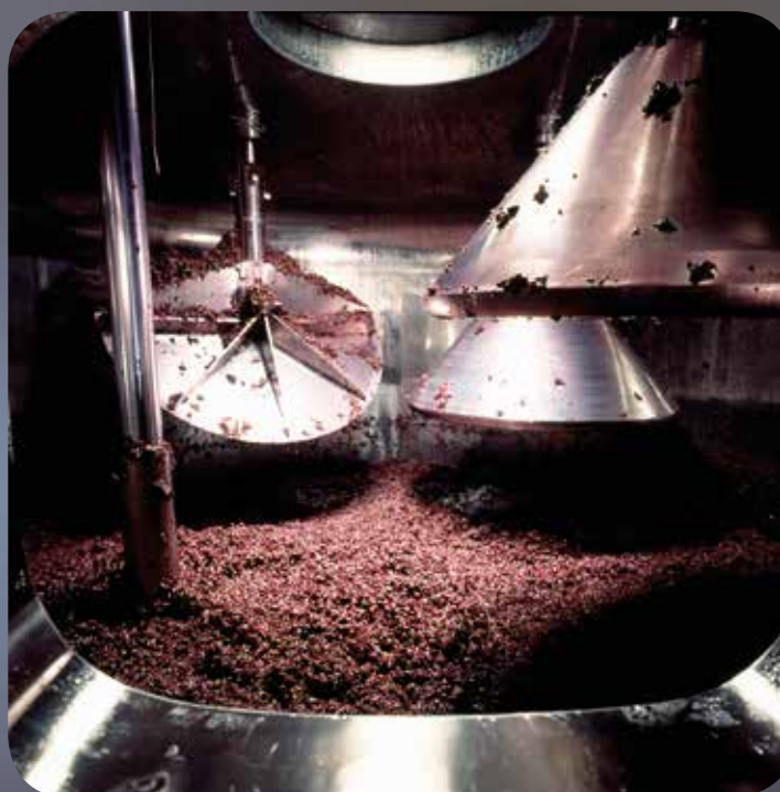
Vista interna durante la lavorazione di follatura a 4 piedi pneumatici
