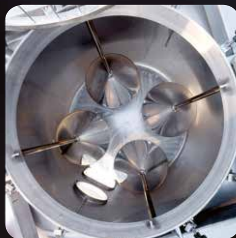
Vista dall'alto di piede di follatura autopulente
