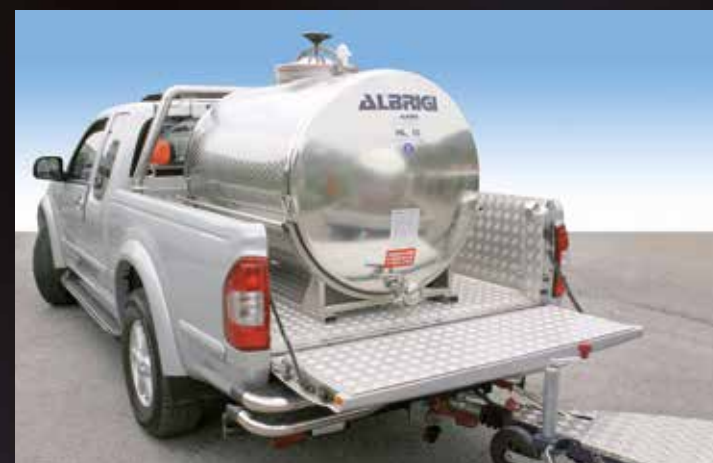
Speedy-Paletank serbatoio con sella per essere scaricato e caricato anche se pieno
