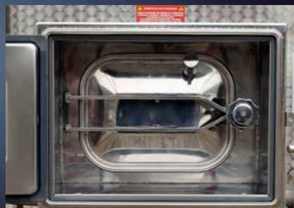
Porta rettangolare da mm 530x420 con controporta isolata e preleva campioni
