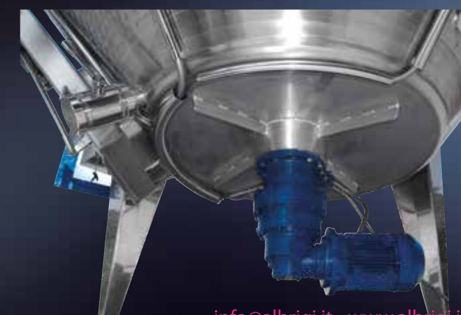
Fermentatore Meccanotank serie "S" da hl 1200 con cono con pala di estrazione e Turbotank
