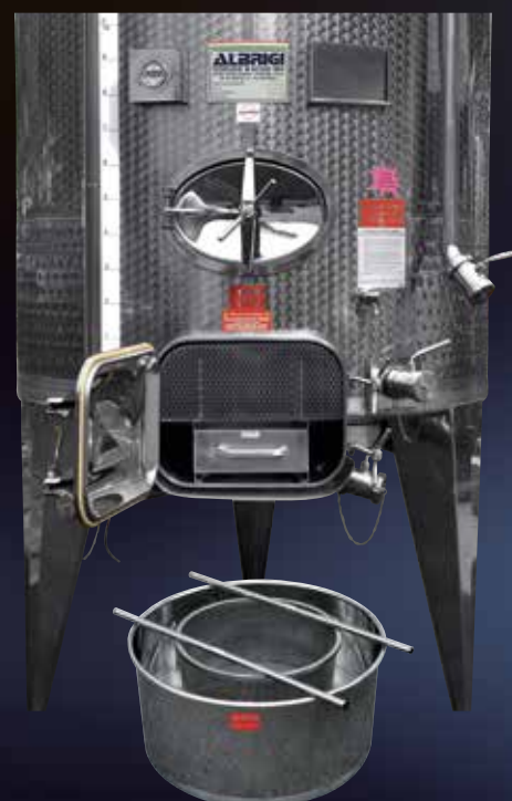
Vista di portella inferiore per scaricare le vinacce con meccanismo di separazione del mosto dalle bucce
