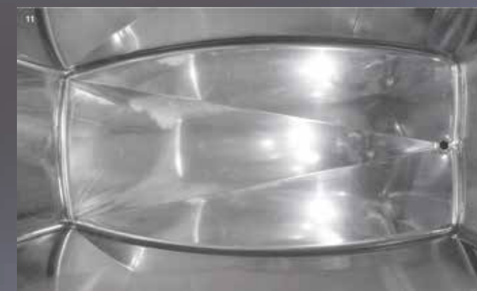
Vista dall'alto di interno di Compatank con bordi e angoli arrotondati facili da pulire e con fondo sagomato autoscaricante
