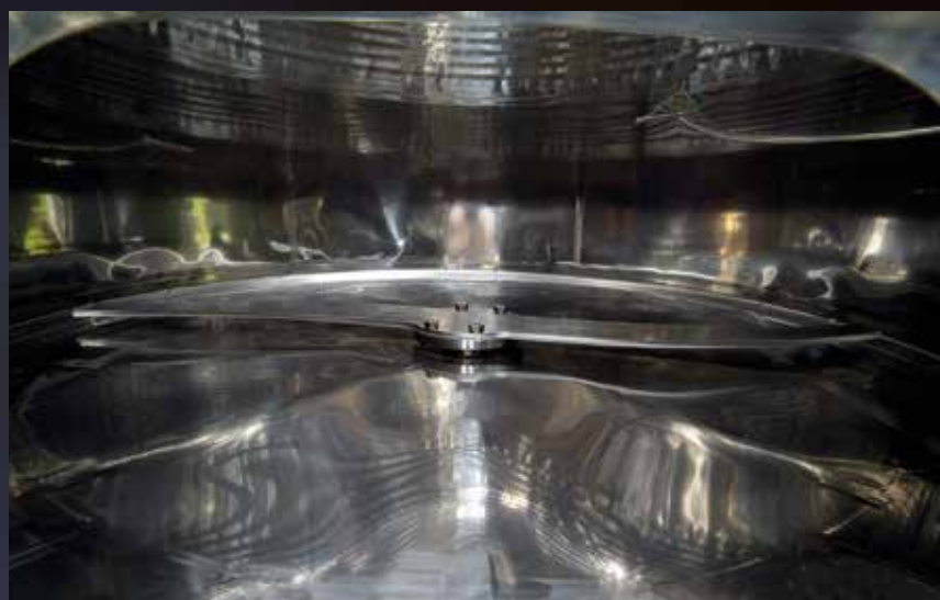
Meccanismo di estrazione delle vinacce sul fondo piano inclinato del 3% in avanti
