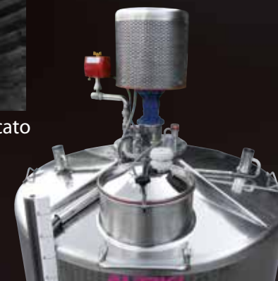
Turbotank termocondizionato con valvola motorizzata Motorvalve per il ricircolo del glicole nell'intercapedine
