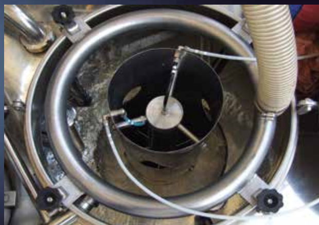
Valvola di cascata con iniettore di aria applicato
