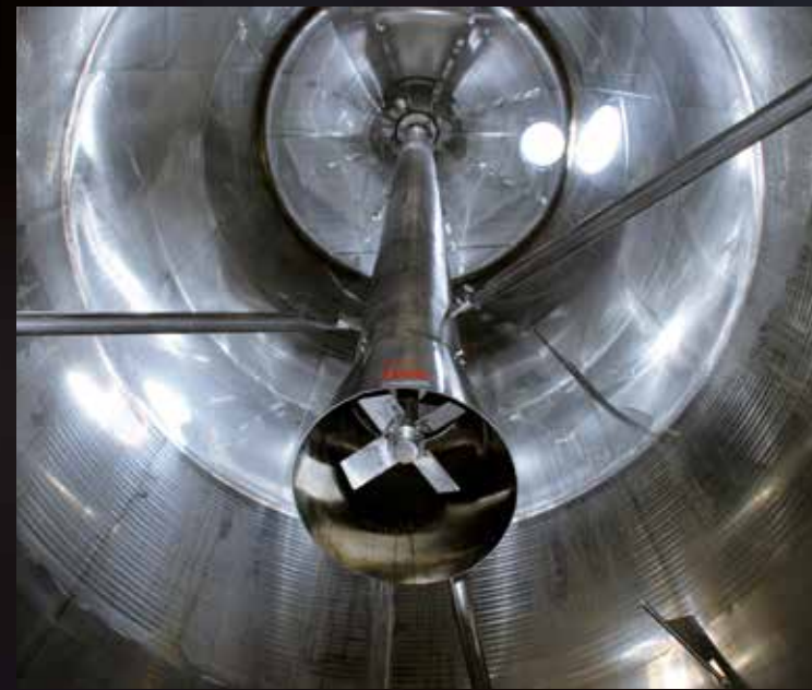
Turbotank applicato all'interno di un fermentatore da hl 1000
