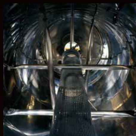
Meccanismo Palitank con griglia drenante al centro
