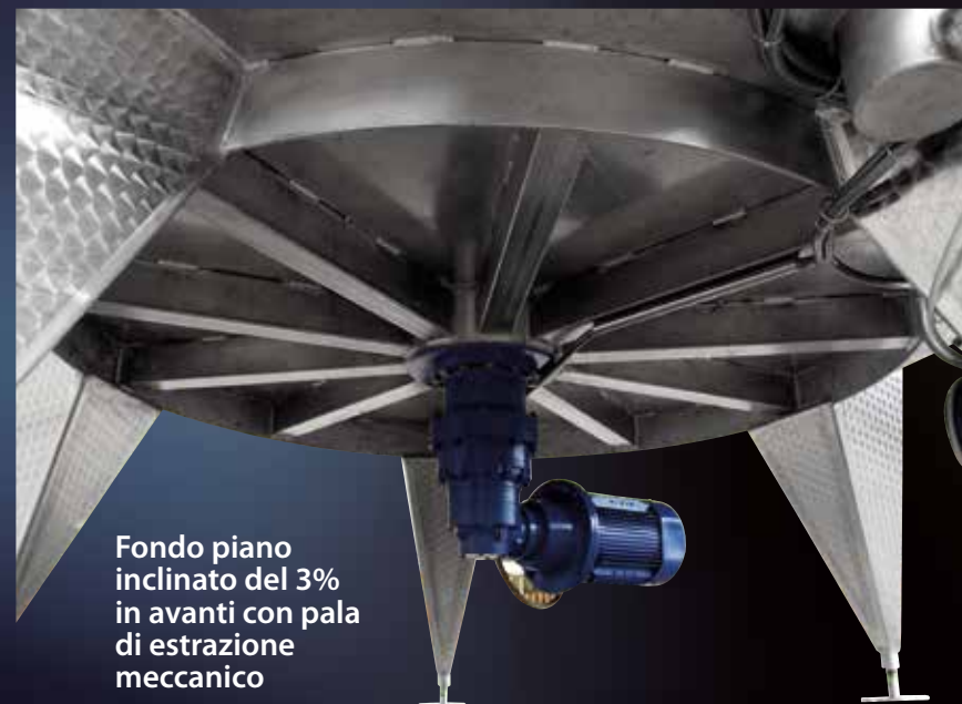
Fondo piano inclinato del 3% in avanti termocondizionato con Termostar
