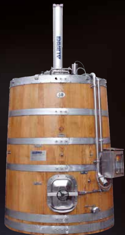
Monofolltank su tino di legno a tronco di cono
