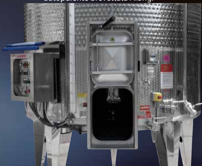
Porta a ghigliottina aperta con pala di estrazione delle vinacce
