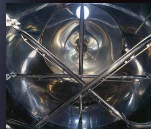
Palitank rinforzati per fermentatore da hl 600 per uve nere
