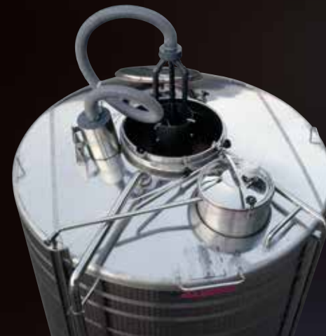
Valvola di cascata applicata con ossigenatore interno e turbina di areazione
