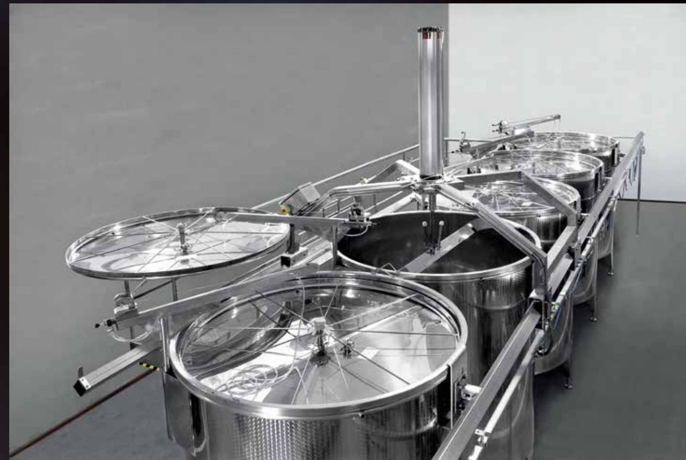
Follatore a pala rotante su doppia rotaia funzionante in manuale o automatico
