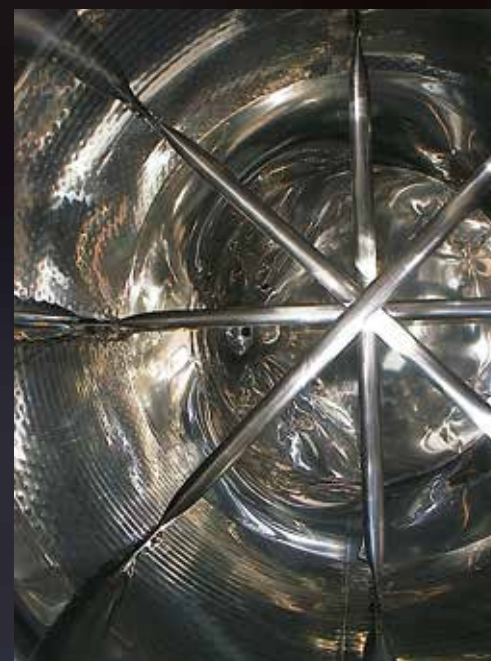
Palitank per fare il délestage e rompere il cappello durante la fase di fermentazione, ma molto utile per favorire lo scarico delle vinacce a fine fermentazione
