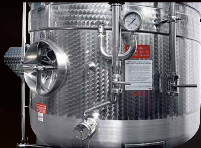
Gruppo di sicurezza con valvola tarata PED
