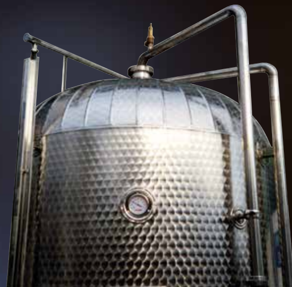
Vista superiore di un'autoclave con accessori per il lavaggio, tubo del gruppo di sicurezza e livello isolato con Isotherm
