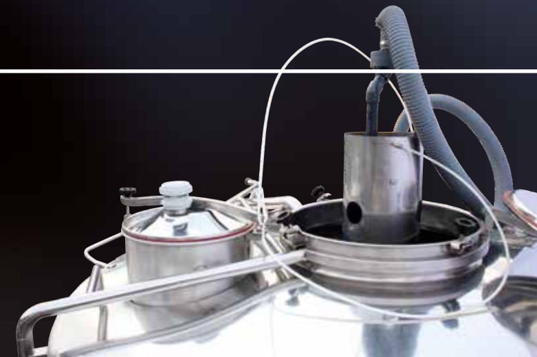
Valvola di cascata applicata con impianto pneumatico di comando
