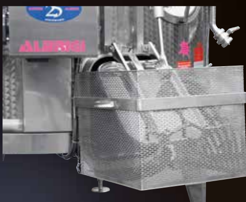
Gabbia di protezione delle persone durante lo scarico delle vinacce
