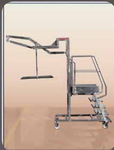
MANUALFOLLTANK Meccanismo manuale di follatura per piccoli serbatoi aperti Variotank
