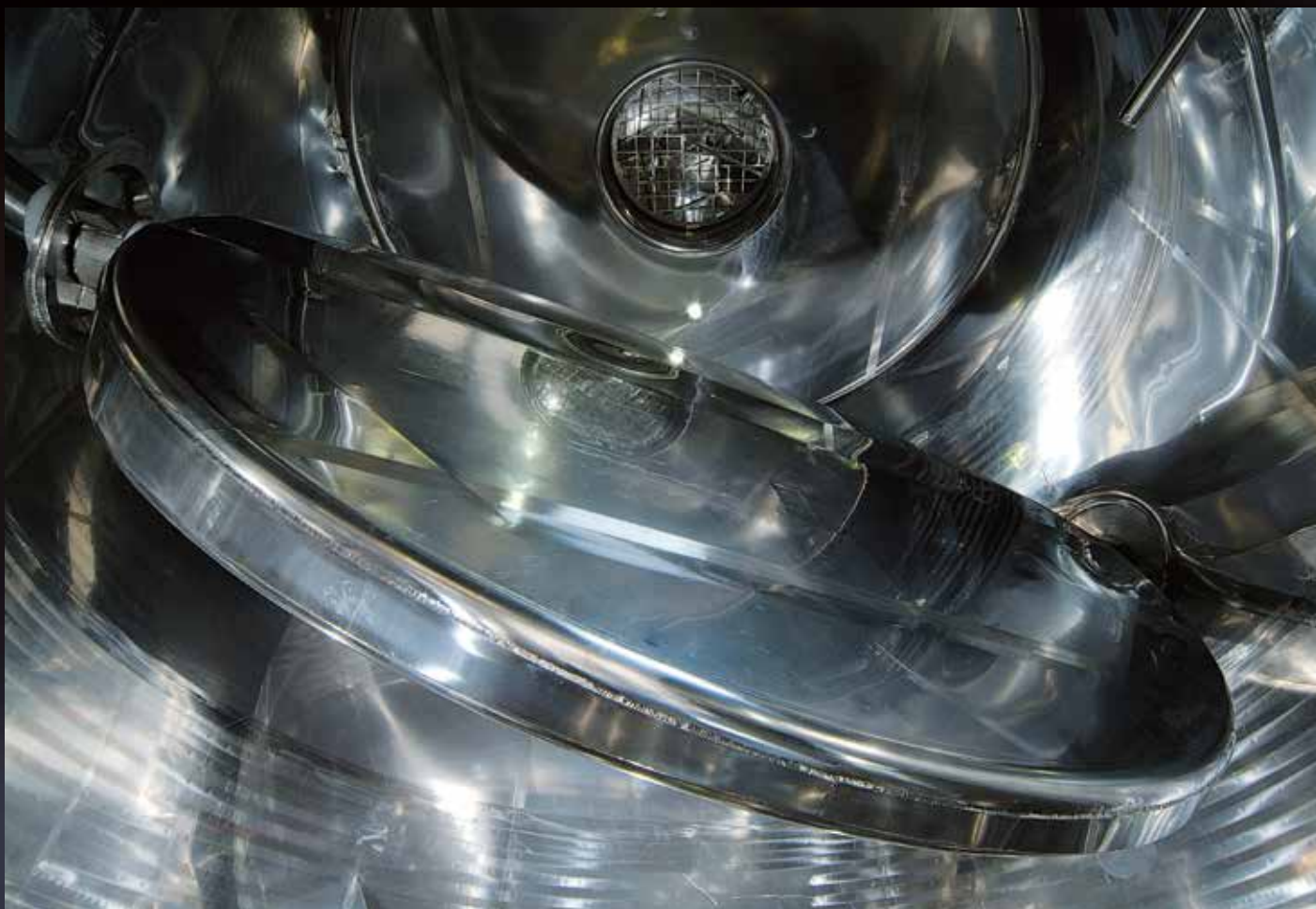
Pala rotante, brevettata da Albrigi, a disco intero termocondizionata da ambo i lati
