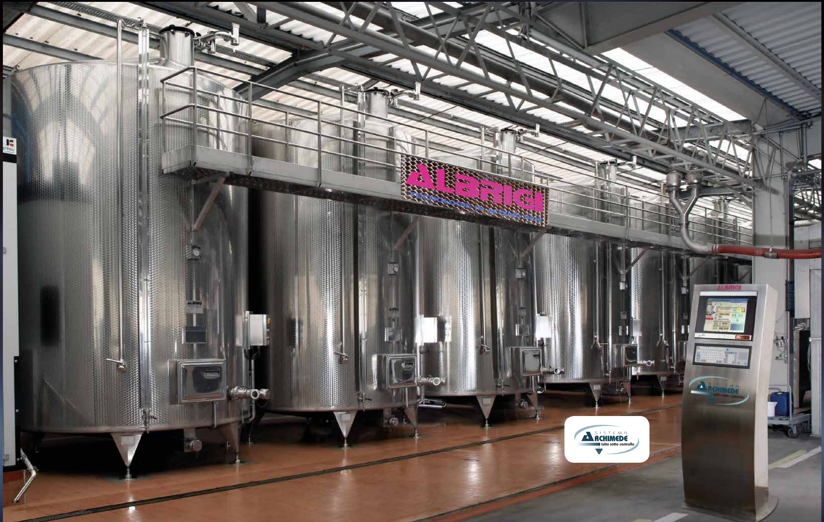
Frigotank da hl 300 termocondizionati con Termostar, isolati con Isotank, agitatore Sidemix e impianto di lavaggio Cleanfix
