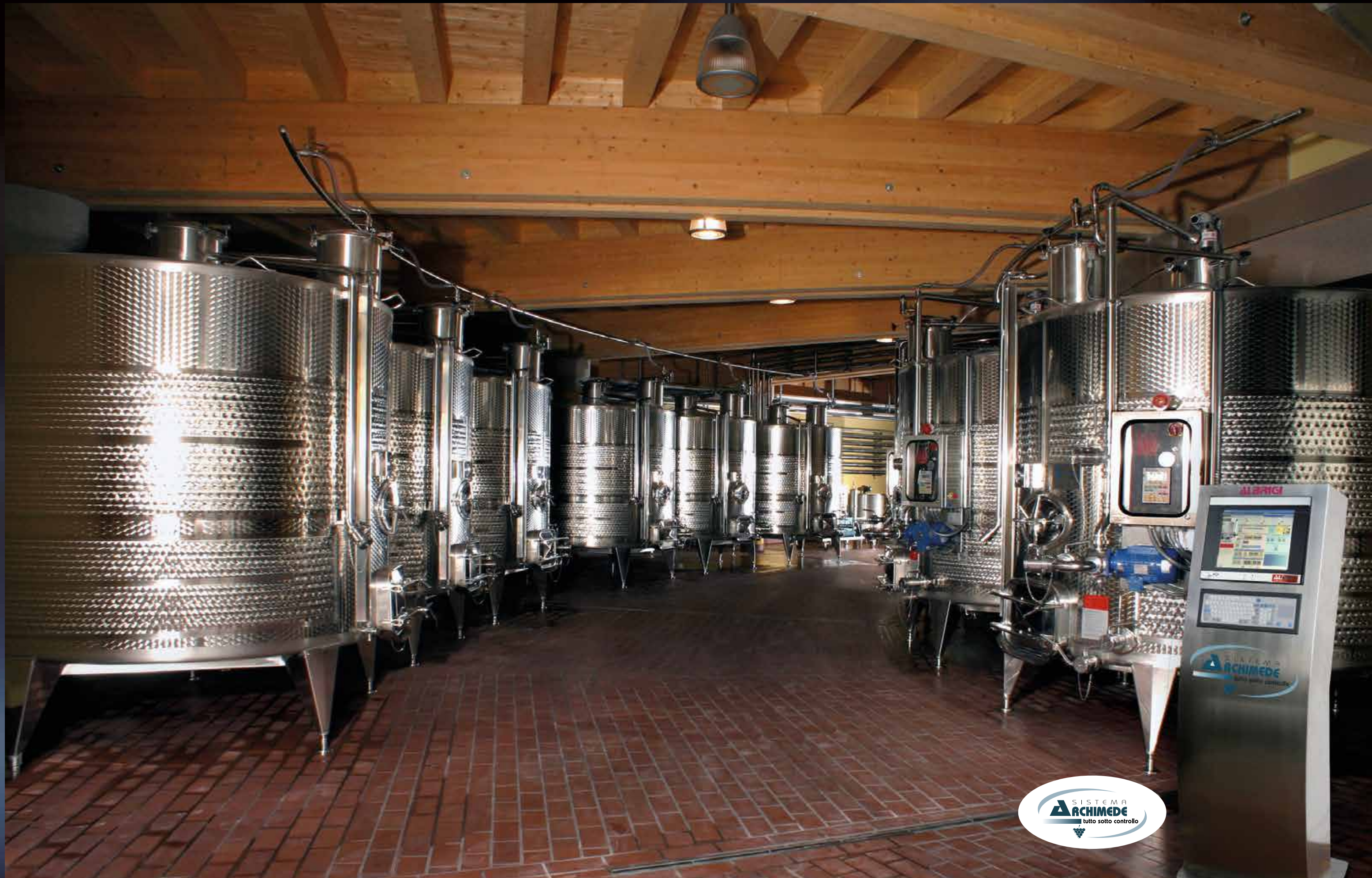
Vinificatori Meccanotank termocondizionati con Termostar Double, impianto di lavaggio Cleanfix, impianto Innergas e rimontaggio Motorfly
