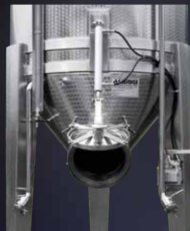
Gravitank con porta totalmente aperta
