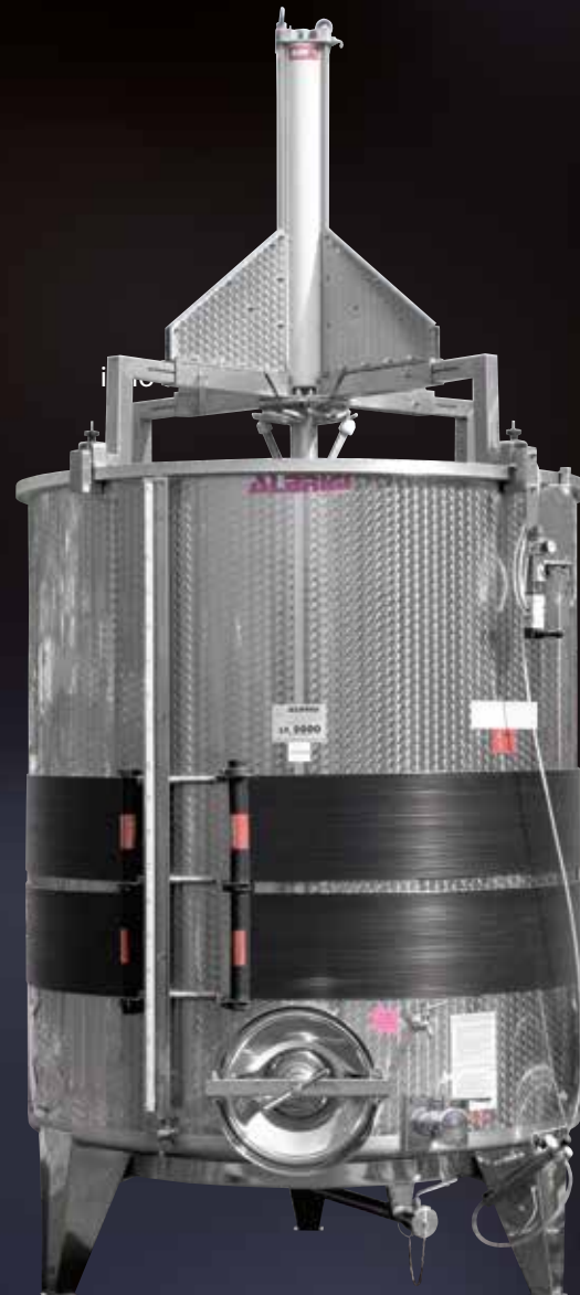
Vista esterna del meccanismo di follatura, "Variofolltank", su semprepieno da hl 50
