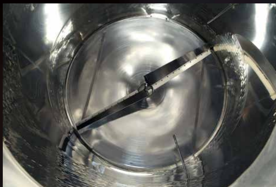
Vista della pala brevettata rotante sul fondo
