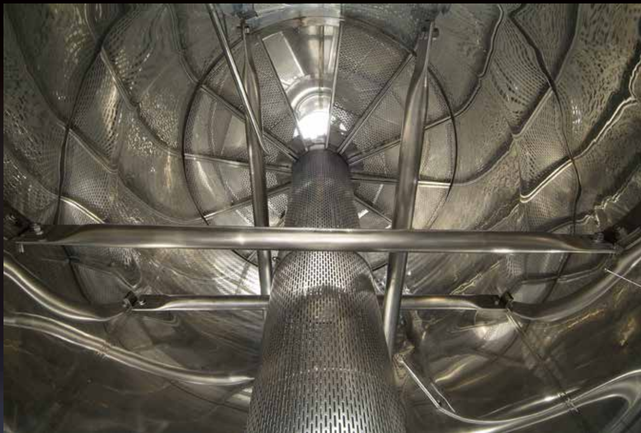
Vista dal basso di meccanismo per il cappello sommerso con pali rompicappello
