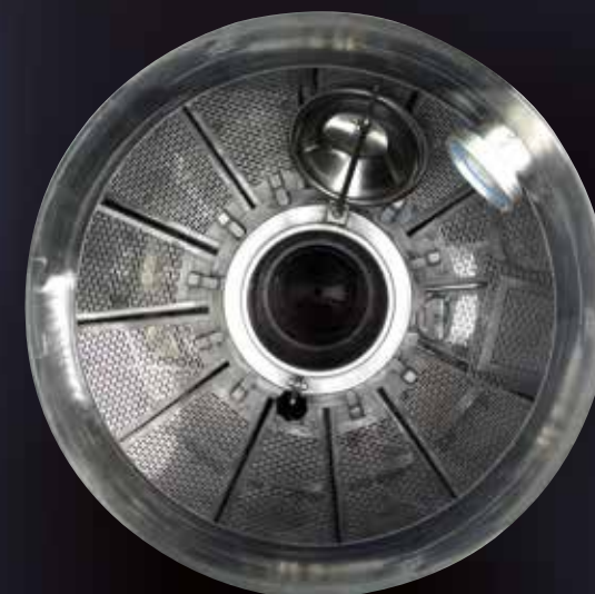
Con la portella aperta avviene il ciclo di rimontaggio naturale del mosto; con la portella chiusa si fa il ricircolo forzato utilizzando la pompa tramite il tubo di rimontaggio
