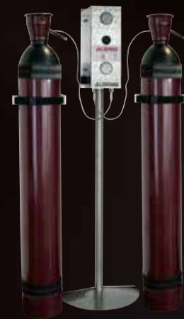
Centrale di polmonazione fissa, con due bombole, per servire più serbatoi, funzionante ad azoto o CO 2 da 20 a 100 m 3 /h
