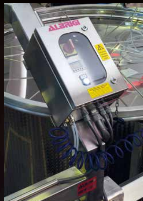
Quadro di comando elettropneumatico di salita e discesa manuale -automatico
