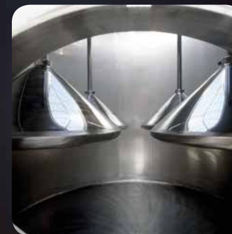
Vista interna laterale di piedi pneumatici di follatura, speciali autopulenti, che coprono il 75% di superficie del fermentatore
