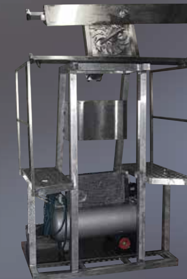
Meccanismo su base mobile per eseguire la follatura con pala autorotante su "Variotank"
