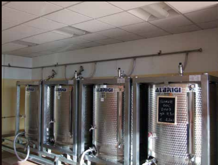
Impianto di stoccaggio per spaccio di vendita vino sfuso con impianto di inertizzazione con azoto
