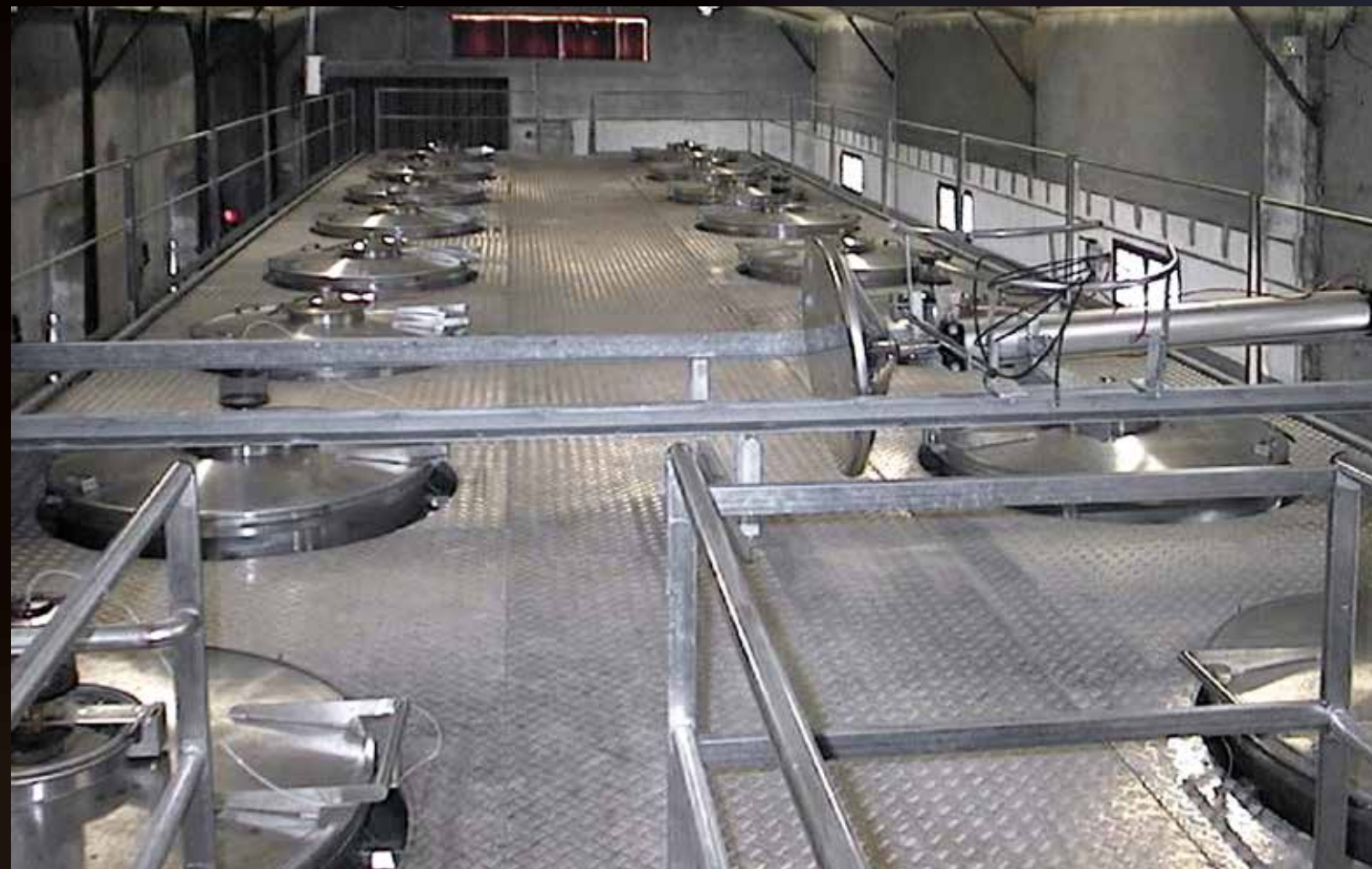
Vista di Superfollrail con n° 20 fermentatori da 200 hl e il monoipiede di follatura in posizione di riposo
