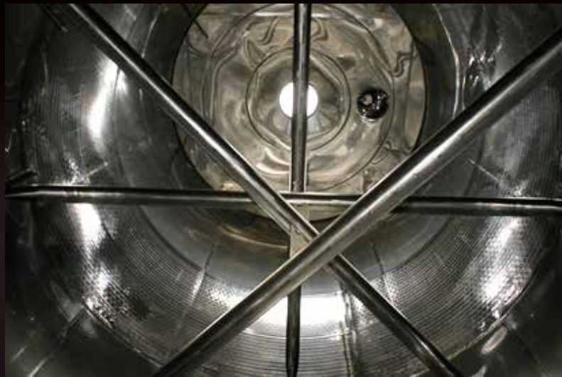
Palitank per rompere il cappello durante il délestage
