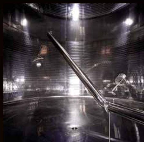
Valvola decantatrice applicata allo scarico parziale
