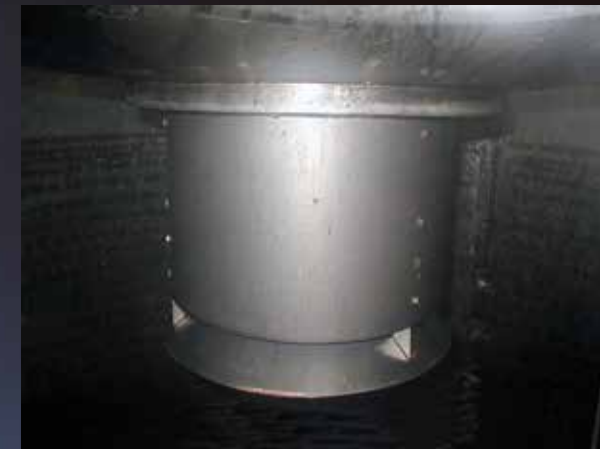
Vista dal basso della valvola di cascata con il convogliatore chiuso
