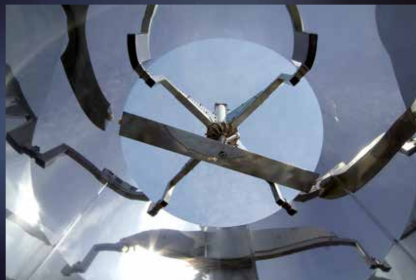
Vista interna di meccanismo di follatura, "Variofolltank", su semprepieno da hl 50
