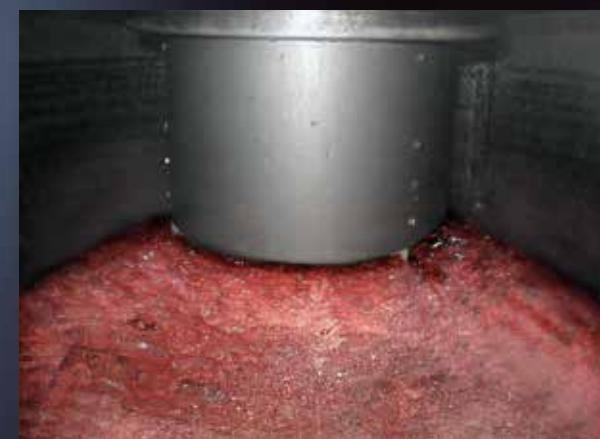
Valvola di cascata aperta con il flusso di mosto in caduta
