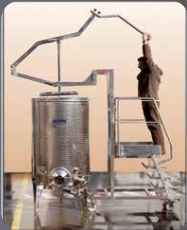
Follare è semplice basta utilizzare il meccanismo manuale brevettato Albrigi
