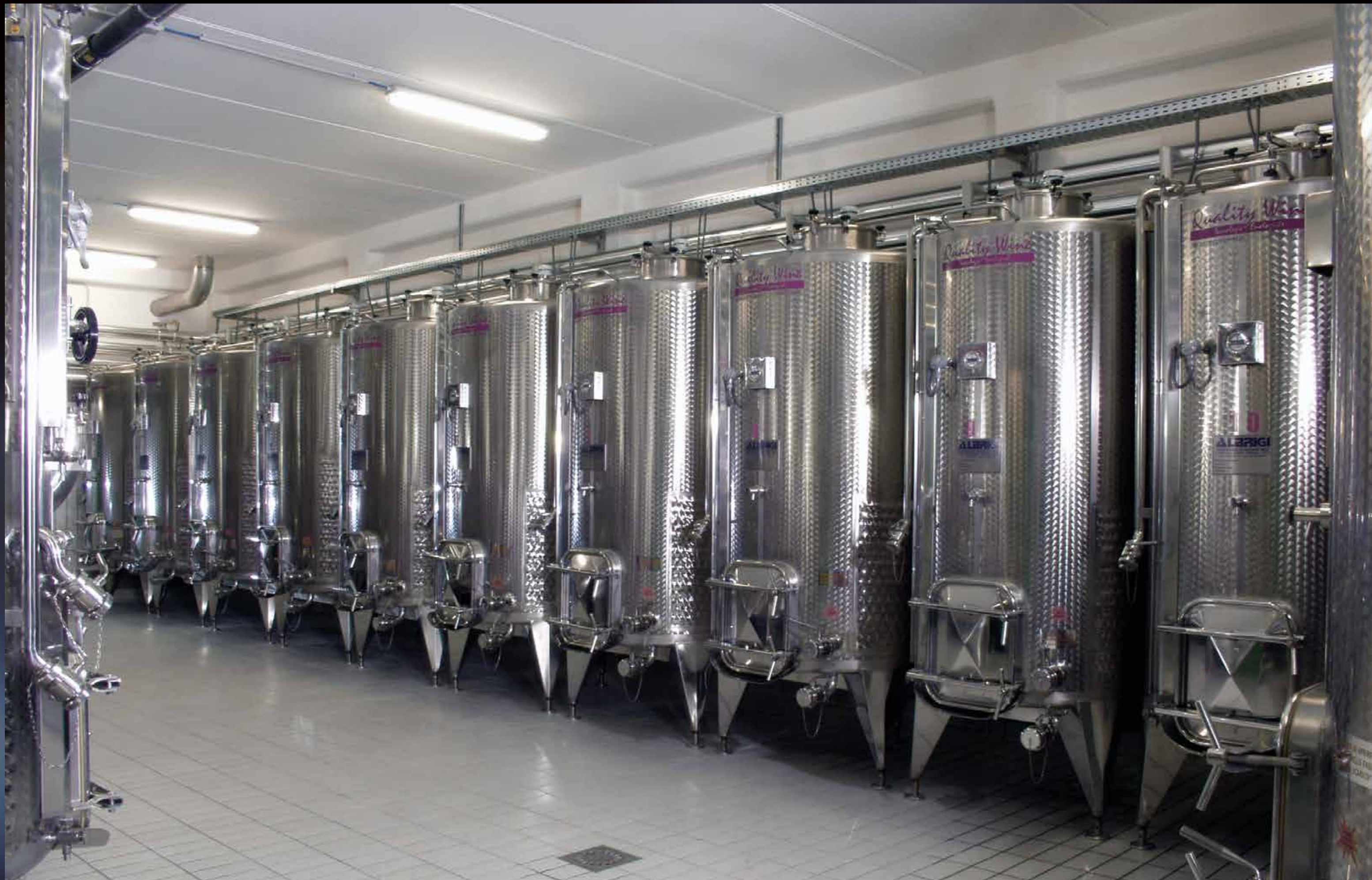
Specialtank termocondizionati con Termostar e con tutti gli accessori per la fermentazione
