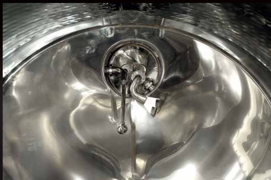
Vista interna dell'irroratore autorotante per mosto e sfera di lavaggio
