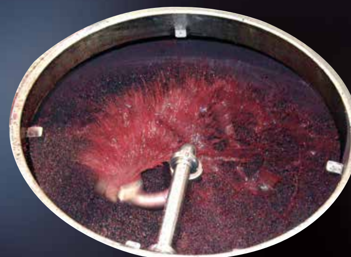
Irroratore Autofly autorotante tipo Mono con il mosto
