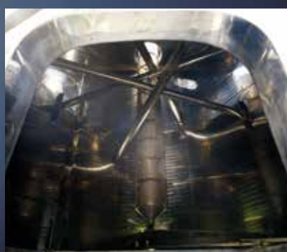
Palitank con tubo a rete di sgrondo laterale smontabile
