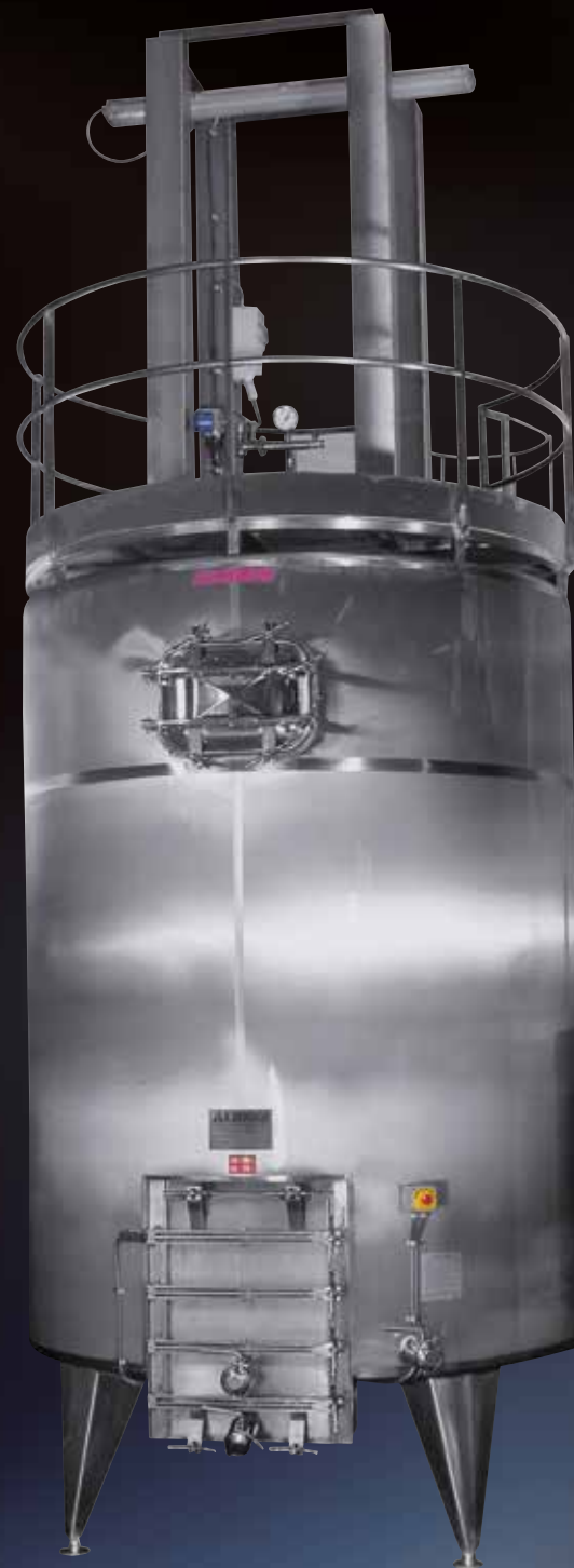
Follatore oleodinamico a 4 piedi speciali autopulenti con PLC di gestione delle fasi di follatura alternate
