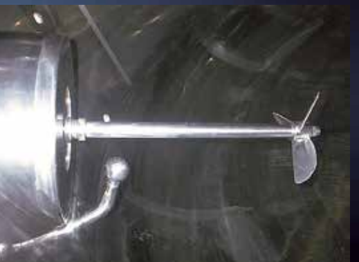
Sfera di lavaggio "Spryball" per pulire l'agitatore e la tenuta meccanica
