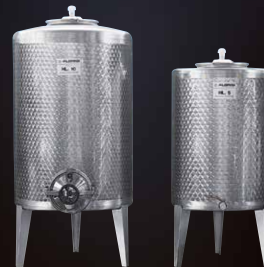
Minitank da lt 300-550-800-1000-1550 per lo stoccaggio e fermentazione con porta Ø 300, chiusino Ø 400 e piedi mobili
