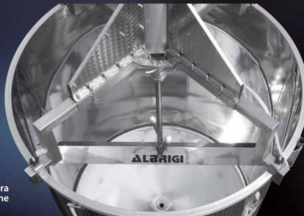
Variofolltank con staffa di fissaggio regolabile
