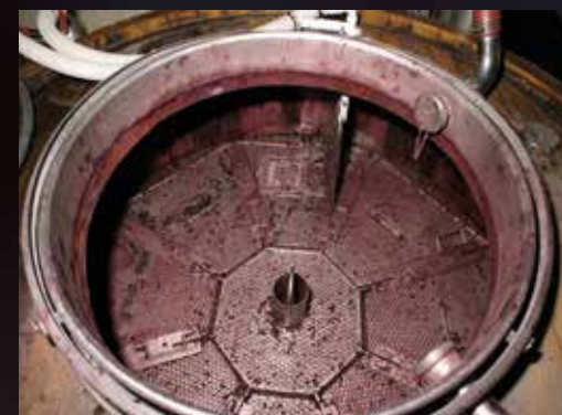
Meccanismo di cappello sommerso su tino in legno, smontabile dall'esterno
