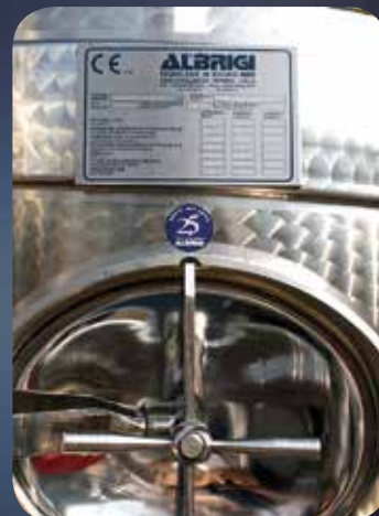
Etichetta inox di certificazione del collaudo PED
