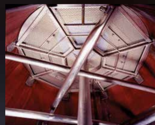
Vista del meccanismo con pali rompicappello per eseguire il délestage
