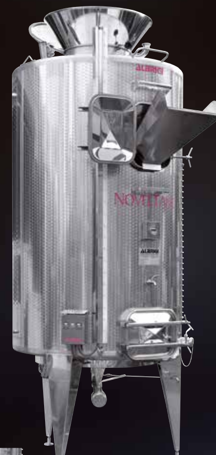
Noveltank con le 2 tramogge per il carico di uva intera
