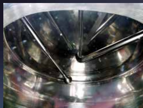
Fondo e contro fondo brevetto Albrigi Superbottom con sfera di lavaggio Sprayball
