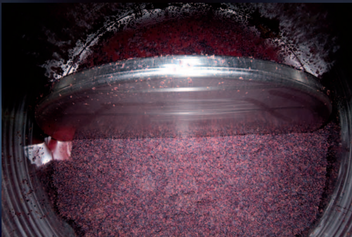
Pá rotativa, patenteada por Albrigi, colocada em vertical com bagaço denso, em fase de pausa
