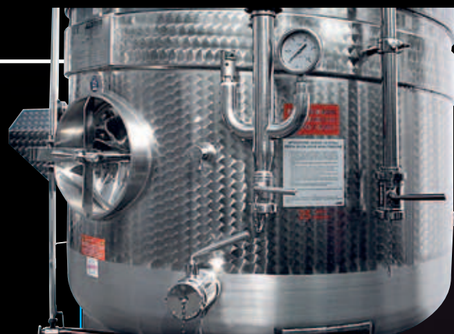
Grupo de segurança com válvula calibrada PED
