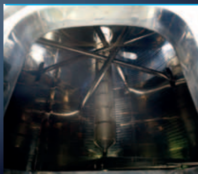
Palitank com tubo de rede de escoamento lateral desmontável
