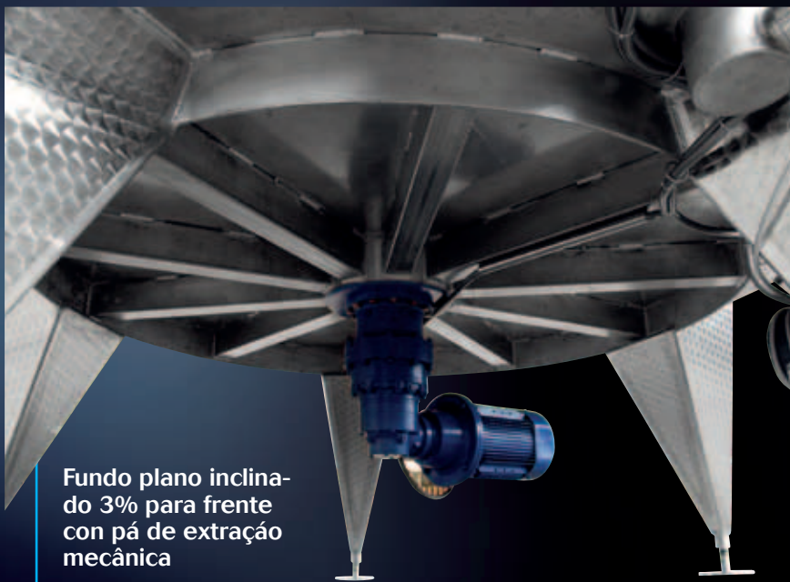
Fundo plano inclinado 3% para frente termocondicionado com Termostar
