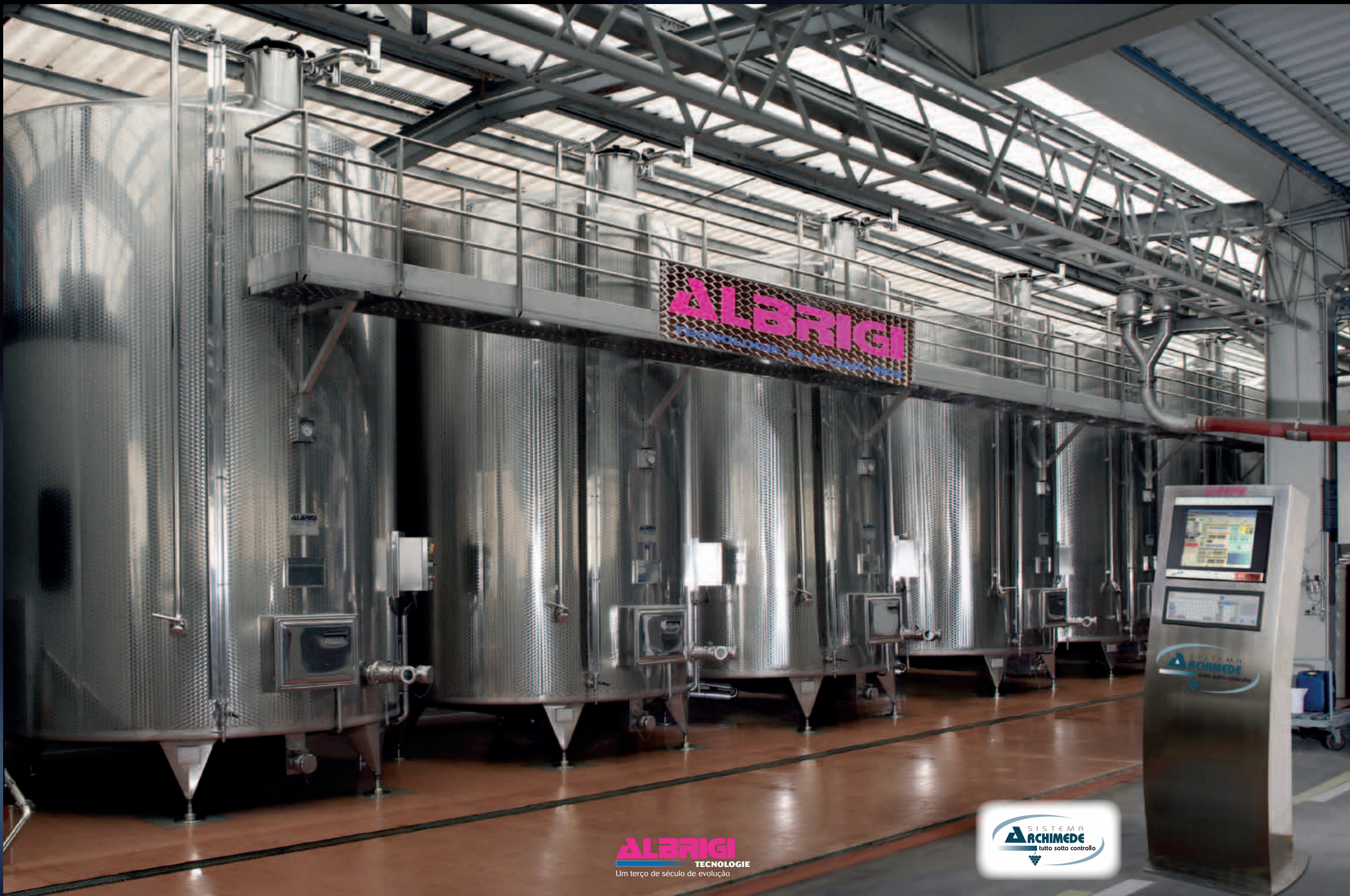
Tanques Frigotank de 300 hl termocondicionados com Termostar e isolados com Isotank, agitador Sidemix e instalação de lavagem Cleanfix
