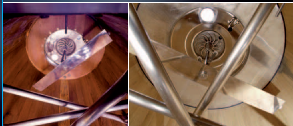
Vista do interior de cubas de madeira com pá autorotativa patenteada e paus quebra-manta para fazer o recalque e o délestage
