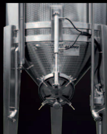
Gravitank com porta fechada e bloqueada
