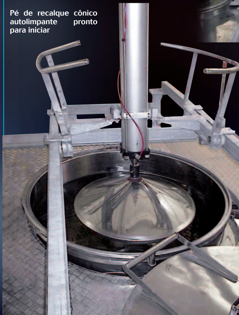
Vista de Superfollrail com 20 fermentadores de 200 hl e o monopé de recalque em posição de pausa
