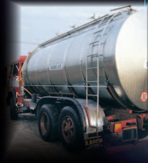
Transtank, tanque de 16.000 l fixo em caminhão com reboque
