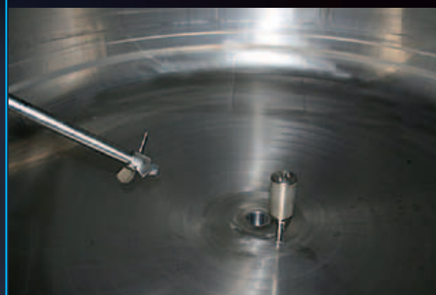
Elemento poroso em aço inox AISI 316L sinterizado para fazer a formação de espuma
