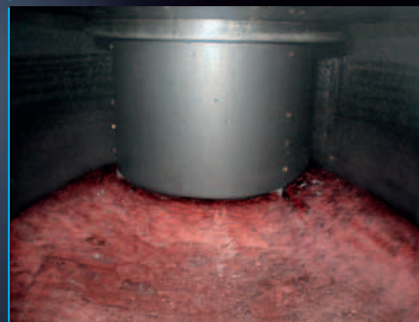
Válvula de cascata aberta com o fluxo do mosto em fase de queda
