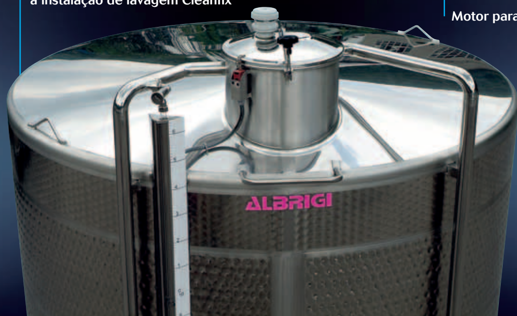
Vista da tampa dianteira com a remontagem e a instalação de lavagem Cleanfix
