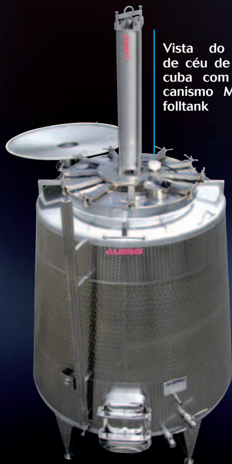
Monofolltank montado numa cuba de aço troncônica
