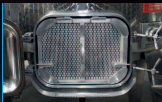
Grade móvel em porta retangular de 530x420 mm rente ao fundo
