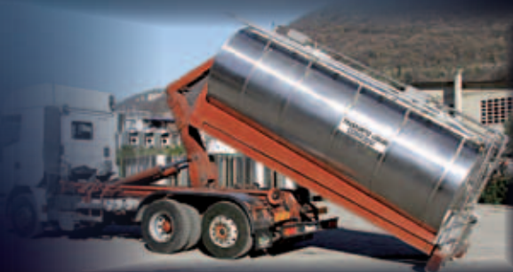
Droptank, tanque removível isolado de 15.000 l para alimentos
