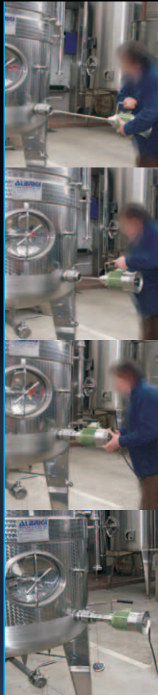
Aplicação de agitador extraível móvel Mobilmix aplicado em válvulas de descarga parcial
