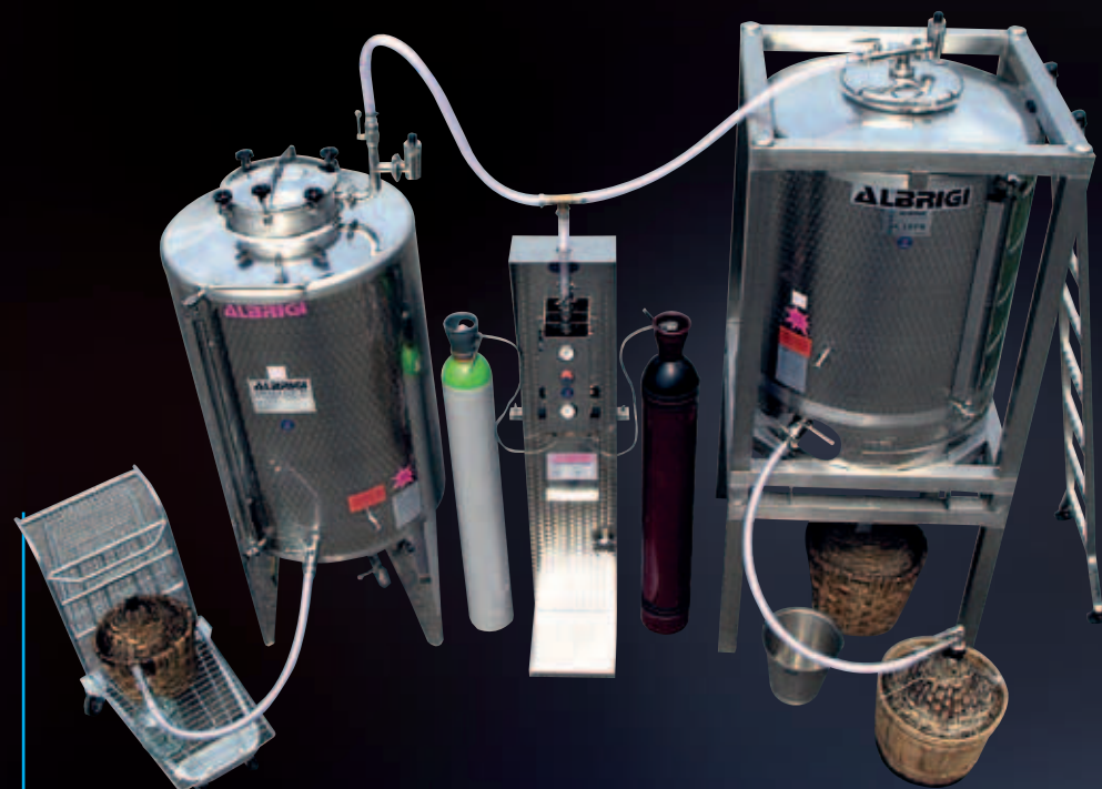
Enopalet de 1000 l isolado com central para azoto e Minitank série "S" de 1000 l
