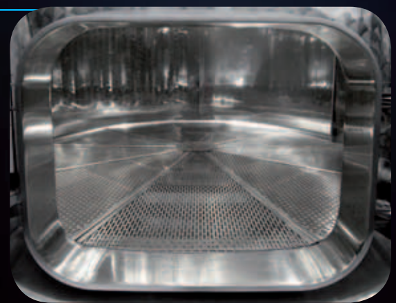
Grade móvel sobre o fundo para separar e drenar a uva do mosto
