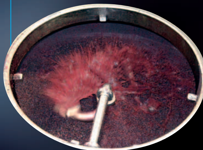
Aspersor Autofly autorotativo tipo Mono com o mosto
