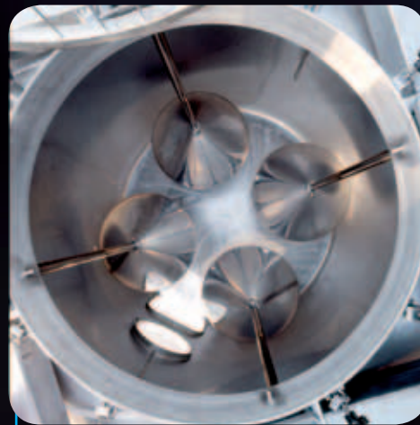
Vista do alto de um pé de recalque autolimpante
