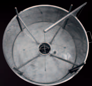
Vista de uma grade colocada em um tanque Semprepieno (sempre cheio) Variotank
