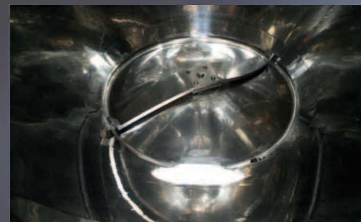
Vista interior de uma pá de extração polida a alto brilho
