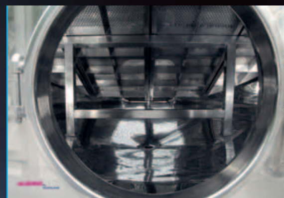
Vista interna da parte inferior da grade de escoamento através da portinhola inferior
