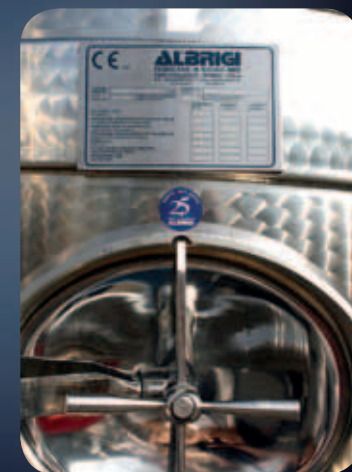
Placa em aço inox de certificação do teste PED
