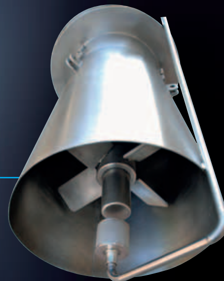
Parte inferior da turbina com elemento poroso para a injeção do oxigênio
