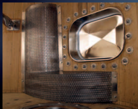
Grades de drenagem aplicadas em cubas de madeira à válvula de descarga total
