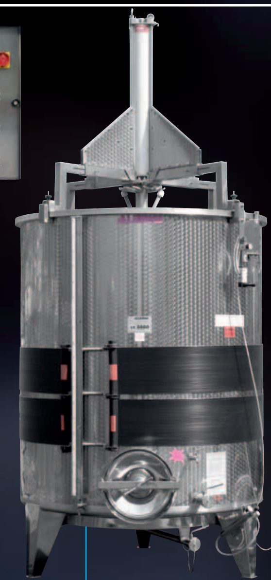
Vista exterior e desde o interior de um mecanismo de recalque "Monofolltank" em tanque Semprepieno (sempre cheio) de 50 hl
