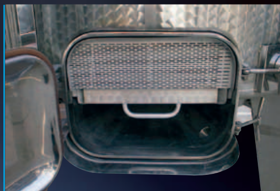
Grade móvel em porta retangular com deslizador de 530x420 mm
