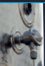
Sonda de temperatura com invólucro externo
