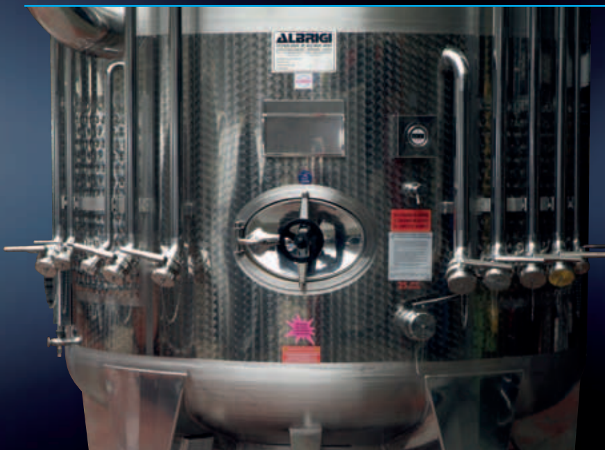
Válvulas de serviço para os compartimentos superiores de um Politanke de três compartimentos com descarga total, parcial, lavagem, azoto e remontagem
