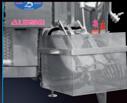
Grade de proteção das pessoas durante a descarga do bagaço
