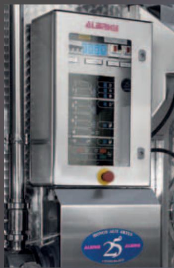
Bomba de carga do compartimento superior com oxigenador e quadro elétrico de comando
