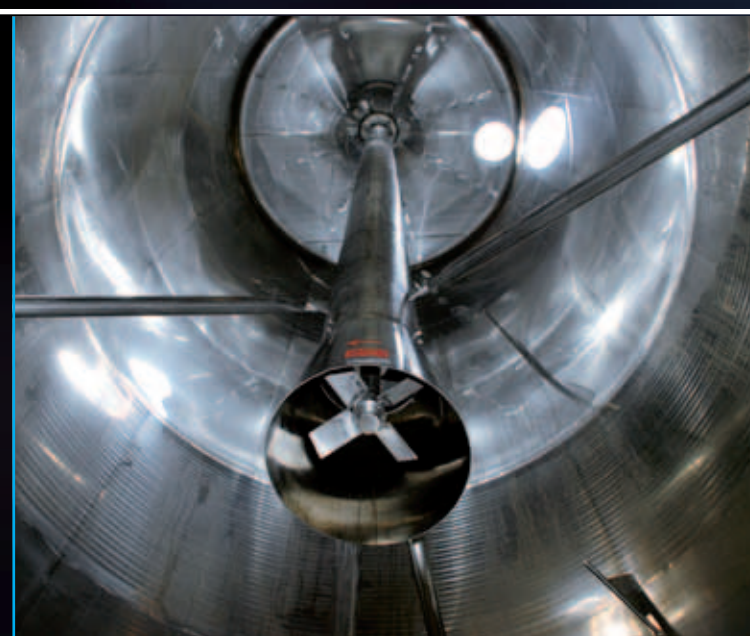
Turbotank aplicado no interior de um fermentador de 1000 hl
