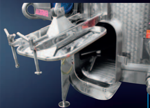
Porta retangular aberta com deslizador facilitado para a descarga
