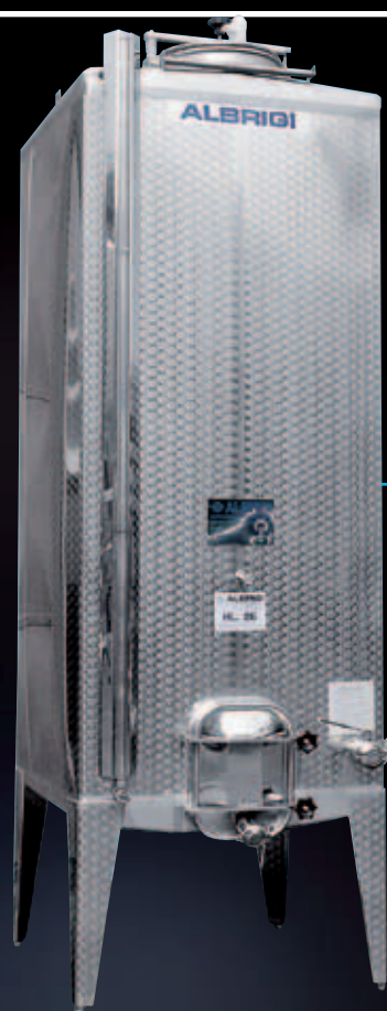
Série de tanques Compatank de 3-5-10 hl, independentes para armazenagem sobrepostos fixos
