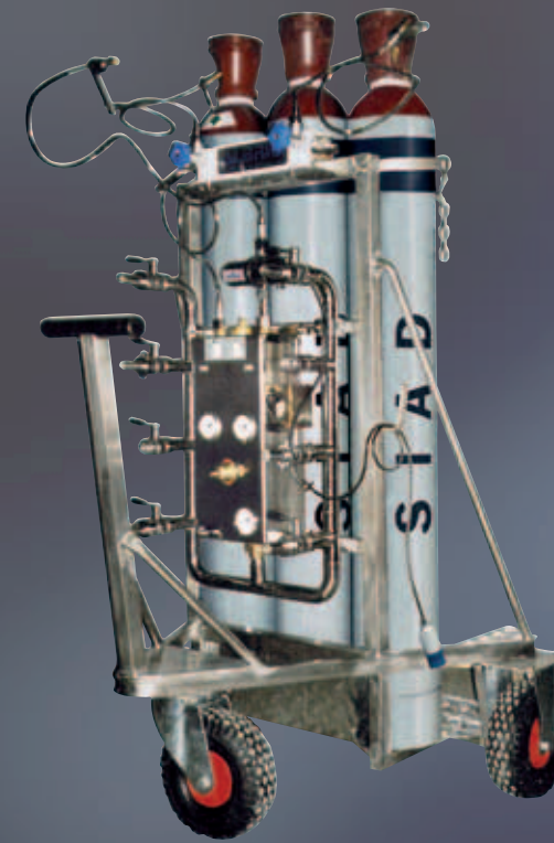
Central móvel para azoto ou CO 2 de 100 m 3 /h
