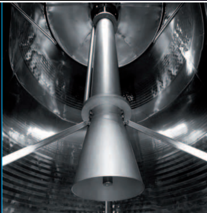
Turbotank "Termo", patenteado por Albrigi, aplicado no interior de um fermentador de 600 hl
