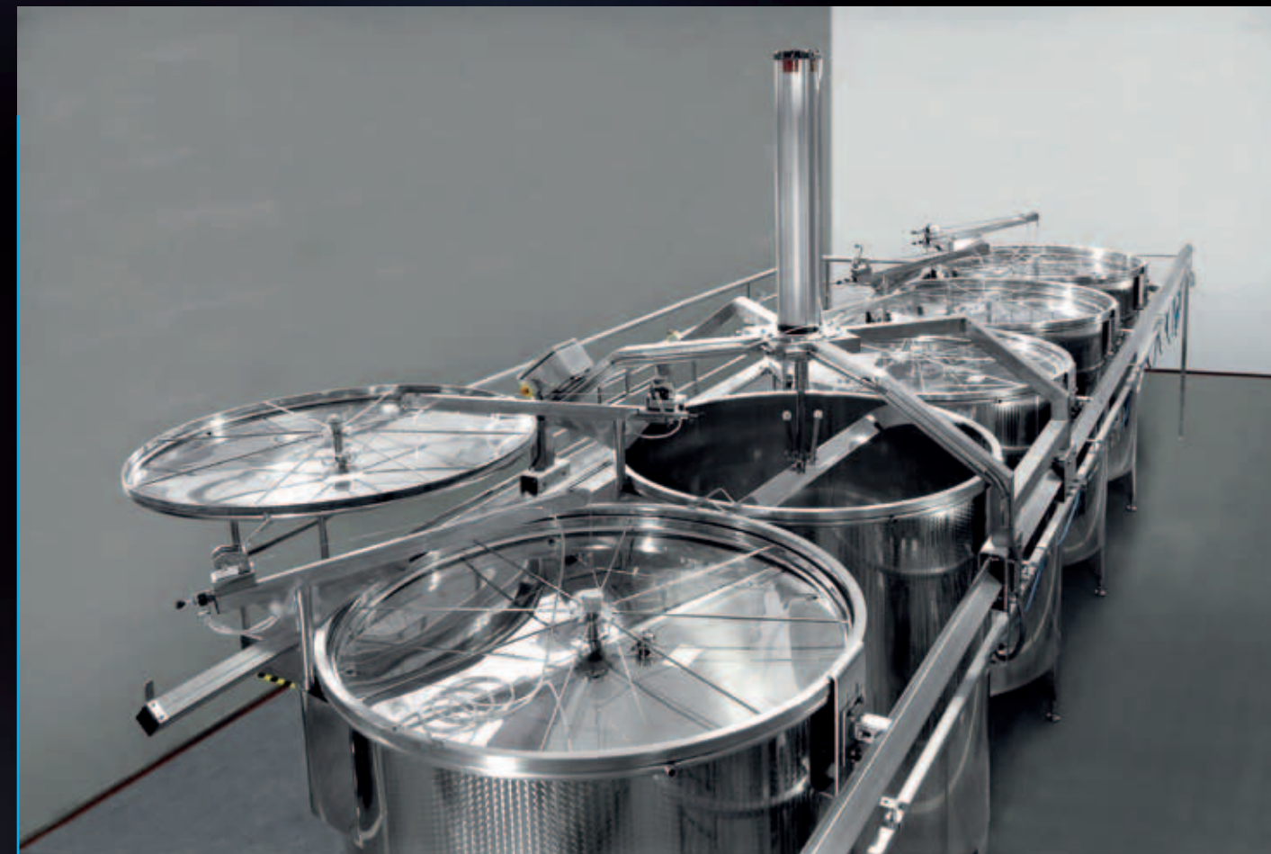
Recalcador de pá rotativa sobre trilho duplo que funciona tanto em manual como em automático
