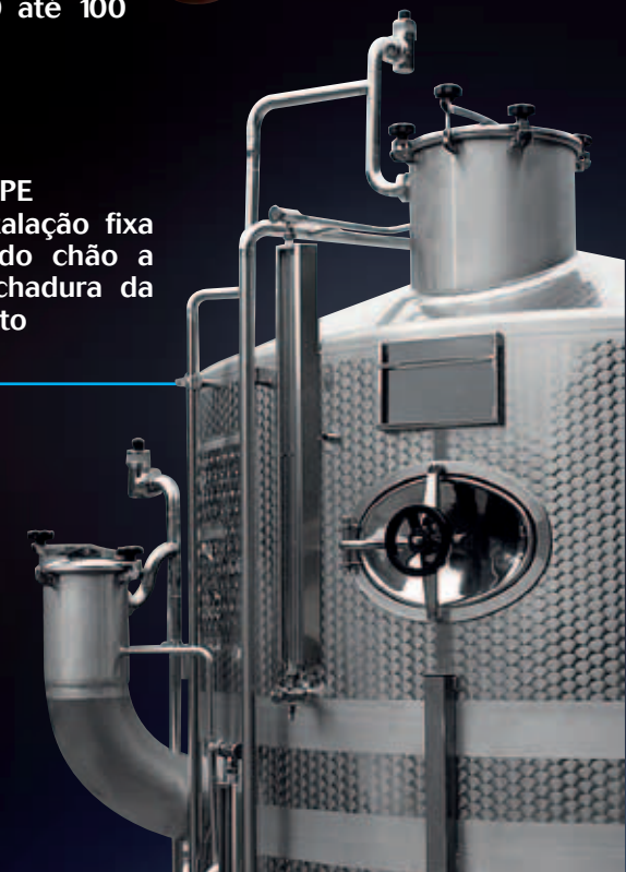
Central de armazenagem fixa, para servir mais tanques, funcionando a azoto ou CO desde 20 até 100 m 3 /h
