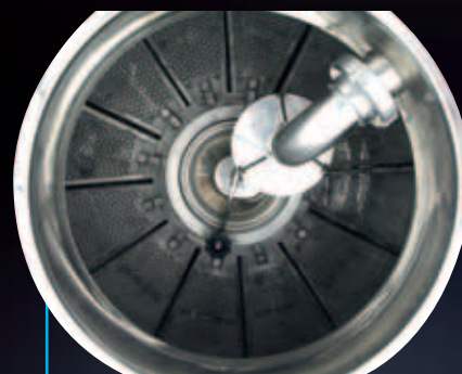
Disco dispersor para mosto sobre o mecanismo de manta submersa
