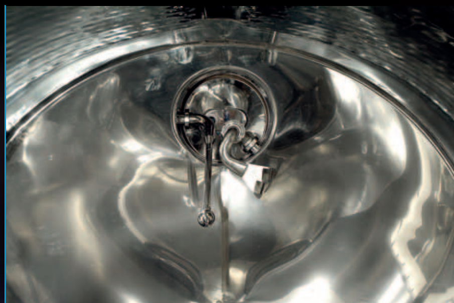
Vista interior do aspersor autorotativo para mosto e esfera de lavagem
