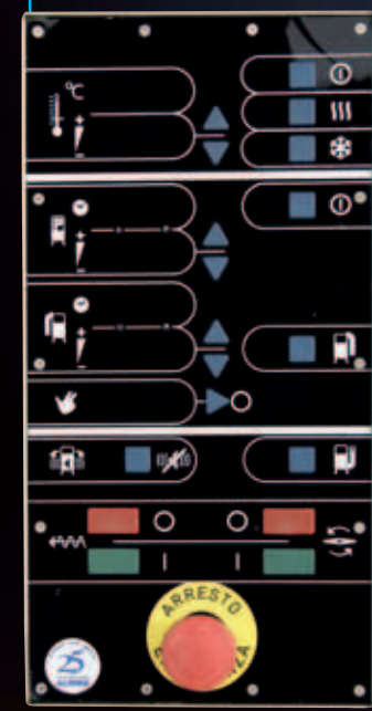
Quadro de comando com PLC
