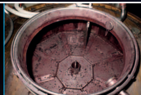
Mecanismo de manta submersa numa cuba de madeira, que pode ser desmontado desde o lado de fora
