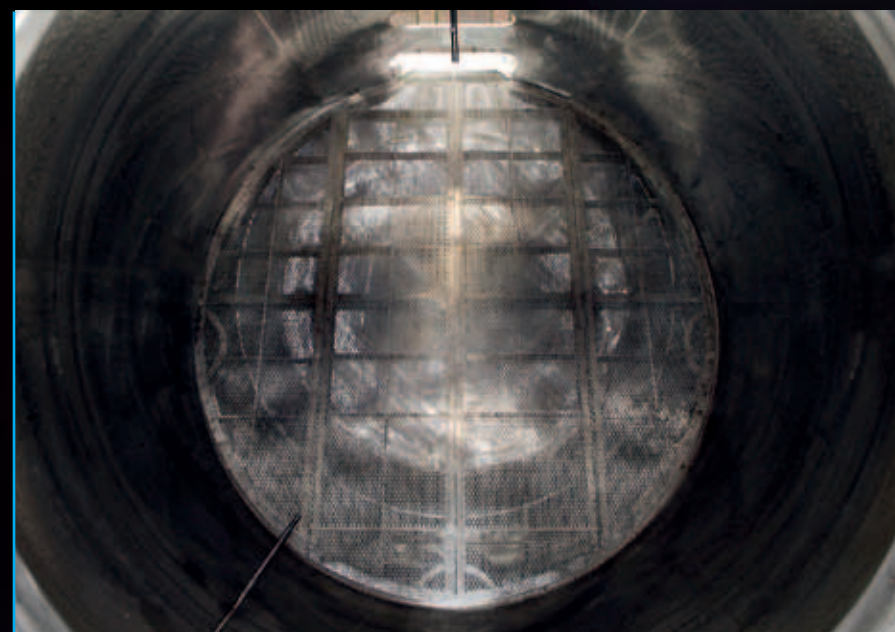
Vista do alto da grade de separação do bagaço do mosto, inclinada para frente de 45°
