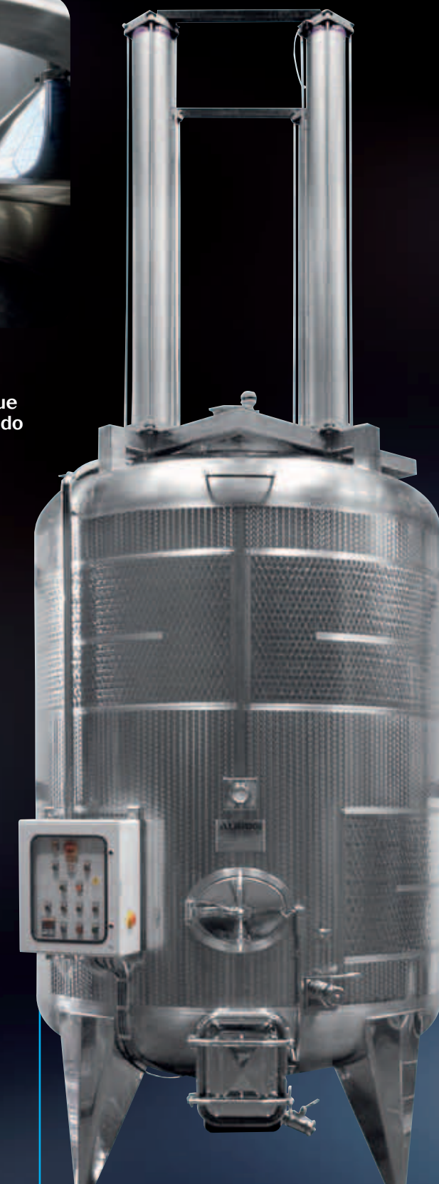
Recalcador de 4 pés especiais autolimpantes com êmbolos pneumáticos de carreira comprida
