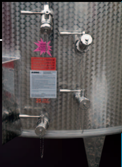
Grupo de válvulas de um Frigotank com descarga total, parcial, remontagem e válvula inclinada para agitador extraível MOBILMIX
