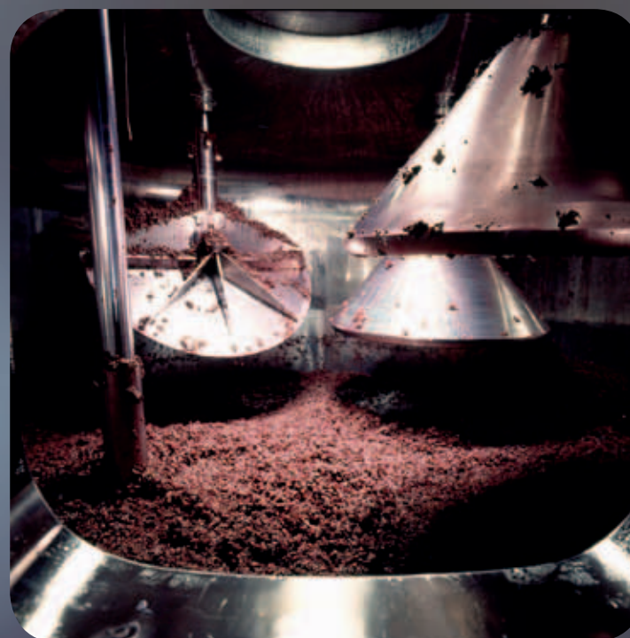
Vista interna durante o trabalho de recalque com 4 pés pneumáticos
