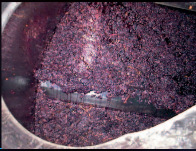
Pá de recalque que afunda no bagaço, autolimpante patenteada Albrigi
