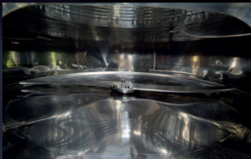
Mecanismo de extração do bagaço sobre o fundo plano inclinado de 3% para frente
