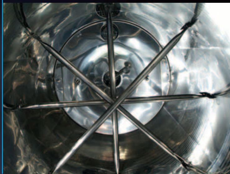
Aspersor Autofly autorotativo tipo Mono com o mosto
