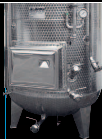
Frigotank com série de válvulas de descarga total e parcial e para agitador extraível Mobilmix e injetor de CO 2 de baixo
