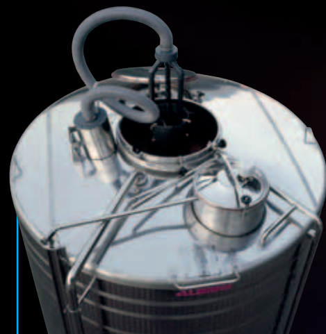
Válvula de cascata aplicada com oxigenador interno e turbina de ventilação
