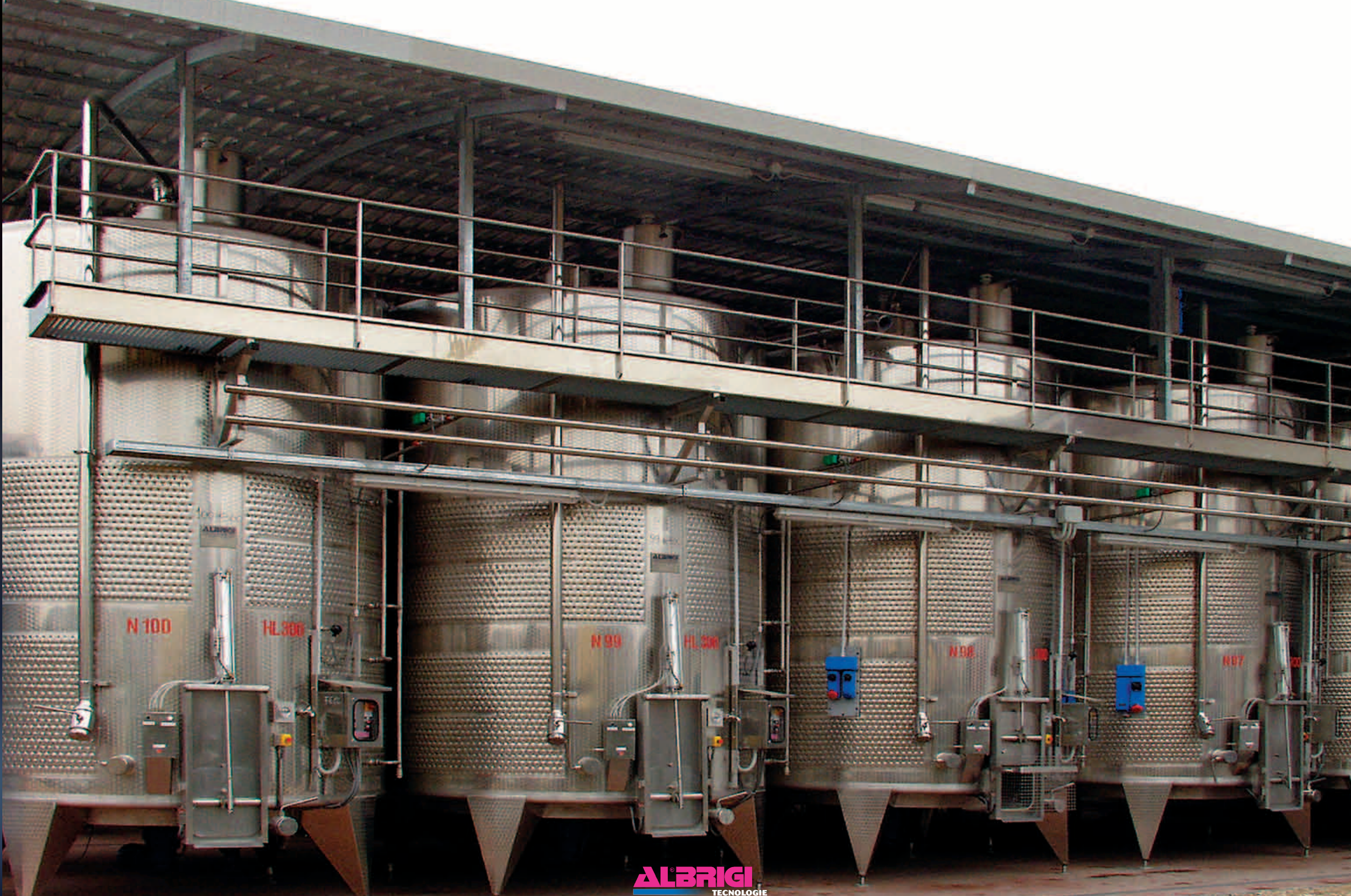
Fermentadores Meccanotank de 300 hl termocondicionados com Termostar Double com Palitank para délestage
