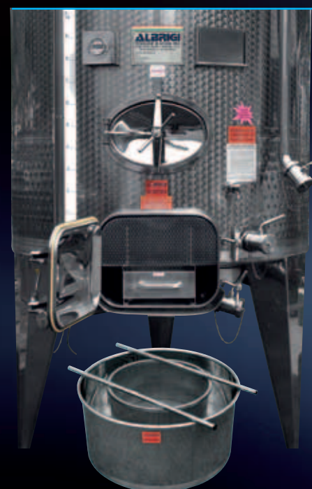
Vista de uma porta inferior para descarregar o bagaço com mecanismo de separação do mosto das películas
