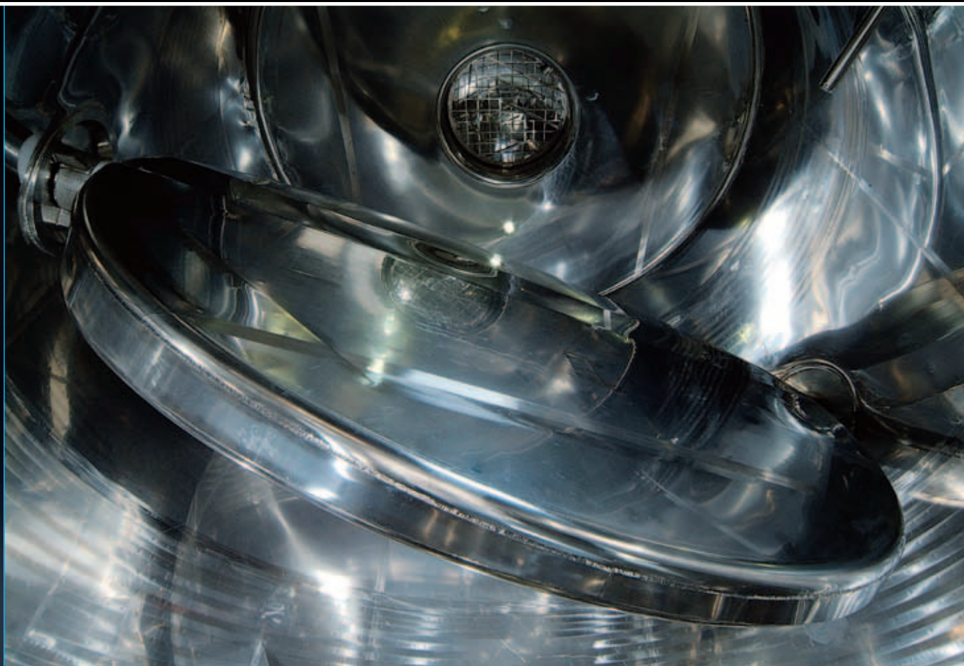
Pá rotativa, patenteada por Albrigi, de disco inteiro termocondicionada de ambos os lados
