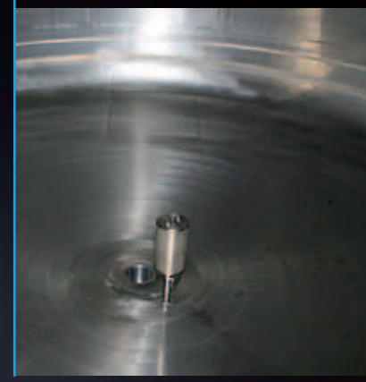
Elemento poroso em aço AISI 316 sinterizado colocado sobre o fundo para a emissão do CO 2 por debaixo
