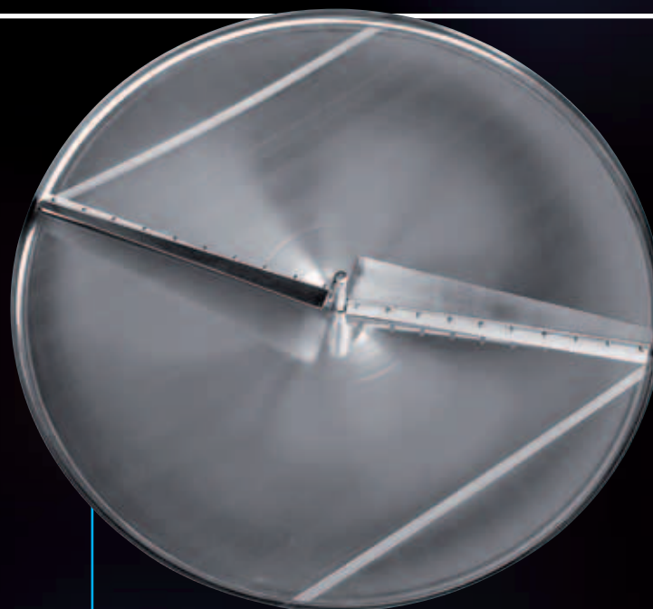
Vista da pá rotativa de Bâtonnage sobre o fundo
