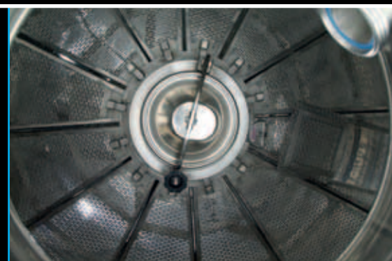
Vista superior com porta de saída da pressão do mosto em fermentação
