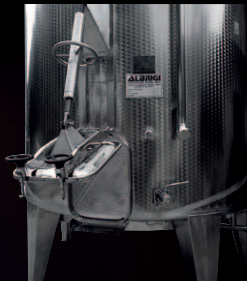
Porta retangular dianteira com mecanismo de abertura para cima para a descarga do bagaço
