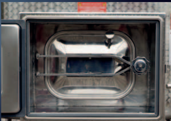
Porta retangular de 530x420 mm com contraporta isolada e aparelho para tiragem de amostras
