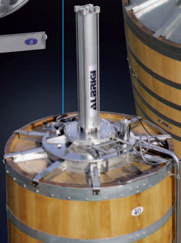
Vista do alto de céu de uma cuba com mecanismo Monofolltank
