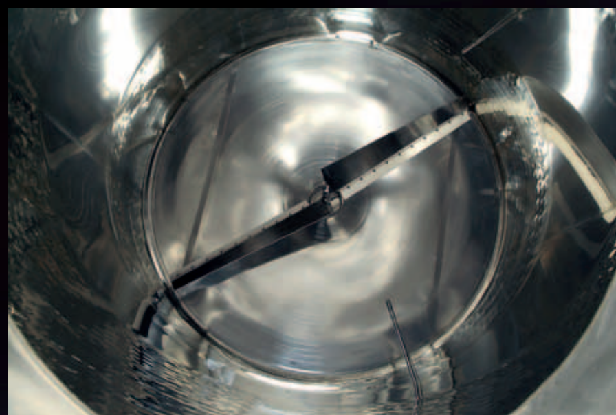
Vista da pá patenteada que roda sobre o fundo
