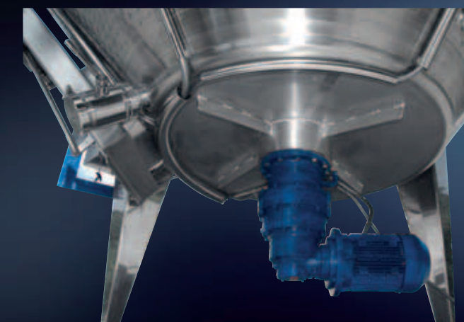
Fermentador Meccanotank série "S" de 1200 hl com cone munido de pá de extração e Turbotank
