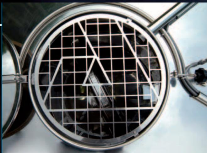
Верхний люк с защитной решеткой и предохранительным микровыключателем.
