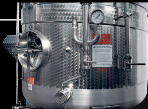
Предохранительный узел с клапаном, тарированным по стандарту PED
