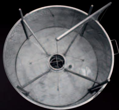
Вид решетки, установленной на емкости с плавающей крышкой Variotank
