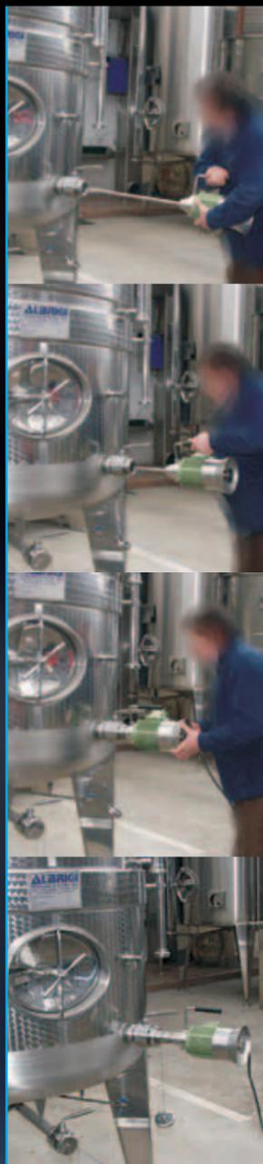
Установка передвижного съемного смесителя Mobilmix на клапаны частичной разгрузки
