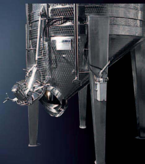
Вид сбоку Gravitank с открытой дверцей, с пневматическим механизмом открывания
