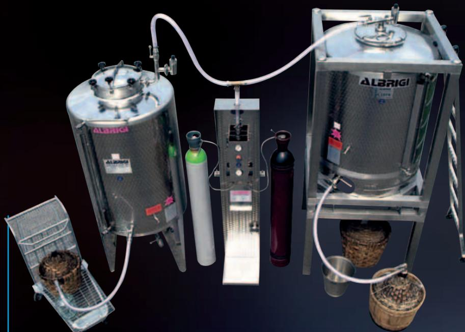
ЕноPalet вместимостью 1000 л с изоляцией и центральным блоком для подачи азота и Minitank серии "S" вместимостью 1000 л
