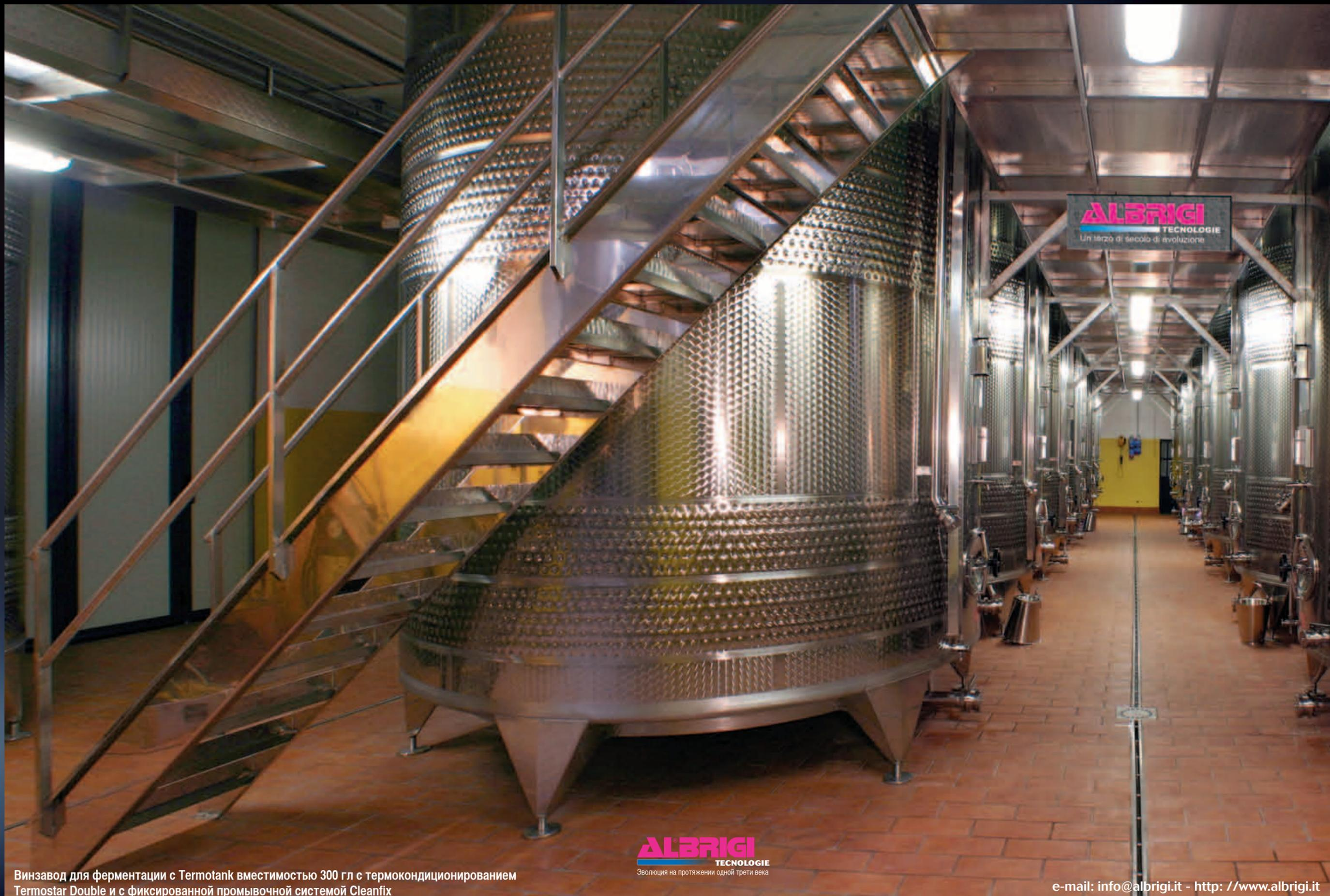
Винзавод для ферментации с Termotank вместимостью 300 гл с термокондиционированием Termostar Double и с фиксированной промывочной системой Cleanfix
