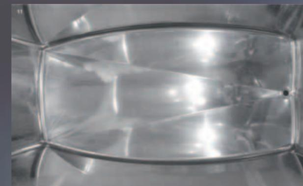
Вид сверху внутренней полости Compatank с закругленными кромками и углами, легко очищаемыми, и с фасонным саморазгружающимся днищем.
