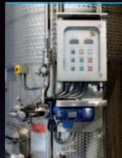
Электрический щит управления насосом или фазами погружения шапки
