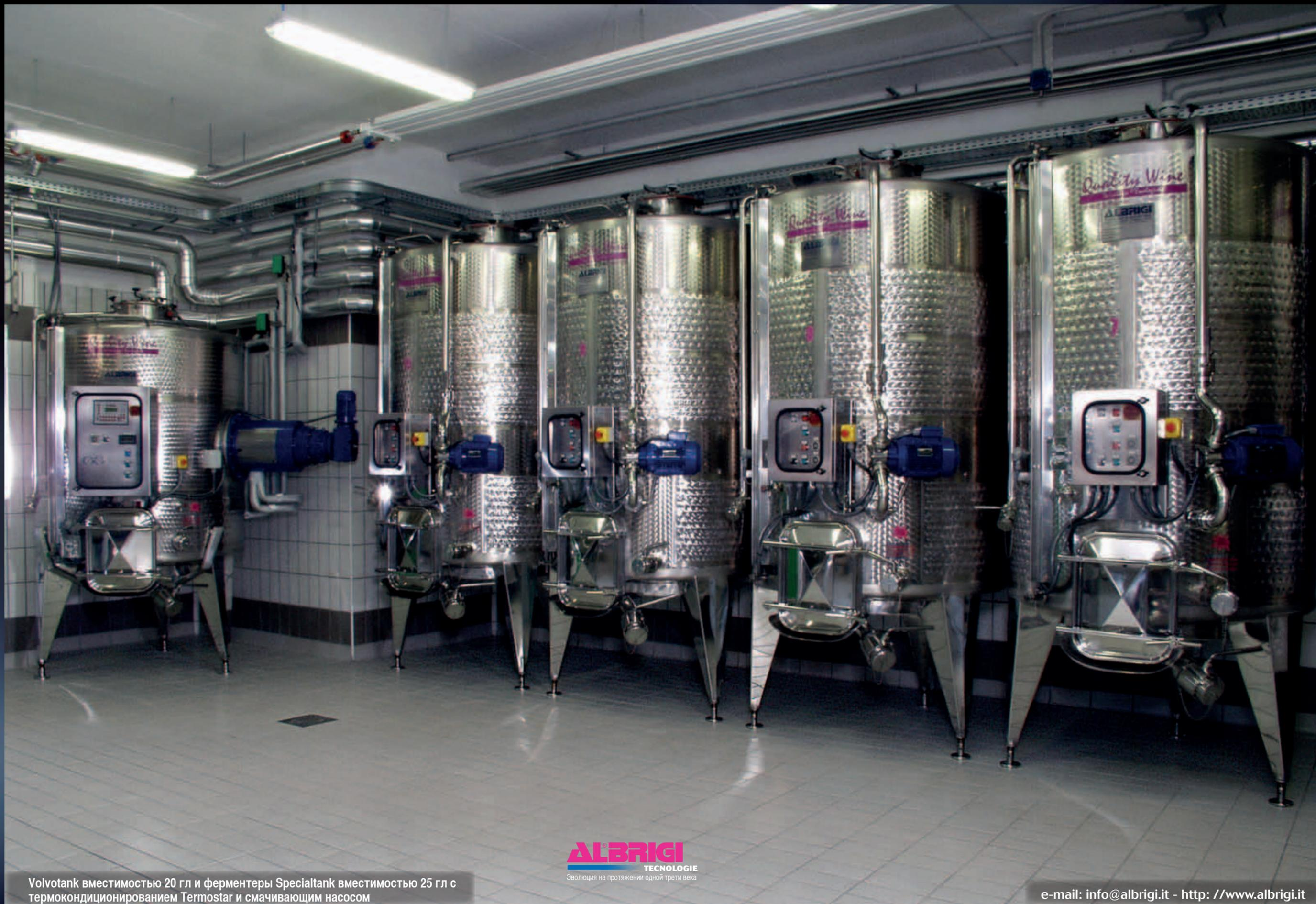
Volvotank вместимостью 20 гл и ферментеры Specialtank вместимостью 25 гл с термокондиционированием Termostar и смачивающим насосом
