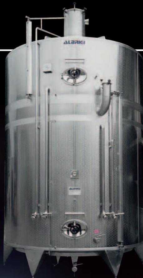
Politanк вместимостью 200 + 100 гл с промывочной системой Cleanfix и устройствами полной и частичной разгрузки отсеков, удлиненными вниз
