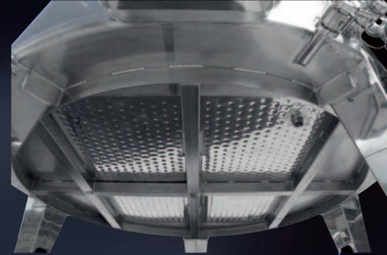
Плоское днище с передним наклоном 3% с термокондиционированием Termostar
