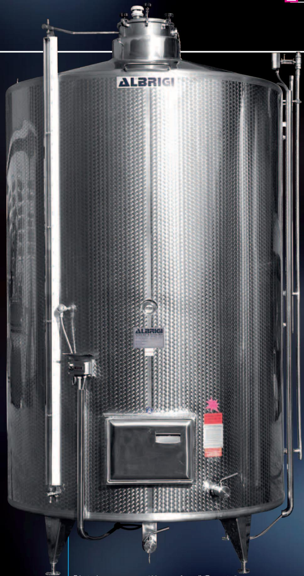
Фриготанк вместимостью 100 гл с рубашкой "Termostar", изоляцией "Isotank", узлом контроля температуры с моторизованным клапаном управления "Motorwave"
