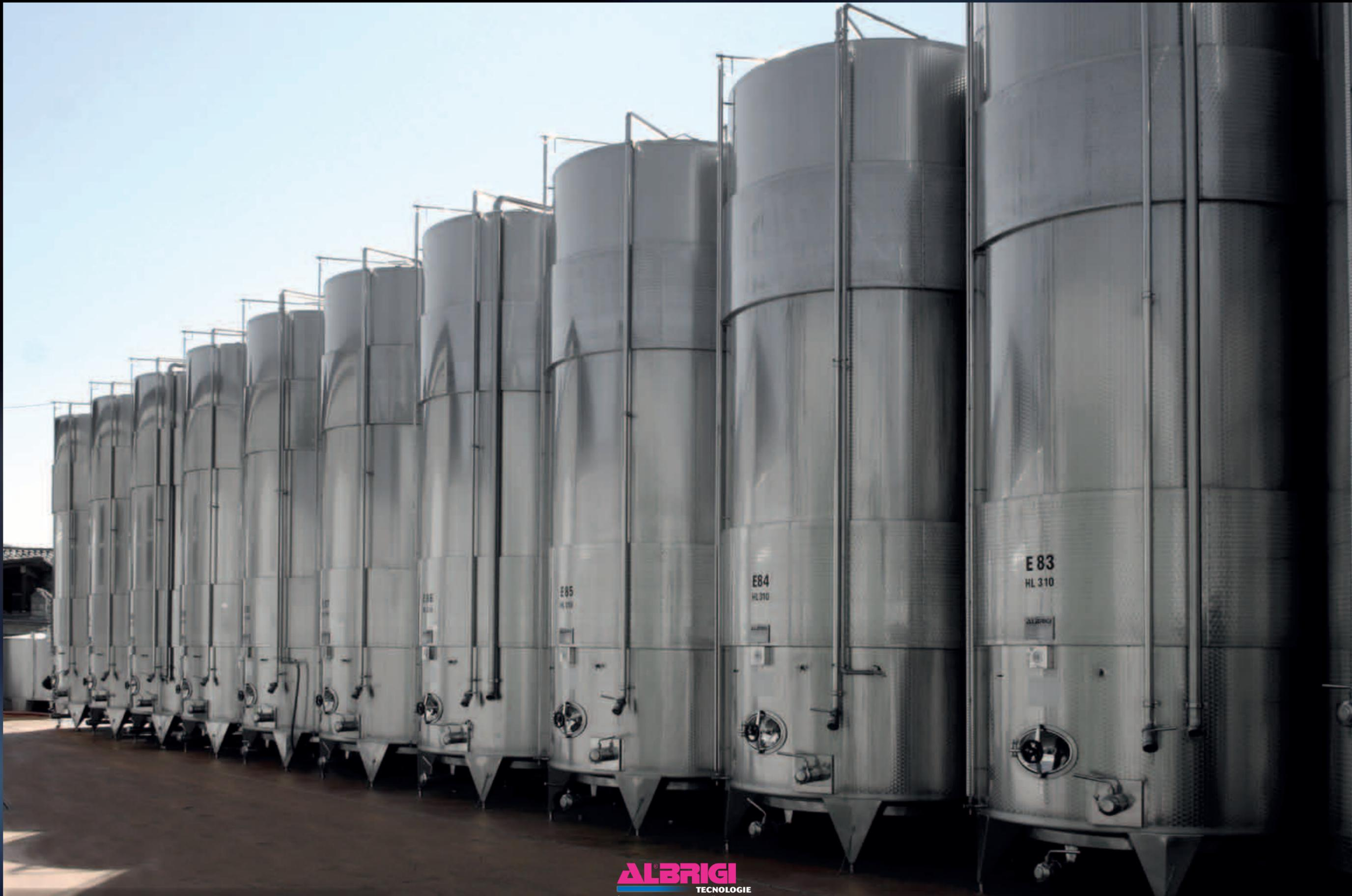
Набор Termotank double с термокондиционированием Termostar, изоляцией Isoplus на рубашке и с промывочной системой Cleanfix
