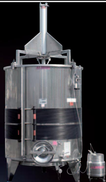
Variotank с Polifascia и специальный передвижной Monofolltank для емкостей с плавающей крышкой
