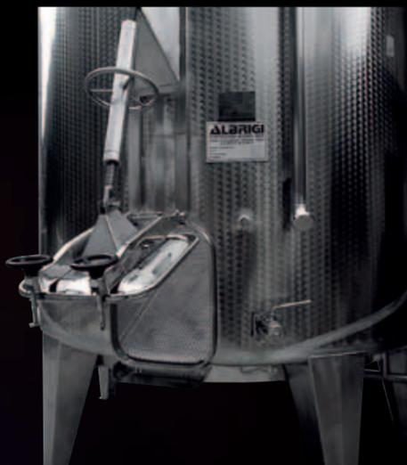
Передняя прямоугольная дверца с механизмом открывания вверх для разгрузки выжимок
