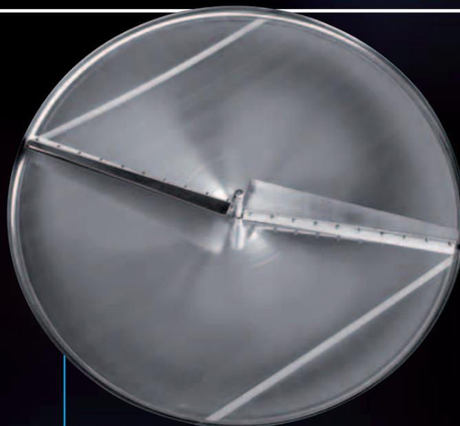
Вид вращающейся мешалки для батонажа на днище
