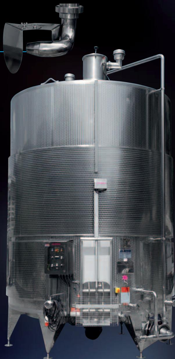
Ферментер Мессанотанк вместимостью 300 гл с плоским наклонным дном, мешалкой извлечения, насосом смачивания суслом и Palitank
