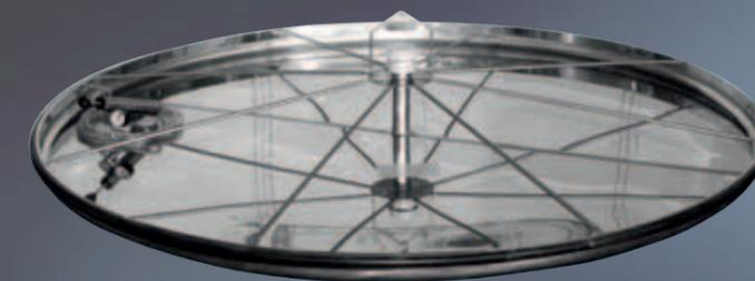
Подвижная крышка с пневматическим механизмом герметичного закрывания.
