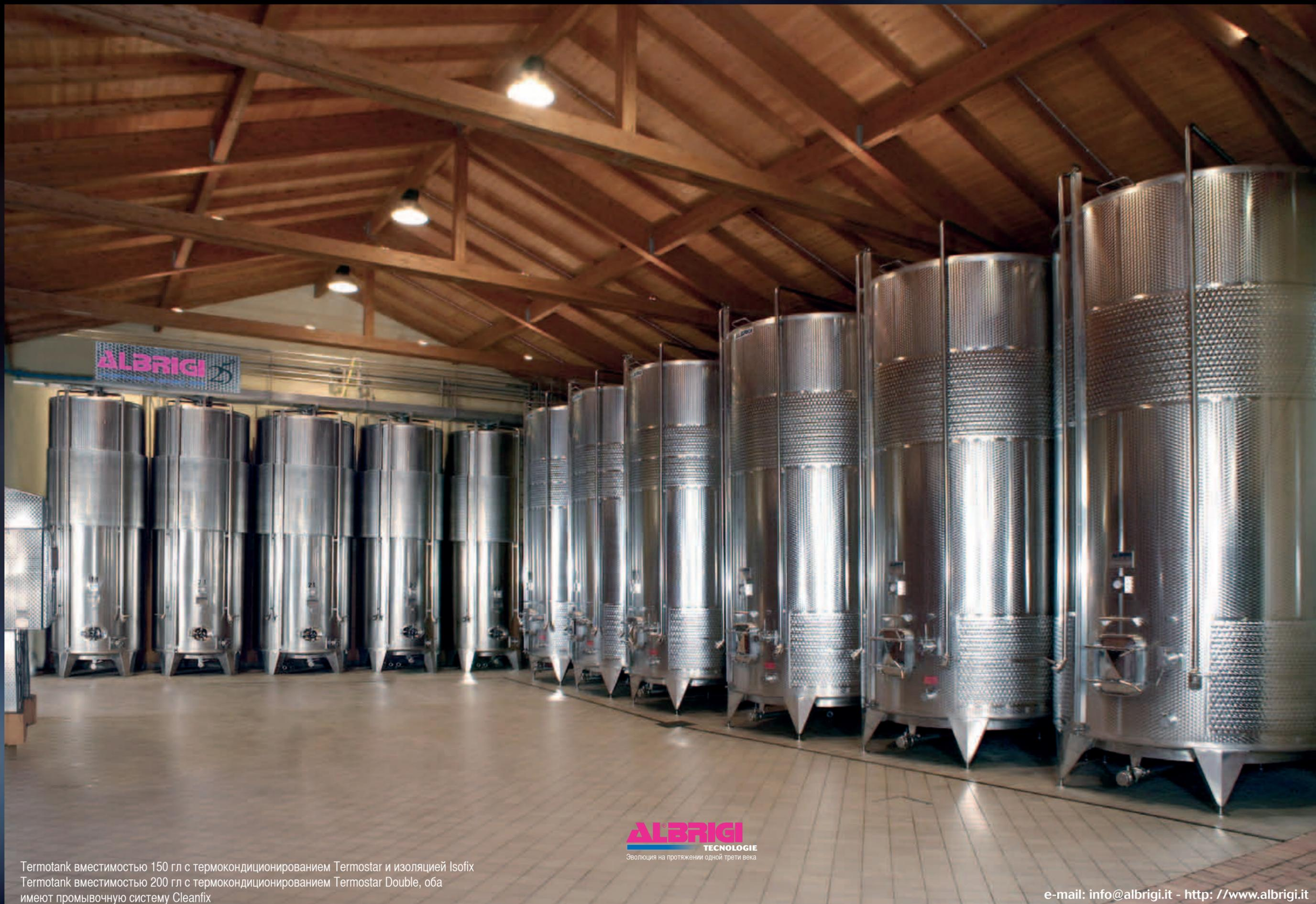
Термотанк вместимостью 150 гл с термокondиционированием Termostar и изоляцией Isofix
