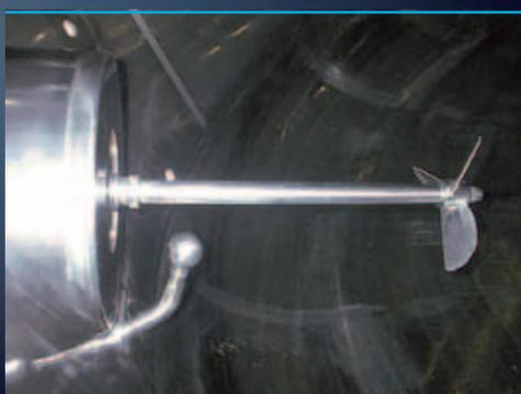
Шаровая промывочная форсунка Spray-ball™ для чистки смесителя и механического уплотнения
