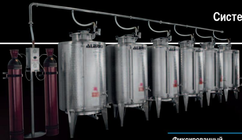
Набор емкостей под азотом с Inpergas для хранения разливного вина
