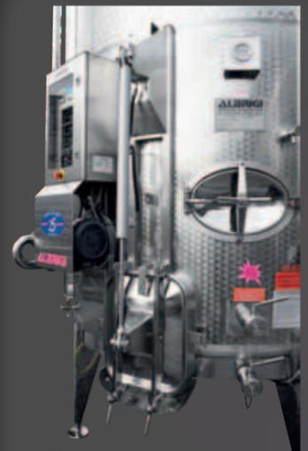
Насос загрузки верхнего отсека с устройством насыщения кислородом и электрическим щитом управления
