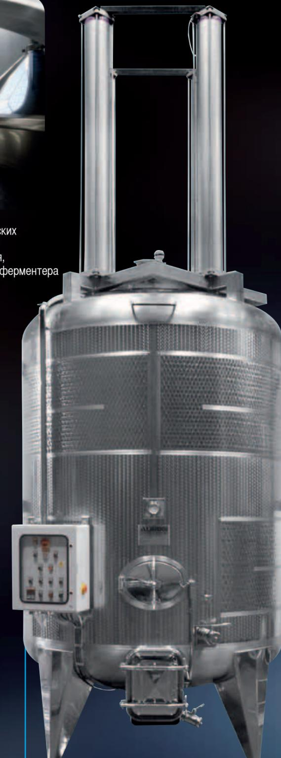
Механизм для погружения шапки с 4 специальными, самоочищающимися ножками и пневматическими цилиндрами с длинным ходом
