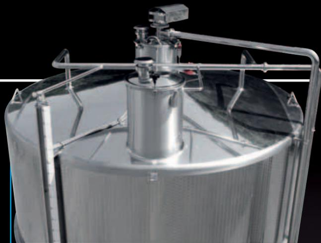
Верх ферментера с двойным люком, моторизованным оросителем "Motofly" и промывочной системой "Cleanfix"
