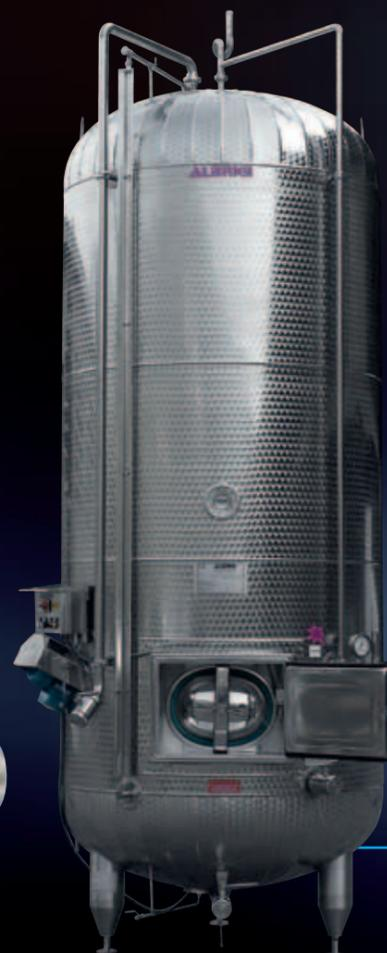
Автоклав Pressuretank с термокondиционированием Termotig и изоляцией Isotherm в комплекте со смесителем Side-tix, предохранительным узлом с клапаном, тарированным по стандарту PED, и фиксированной промывочной системой Cleanfix
