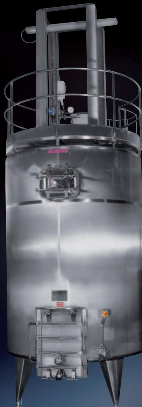
Гидравлический механизм для погружения шапки с 4 специальными, самоочищающимися ножками и ПЛК для управления попеременными фазами погружения шапки
