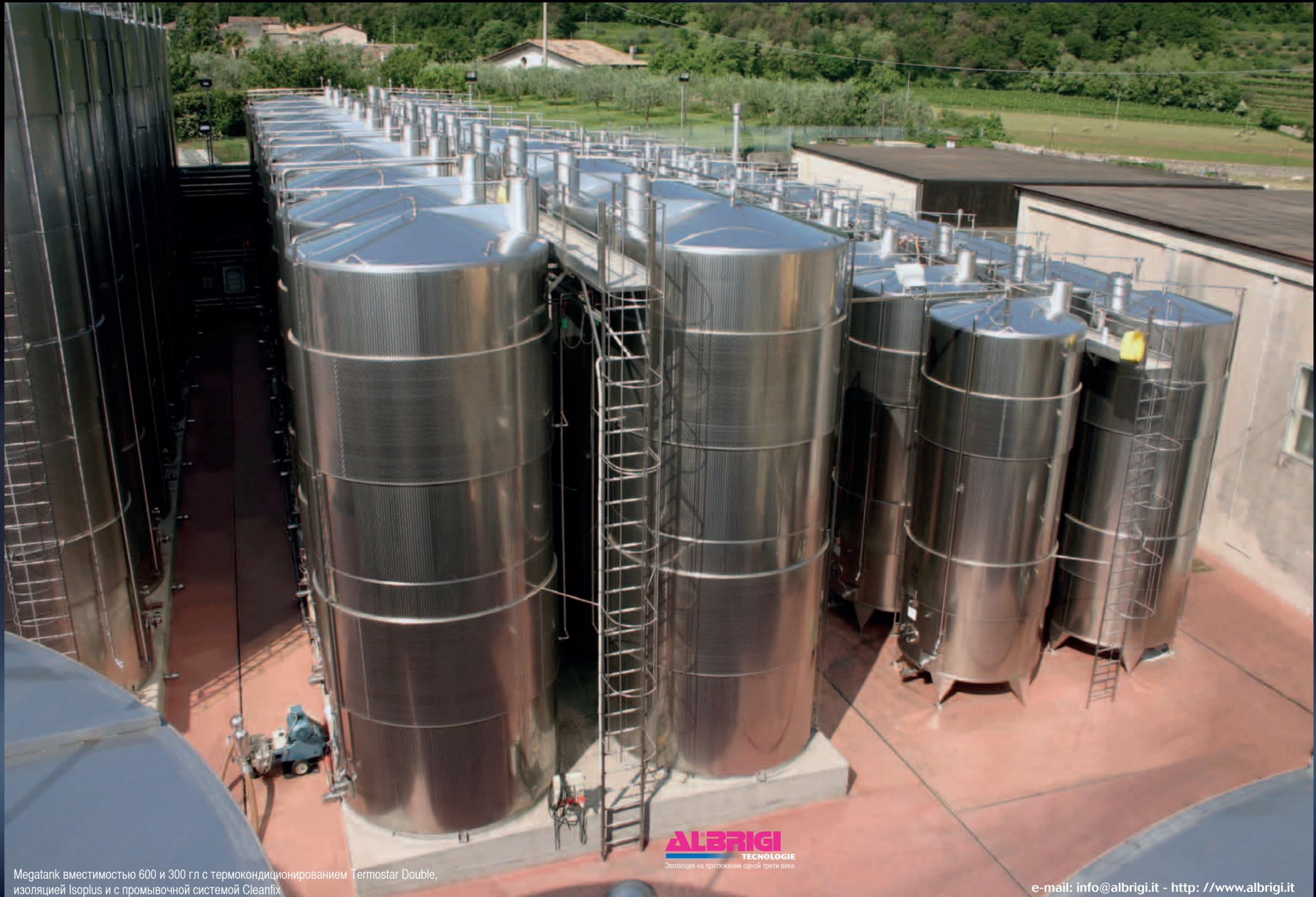
Мегатанк вместимостью 600 и 300 гл с термокondиционированием Termostar Double, изоляцией Isoplus и с промывочной системой Cleanfix
