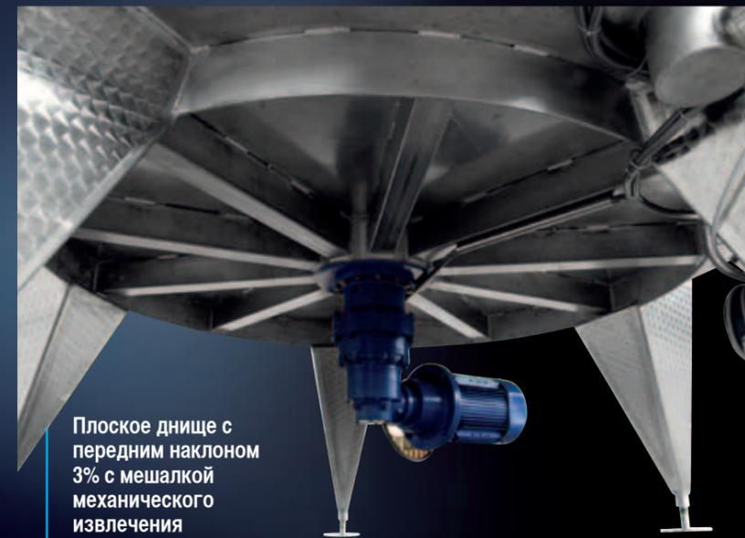
Плоское днище с передним наклоном 3% с мешалкой механического извлечения
