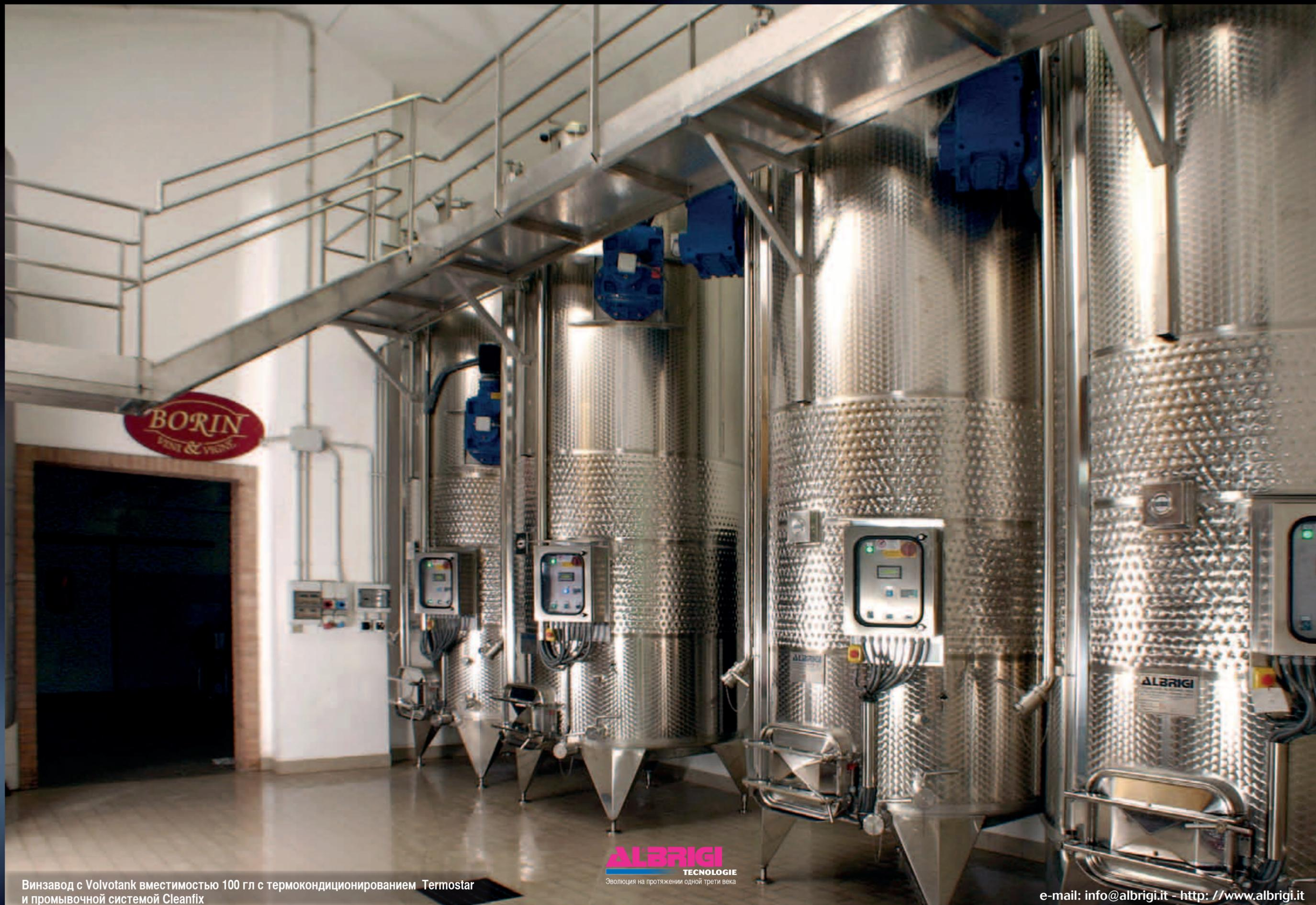
Винзавод с Volvotank вместимостью 100 гл с термокондиционированием Termostar и промывочной системой Cleanfix
