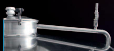
Система насыщения кислородом как ручного, так и моторизованного типа
