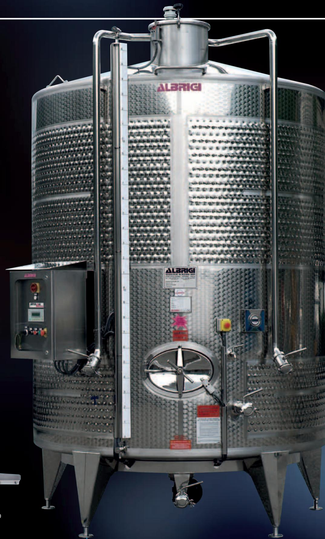
Емкость для батонажа Termotank для обработки тонкого осадка после ферментации, патент компании Albrigi
