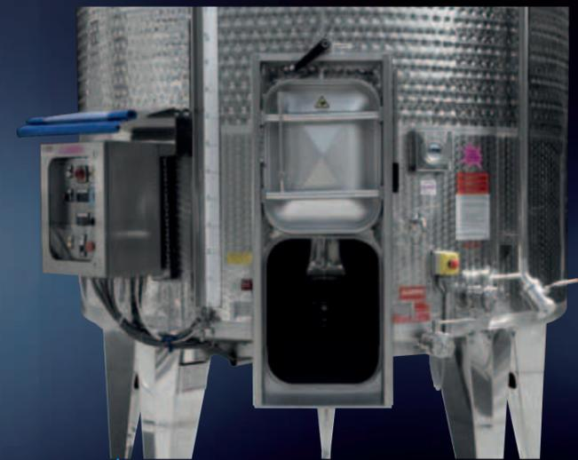
Опускная дверца в открытом состоянии с мешалкой для извлечения выжимок
