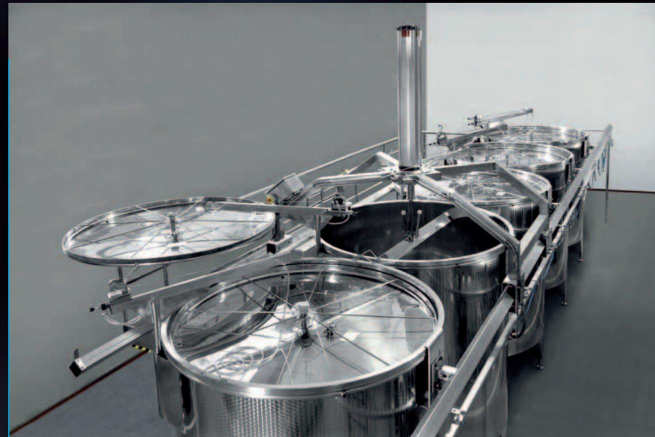
Механизм для погружения шапки с вращающейся мешалкой на двойном рельсе, работающий в ручном или автоматическом режиме
