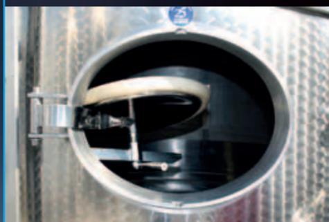
Фиксированная промывочная система Cleanfix для внутренней промывки бокового смесителя Sidemix
