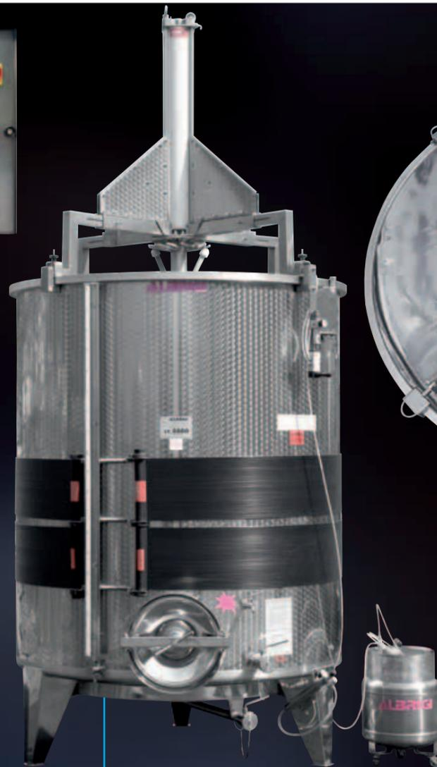
Вид снаружи и изнутри механизма для погружения шапки "Monofolltank" на емкости с плавающей крышкой вместимостью 50 гл
