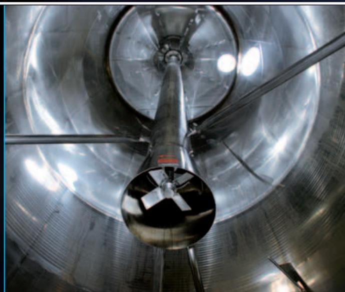
Turbotank, установленный внутри ферментера вместимостью 1000 гл
