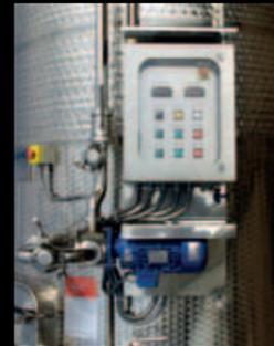
Микро устройство насыщения кислородом, устанавливаемое на клапан частичной разгрузки
