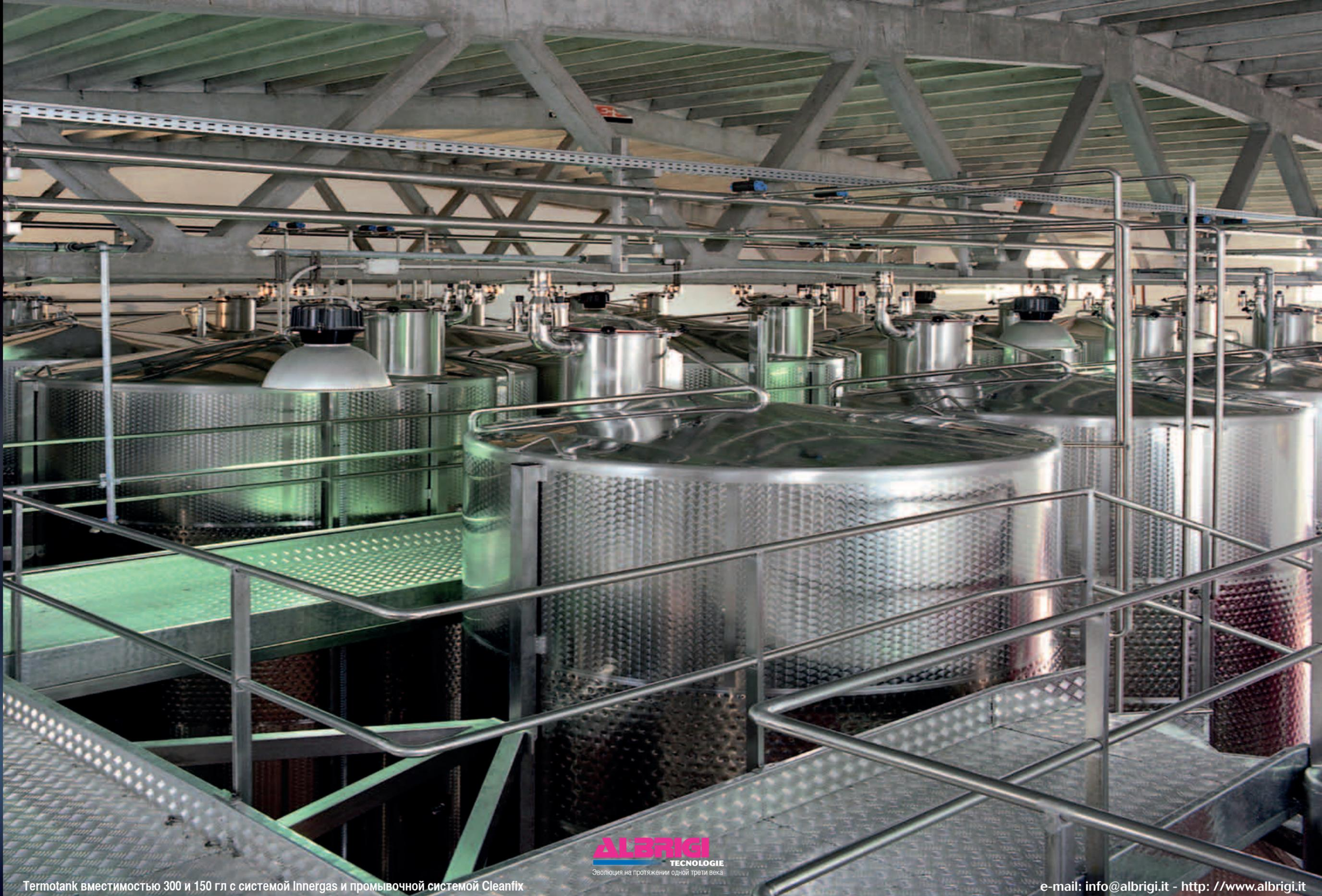
Termotank вместимостью 300 и 150 гл с системой Innergas и промывочной системой Cleanfix
