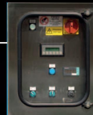
Щит для автоматического контроля температуры и для управления смесителем
