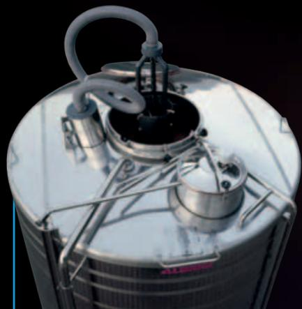
Установленный каскадный клапан с внутренним устройством насыщения кислородом и аэрационной турбиной
