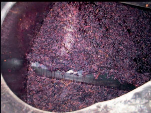
Самоочищающаяся, запатентованная компанией Albri-gi мешалка для погружения шапки, утопающая в выжимки
