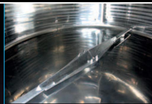
Мешалка механического извлечения выжимок
