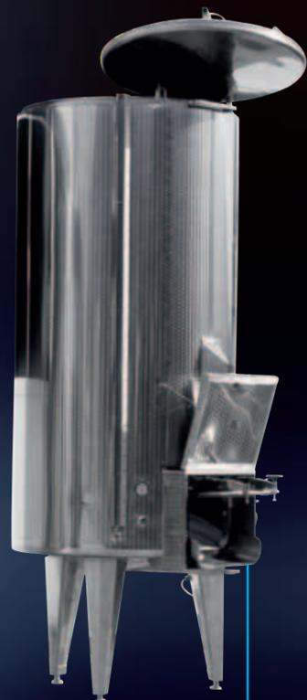
Variotank с изоляцией Isofix с кондиционирующей рубашкой Termostar для криомацерации
