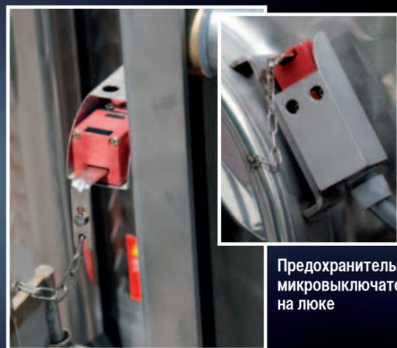
Предохранительный микровыключатель на люке
