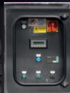
Щит управления температурой и автоматическим смачиванием суслом
