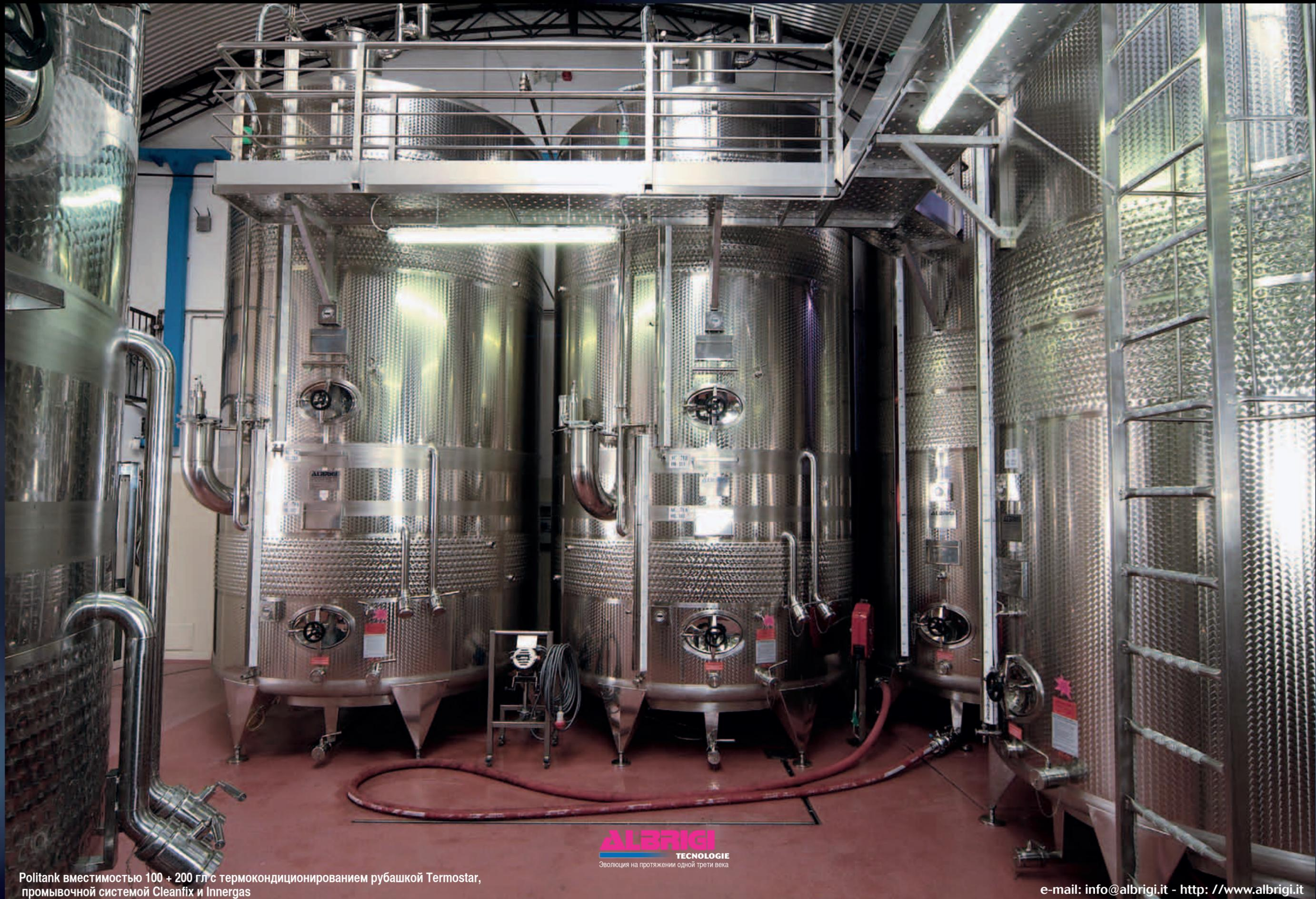
Politank вместимостью 100 + 200 гл с термокондиционированием рубашкой Termostar, промывочной системой Cleanfix и Innergas
