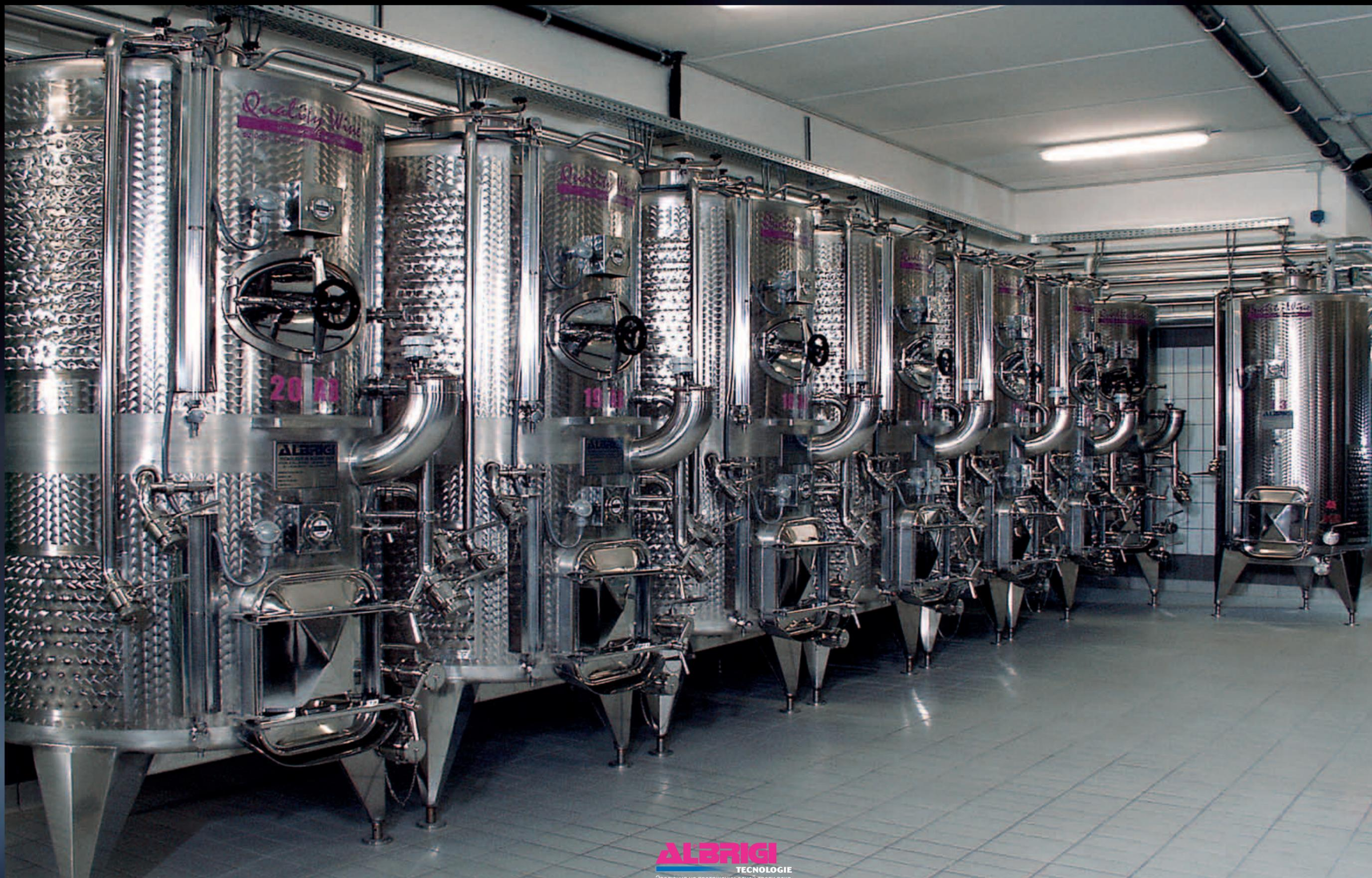
Politank Termo вместимостью 10 + 15 гл с нижним отсеком для ферментации и верхним отсеком для хранения, все они с термокондиционированием Termostar и с промывочной системой Cleanfix
