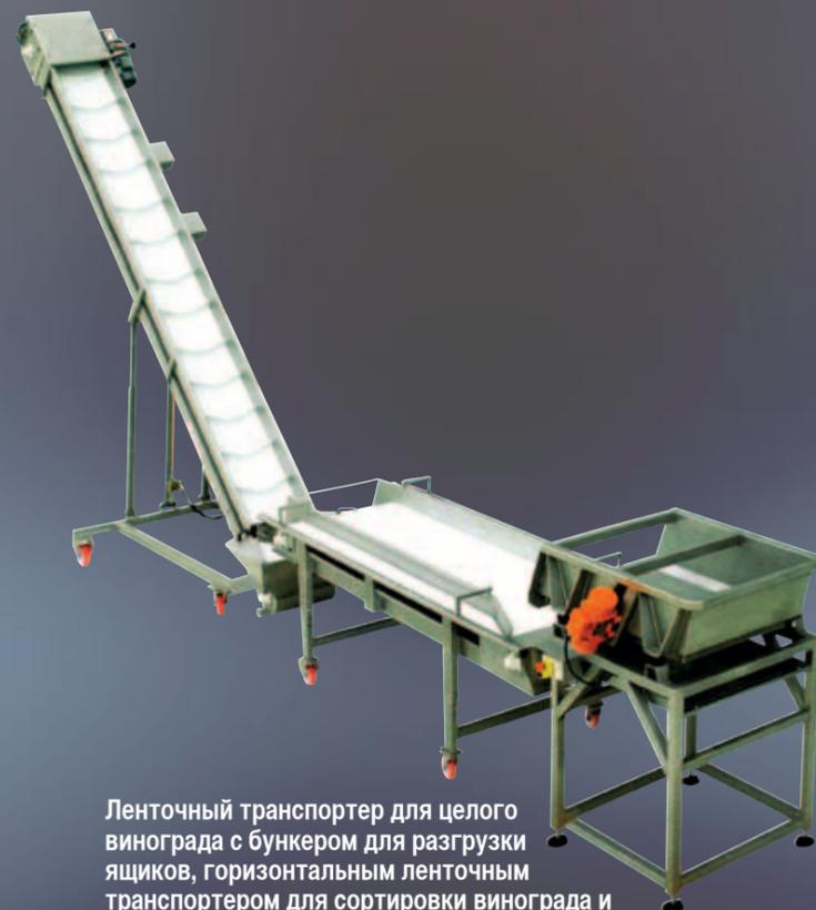
Ленточный транспортер для целого винограда с бункером для разгрузки ящиков, горизонтальным ленточным транспортером для сортировки винограда и поднимающимся ленточным транспортером для погрузки целого винограда в Noveltank сверху через воронку
