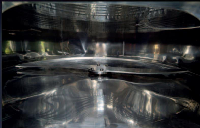
Механизм извлечения выжимок на плоском днище с передним наклоном 3%
