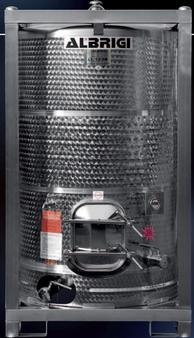
Епоралет вместимостью 1530 л с прямоугольной дверцей и кондиционирующей рубашкой, с термометром и температурным зондом с 2 клапанами, идеально подходит для микроферментации
