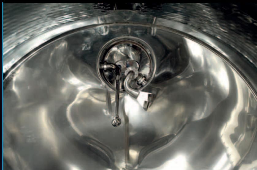
Вид изнутри самовращающегося оросителя для сула с шаровой промывочной форсункой
