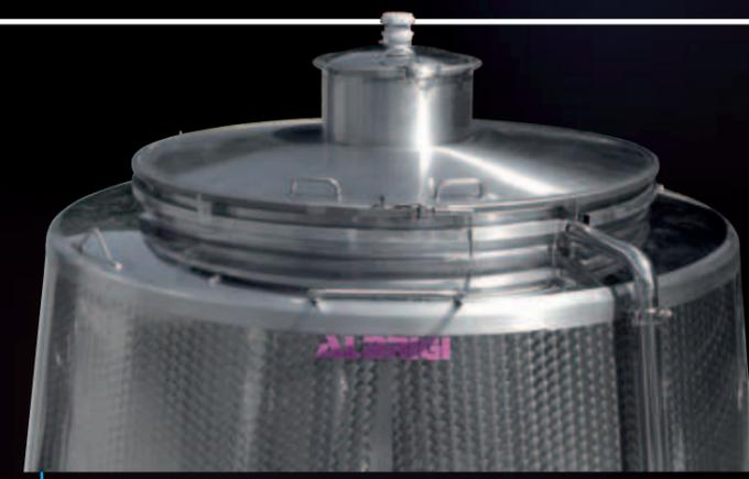
Очень большой герметичный люк с регулируемым полосовым затвором и быстрым отцеплением
