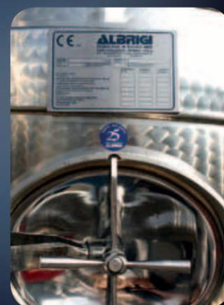
Табличка из нержавеющей стали с сертификацией проведения испытания PED
