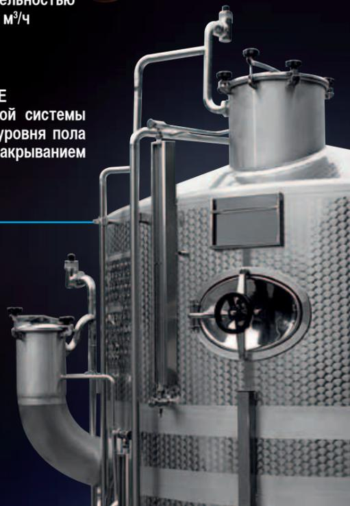
Фиксированный блок управления насыщением газом с Inpergas для обслуживания нескольких емкостей, работающий на азоте или CO<sub>2</sub>, производительностью от 20 до 100 м<sup>3</sup>/ч
