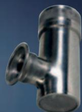
Клапан двойного действия из нержавеющей стали  $\varnothing$  40 - 50 - 60 - 80 мм, съемный, с 2 весовыми тарелками для избыточного давления и разрежения, скольцевыми уплотнениями из вайтона и не склеивающегося тефлона
