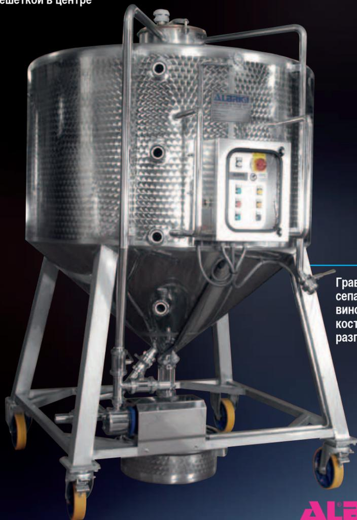
Гравитационный сепаратор виноградных косточек с разгрузкой снизу
