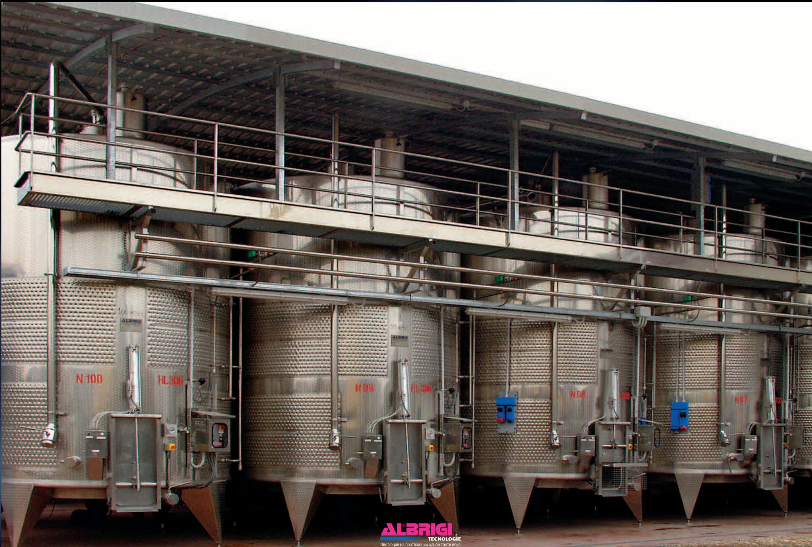
Ферментеры Мессанотанк вместимостью 300 гл с термокондиционированием Termostar Double и с Palitank для делястажа
