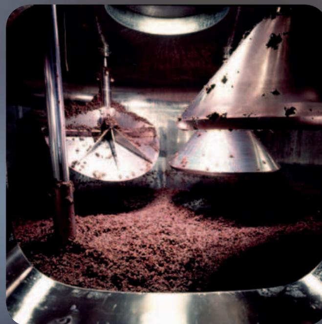
Вид изнутри во время обработки с погружением шапки 4 пневматическими ножками
