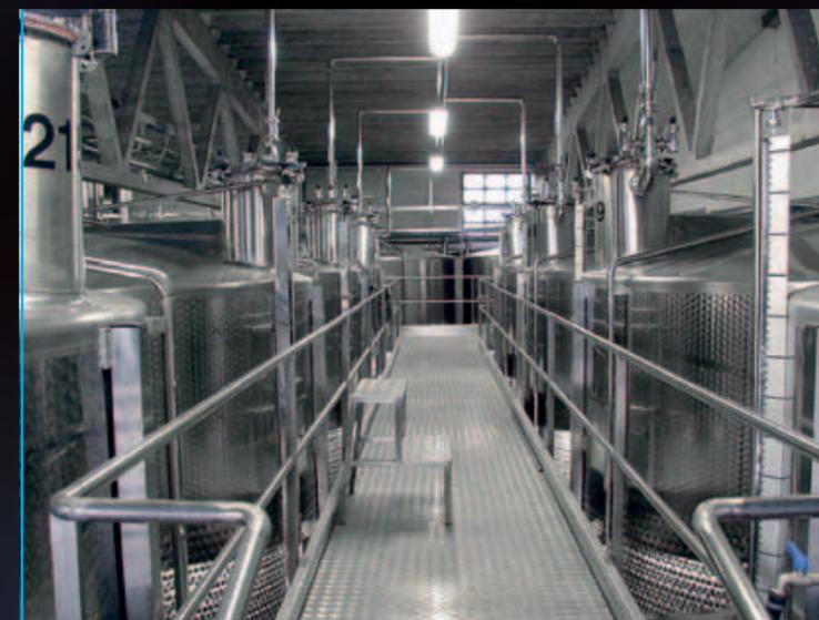
Pasarela con tanques de 300 hl, con grupo de seguridad y sistema fijo de tubos en acero inox "Innerpipe"
