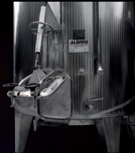
Puerta rectangular delantera con mecanismo de abertura hacia arriba para descargar el orujo
