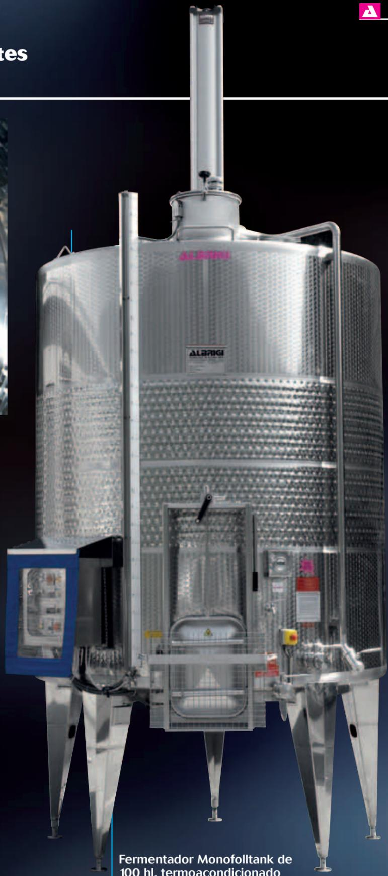
Fermentador Monofolltank de 100 hl, termocondicionado equipado del mecanismo de bazuqueo que al final de la fermentación puede desmontarse y guardarse; de esta forma, el fermentador se vuelve un tanque sencillo para almacenar vino
