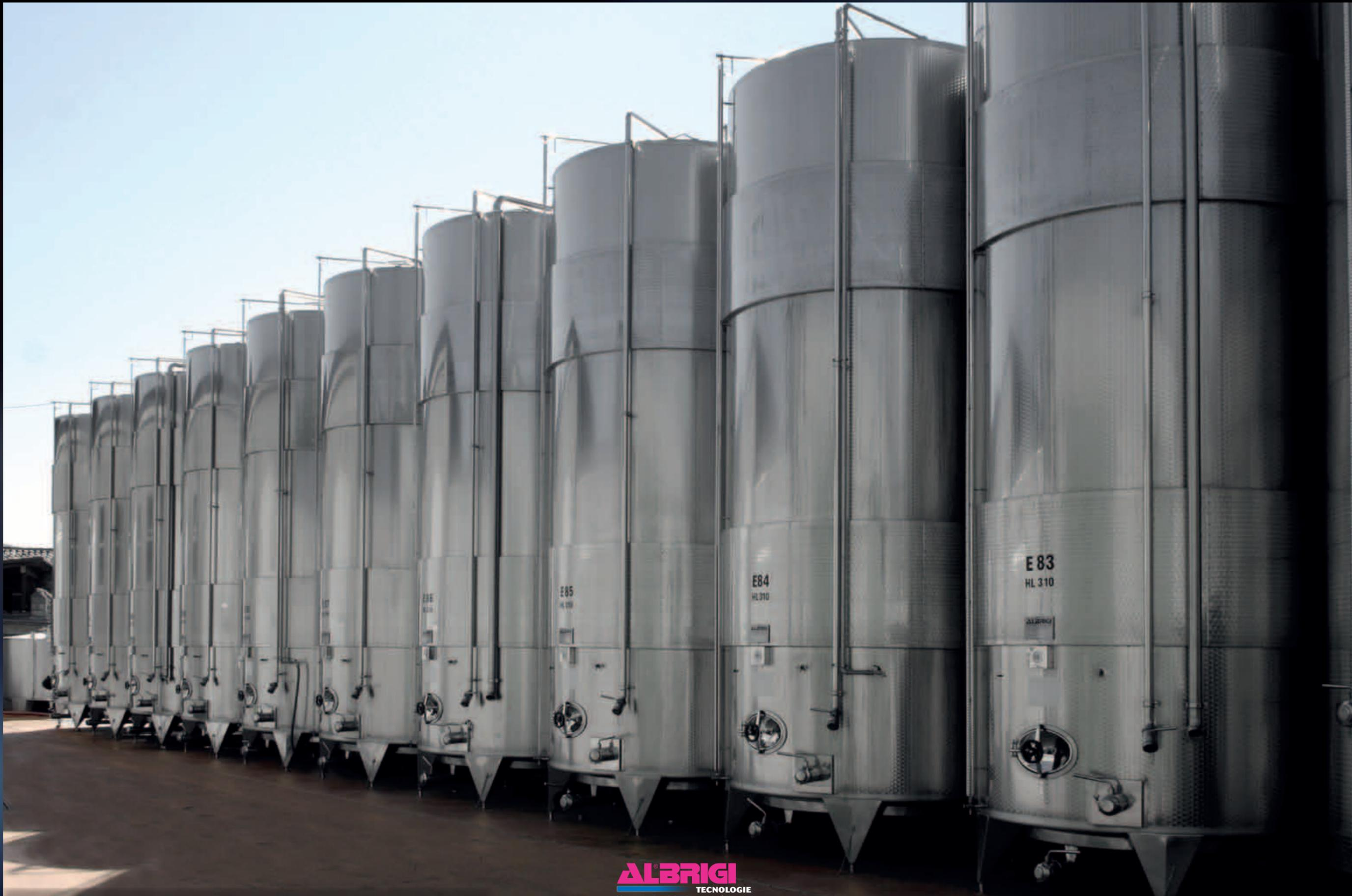
Batería de tanques Termotankdouble termocondicionados con Termostar y aislamiento en la camisa Isoplus y con sistema de lavado Cleanfix
