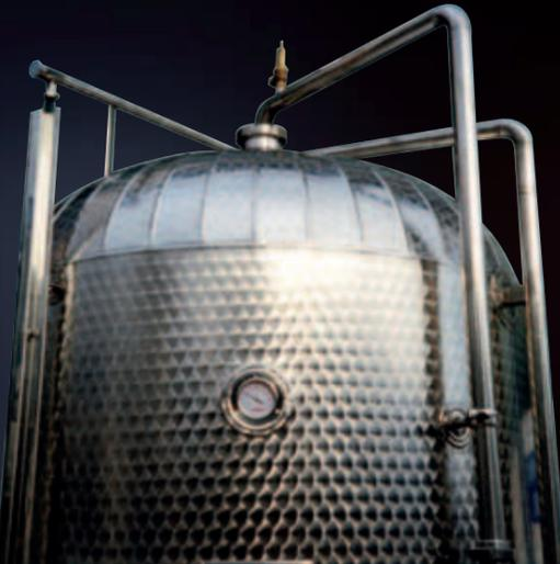
Vista desde arriba de un autoclave con accesorios para el lavado, tubo del grupo de seguridad y nivel aislado con Isotherm
