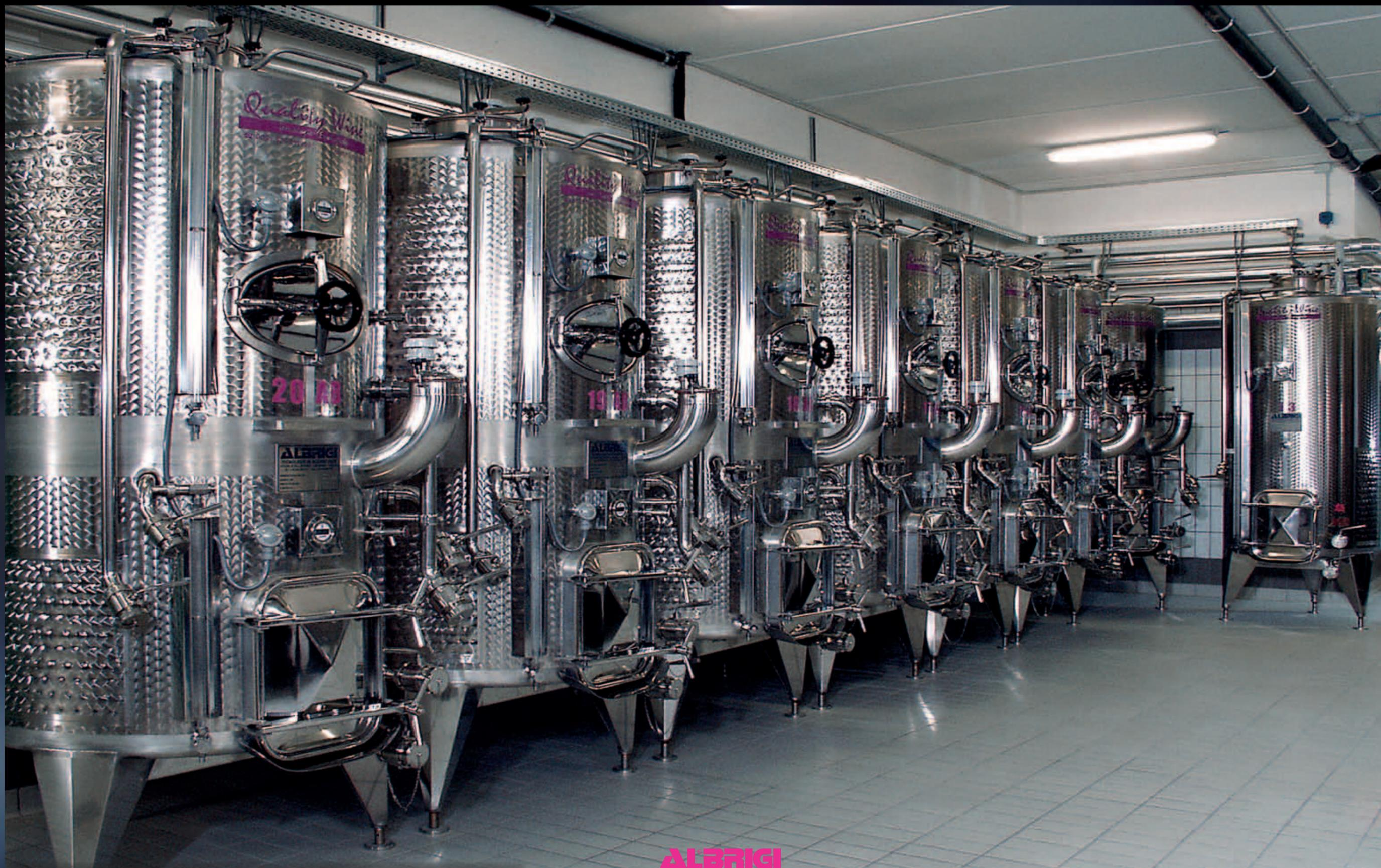
Tanques Politank Termo de 10 hl + 15 hl con compartimiento inferior para la fermentación y superior para el almacenamiento, todos termocondicionados con Termostar y equipados de sistema de lavado Cleanfix
