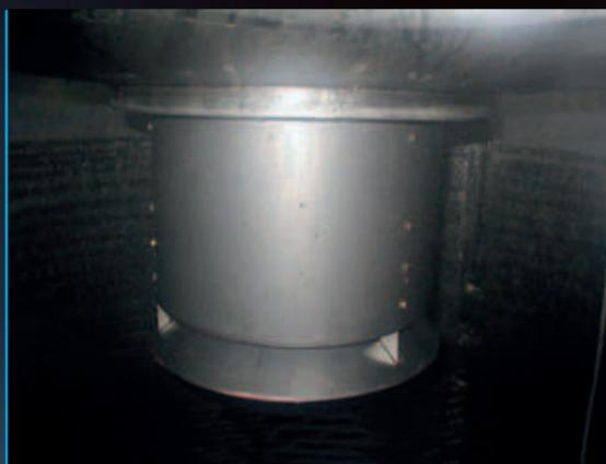
Vista desde abajo de la válvula de cascada con el encauzador cerrado
