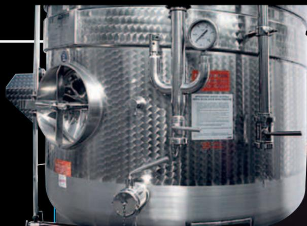
Grupo de seguridad con válvula calibrada PED
