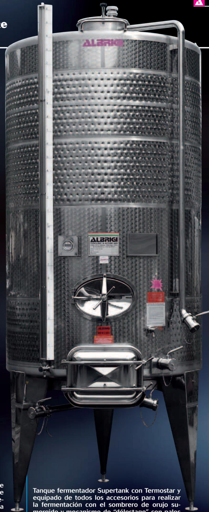
Tanque fermentador Supertank con Termostar y equipado de todos los accesorios para realizar la fermentación con el sombrero de orujo sumergido y mecanismo de "délestage" con palos rompe-sombrero
