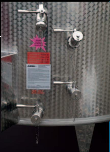
Grupo válvulas de un Frigotank con descarga total y parcial, remontado y válvula inclinada para agitador extraíble MOBILMIX
