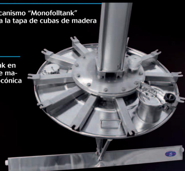
Vista de sistemas de refuerzo del cielo de acero y de madera en cubas de madera con mecanismo Monofolltank
