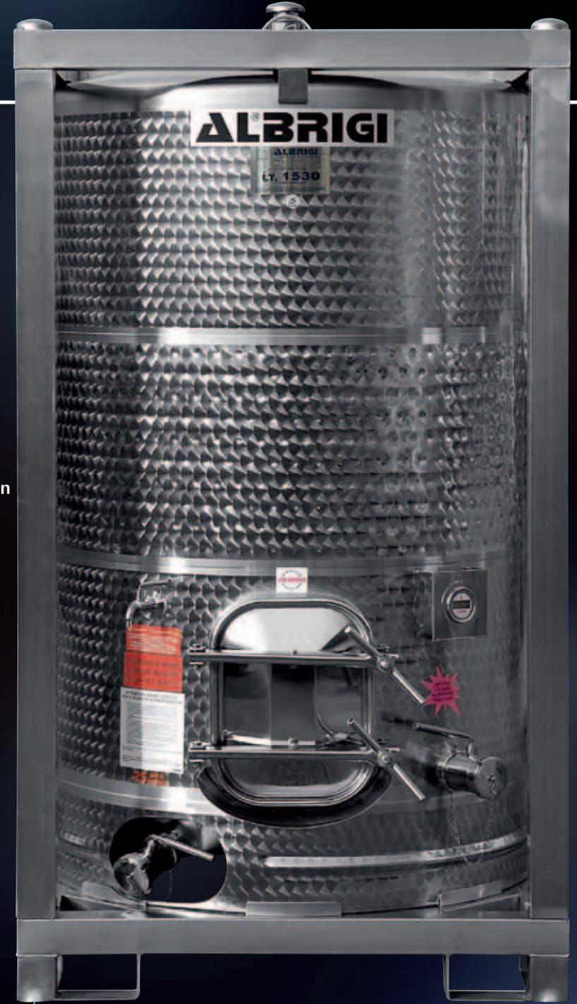
Tanque Enopalet de 1530 litros con puerta rectangular y camisa de acondicionamiento, termómetro, sonda de temperatura y 2 válvulas, ideal para microfermentaciones
