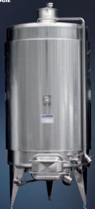
Tanque parcialmente aislado en el cilindro con aislamiento "Isofix"
