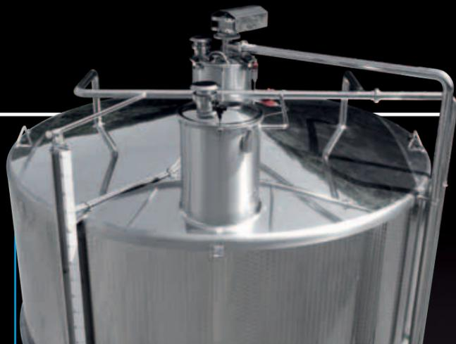
Cielo de fermentador con tapa doble, rociador "Motofly" motorizado y sistema de lavado "Cleanfix"
