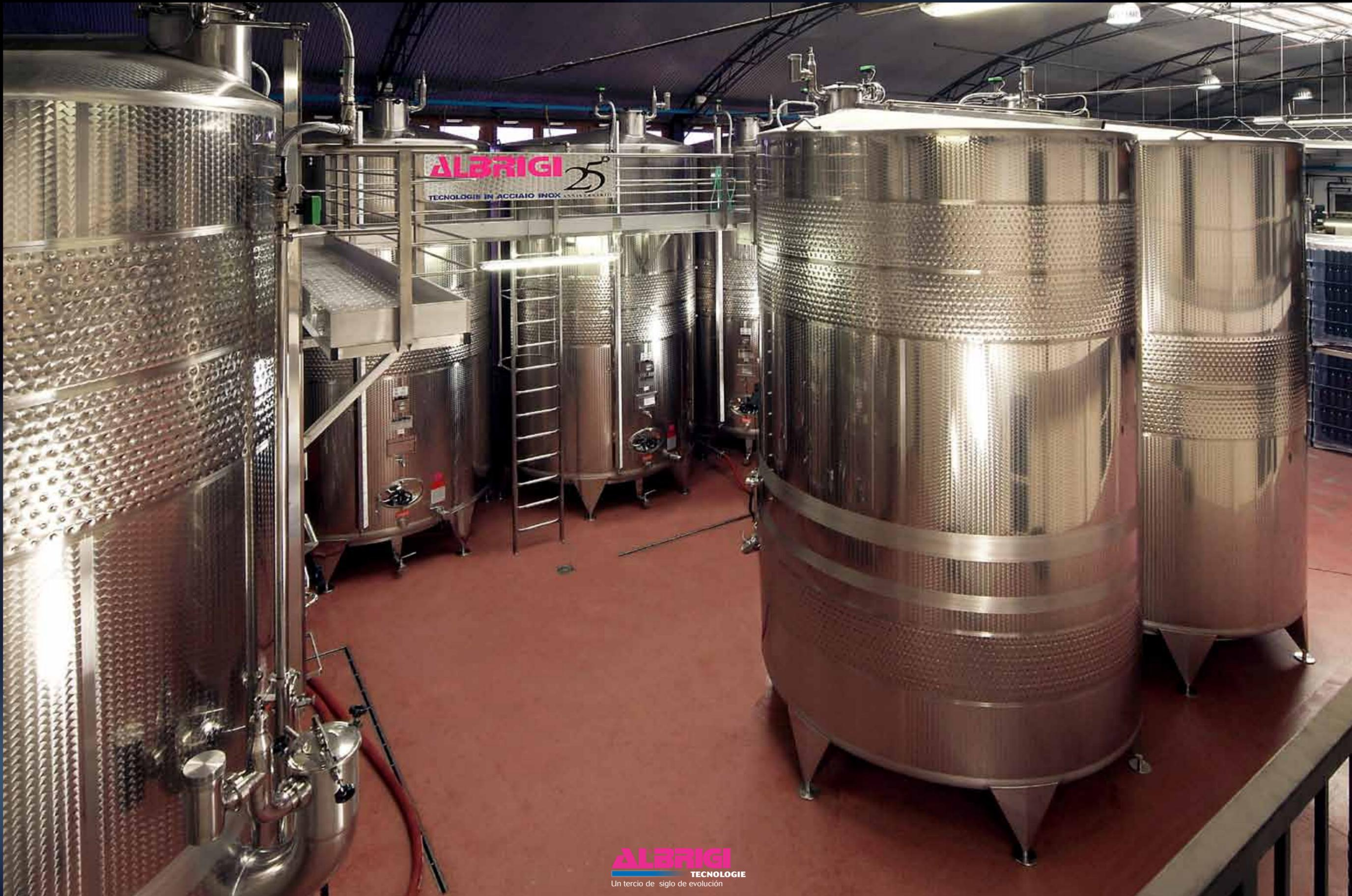
Tanques Termotank de 300 hl, Politank Termo de 150+150 hl y 200+100 hl, todos con Innergas, sistema de lavado Cleanfix y pasarelas de servicio
