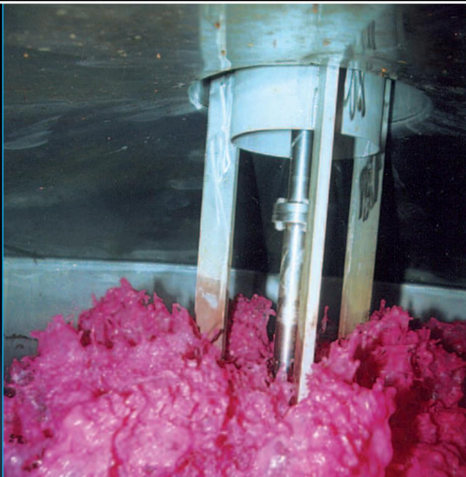
Turbotank funcionando en la fase de remontado del mosto
