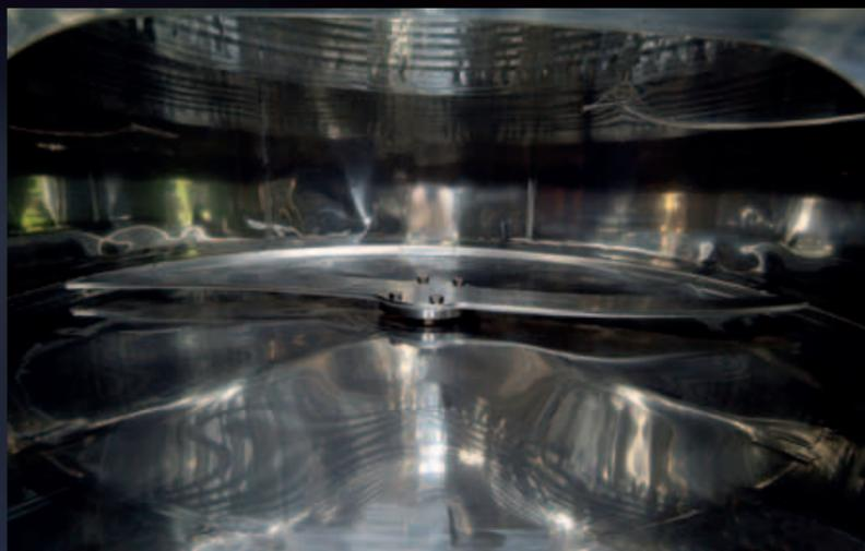
Mecanismo para sacar el orujo, en el fondo plano inclinado en un 3% hacia adelante
