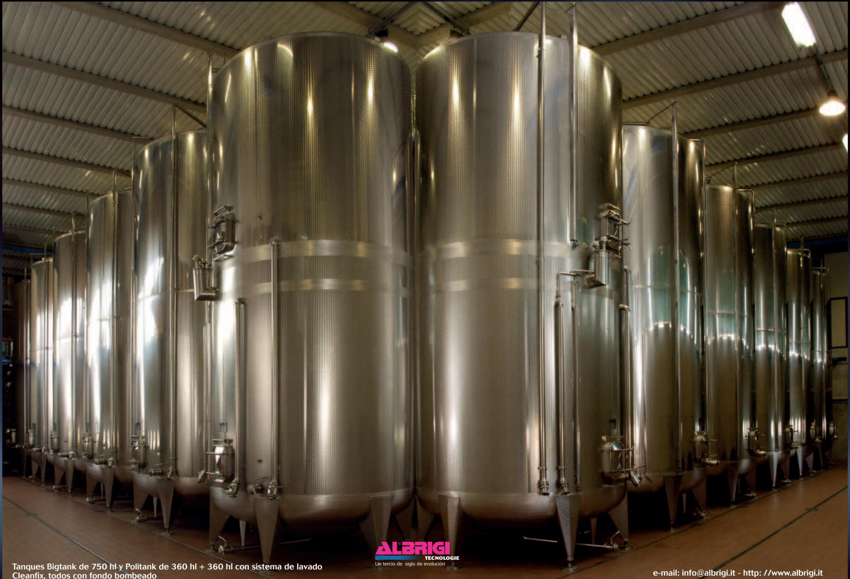
Tanques Bigtank de 750 hl y Politank de 360 hl + 360 hl con sistema de lavado Cleanfix, todos con fondo bombeado
