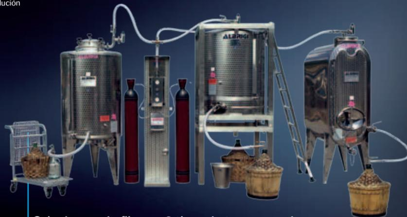
Caja de mando fija con 3 tipos de tanques a almacenar, a 20 mb de presión con nitrógeno para la venta de vino a granel
