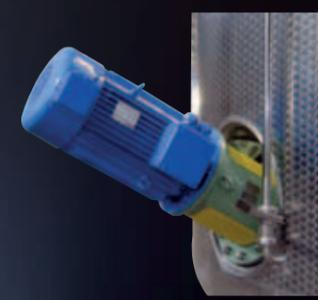
Agitador lateral "SIDEMIX" aplicable en la pared de cualquier tanque
