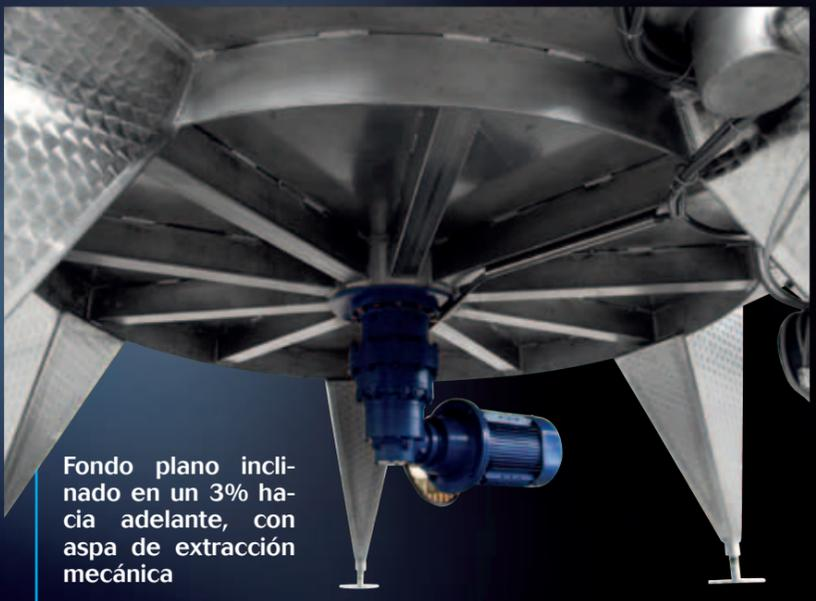
Fondo plano inclinado en un 3% hacia adelante, con aspa de extracción mecánica
