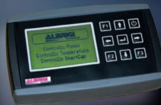
El ordenador de mano "MOBILCONTROL" sirve para controlar, a través de "ARCHIMEDE", todas las funciones a distancia y evita tener que trasladarse para controlar las diferentes operaciones y funciones.
