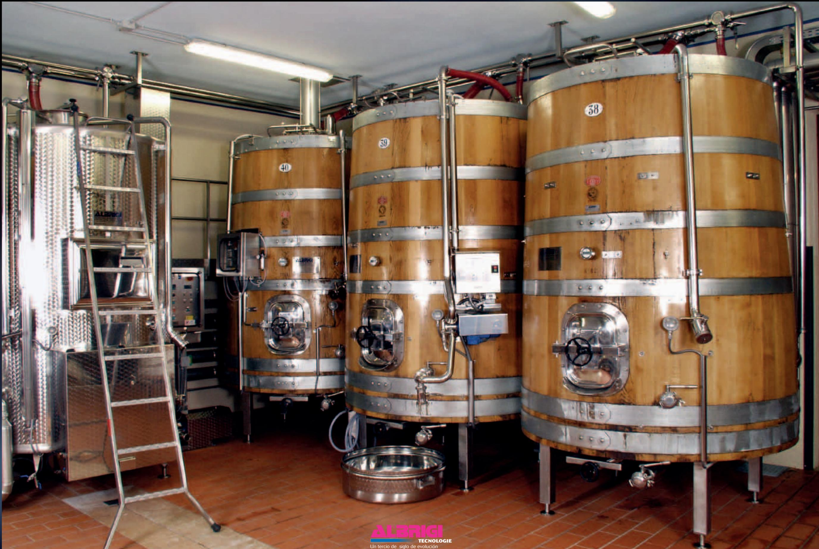
Criotank en acero inox y Monofoltank – Palitank / délestage – Supertank de roble
