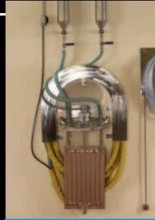
Placa móvil - termoplaca para la tapa del tanque Enopalet
