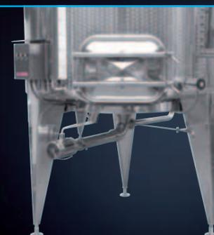
Mecanismo para recoger el CO<sub>2</sub> y encauzarlo otra vez hacia abajo, equipado de turbina "Turbofan"
