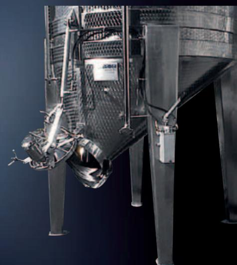
Vista lateral de Gravitank con puerta abierta y abertura hidráulica
