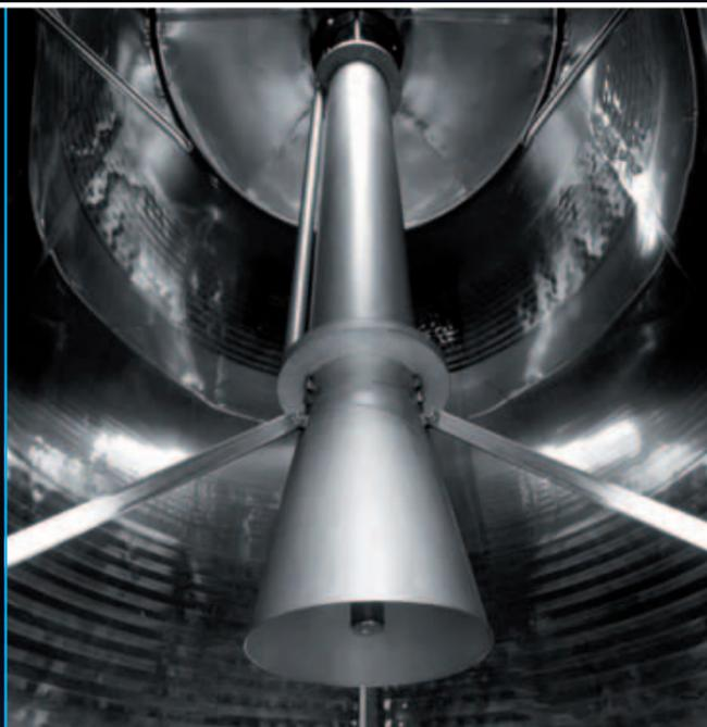
Turbotank "Termo", patentado por Albrigi, aplicado al interior de un fermentador de 600 hl
