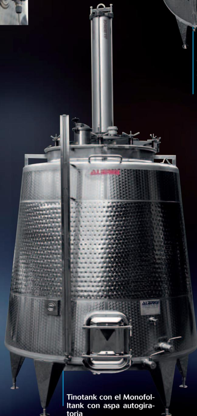
Tinotank con el Monofly-tank con aspa autogiratoria
