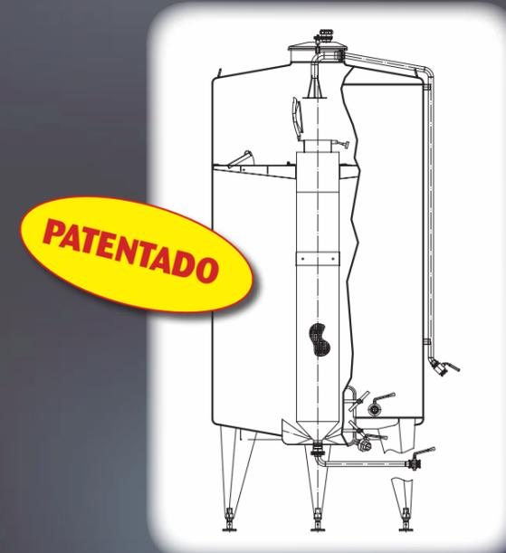
Diagrama general de la forma de colocar el mecanismo desmontable de sombrero sumergido, que puede aplicarse en cualquier fermentador existente.
