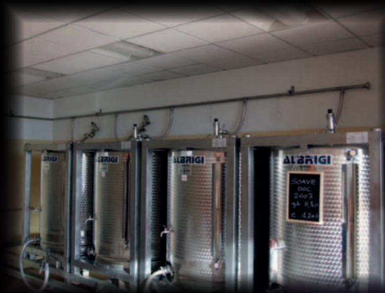
Sistema de almacenamiento para la venta de vino a granel con sistema de inertización por gas nitrógeno
