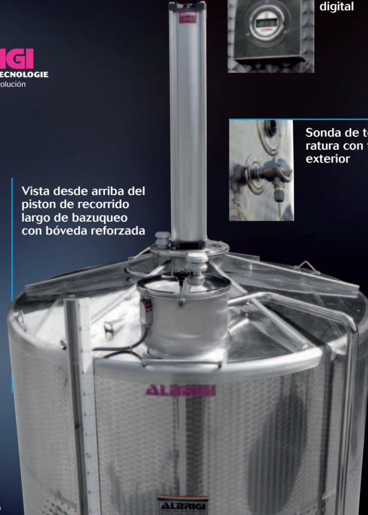
Mecanismo Monofolltank de recorrido largo a aplicarse en tanques nuevos o existentes, hasta en hormigón
