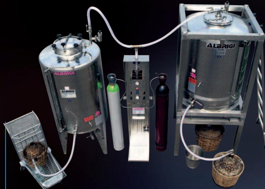
Tanque Enopalet de 1000 litros aislado con caja de mando para nitrógeno y Minitank de la serie "S" de 1000 litros
