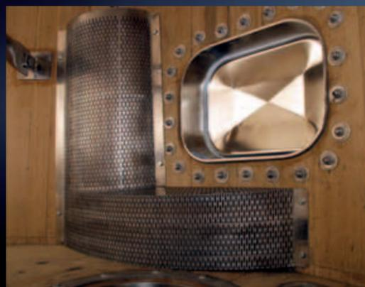
Rejillas de drenaje aplicadas sobre cubas de madera en la válvula de descarga total
