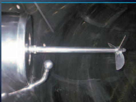
Bola de lavado "Sprayball" para limpiar el agitador y el empaque mecánico
