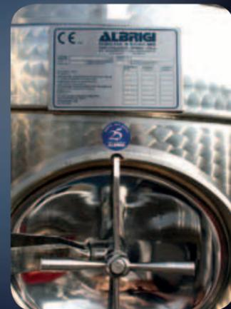
Placa en acero inox de certificación del ensayo PED
