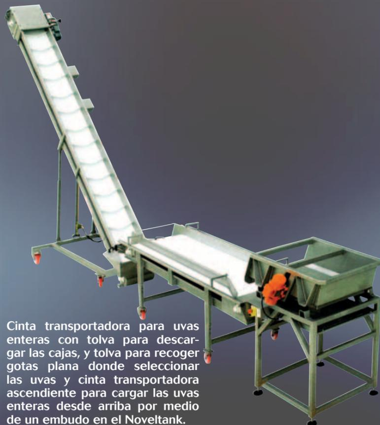
Cinta transportadora para uvas enteras con tolva para descargar las cajas, y tolva para recoger gotas plana donde seleccionar las uvas y cinta transportadora ascendente para cargar las uvas enteras desde arriba por medio de un embudo en el Noveltank.
