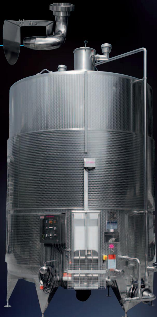
Fermentador Meccanotank de 300 hl con fondo plano inclinado, aspa de extracción, bomba de remontado y Palitank
