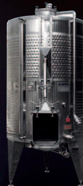
Criotank de 50 hl con 2 camisas Termotank y mecanismo de abertura de la puerta
