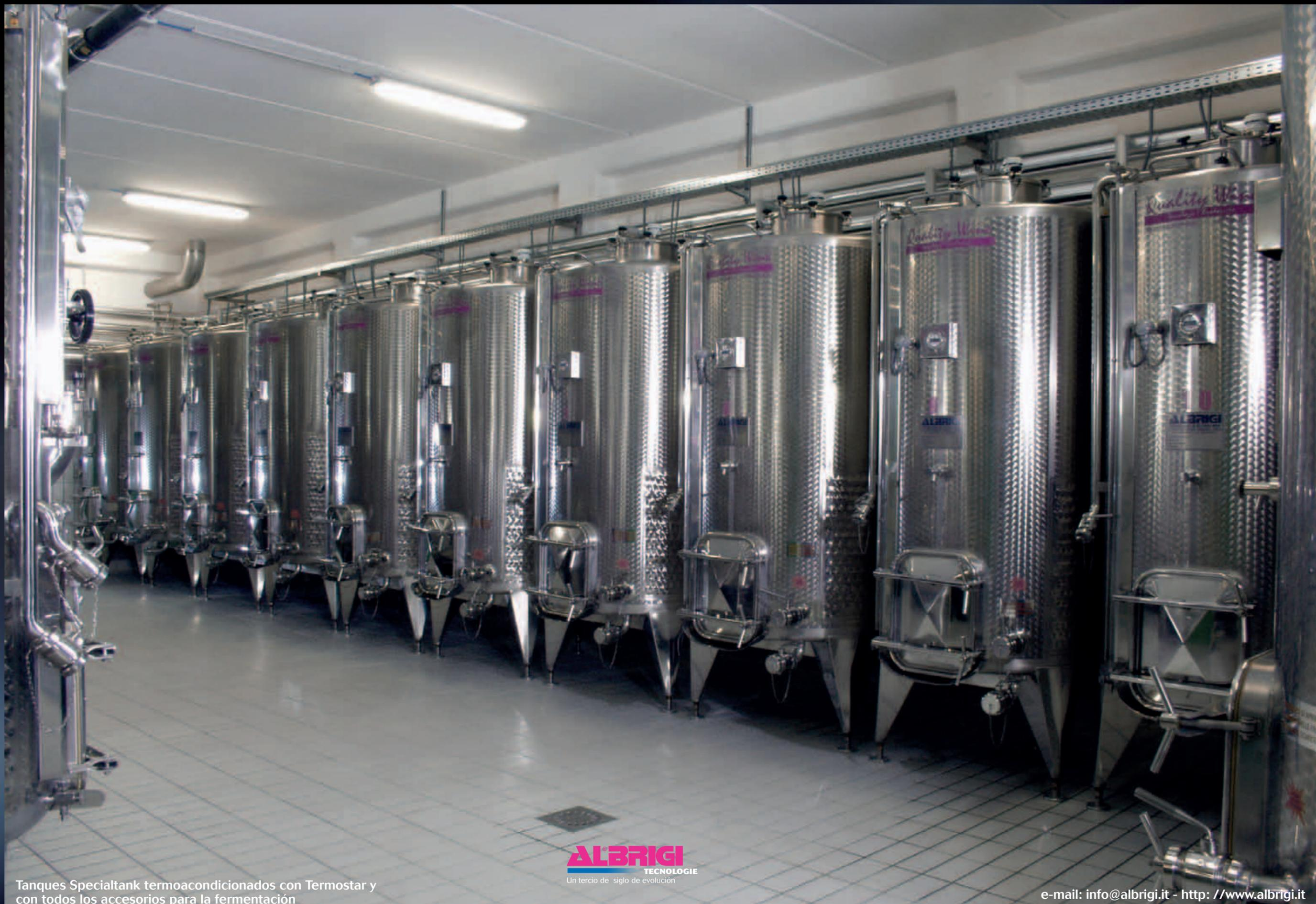
Tanques Specialtank termocondicionados con Termostar y con todos los accesorios para la fermentación
