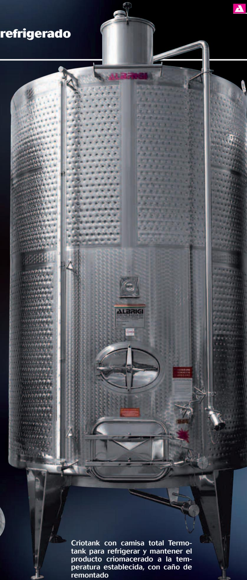
Criotank con camisa total Termo-tank para refrigerar y mantener el producto criomacerado a la temperatura establecida, con caño de remontado
