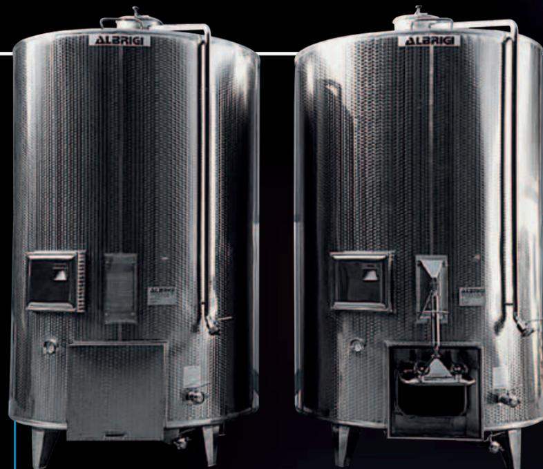
Criomaceradores termocondicionados con Termostar y aislados con Isotank, provistos del mecanismo estático interior de separación del orujo
