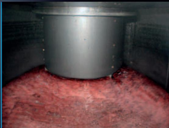
Válvula de cascada abierta con el flujo de mosto en caída
