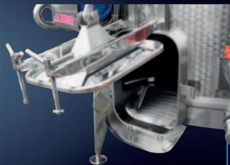
Puerta rectangular abierta con deslizadero facilitado para la descarga
