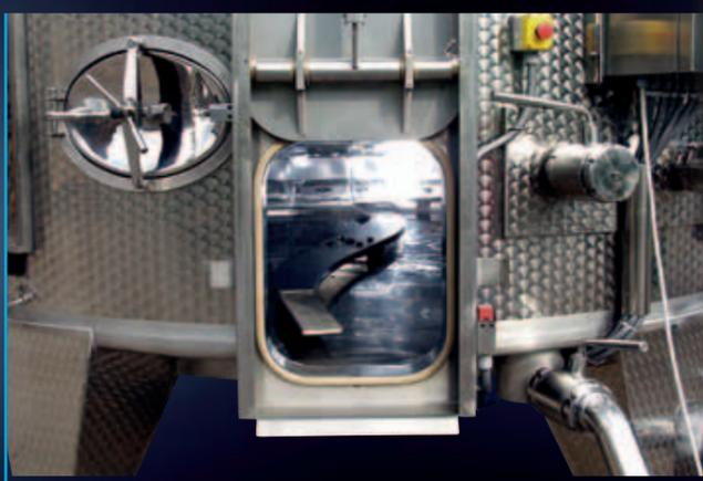
Puerta con abertura de guillotina y mecanismo de descarga mecánica del orujo "Meccanotank"
