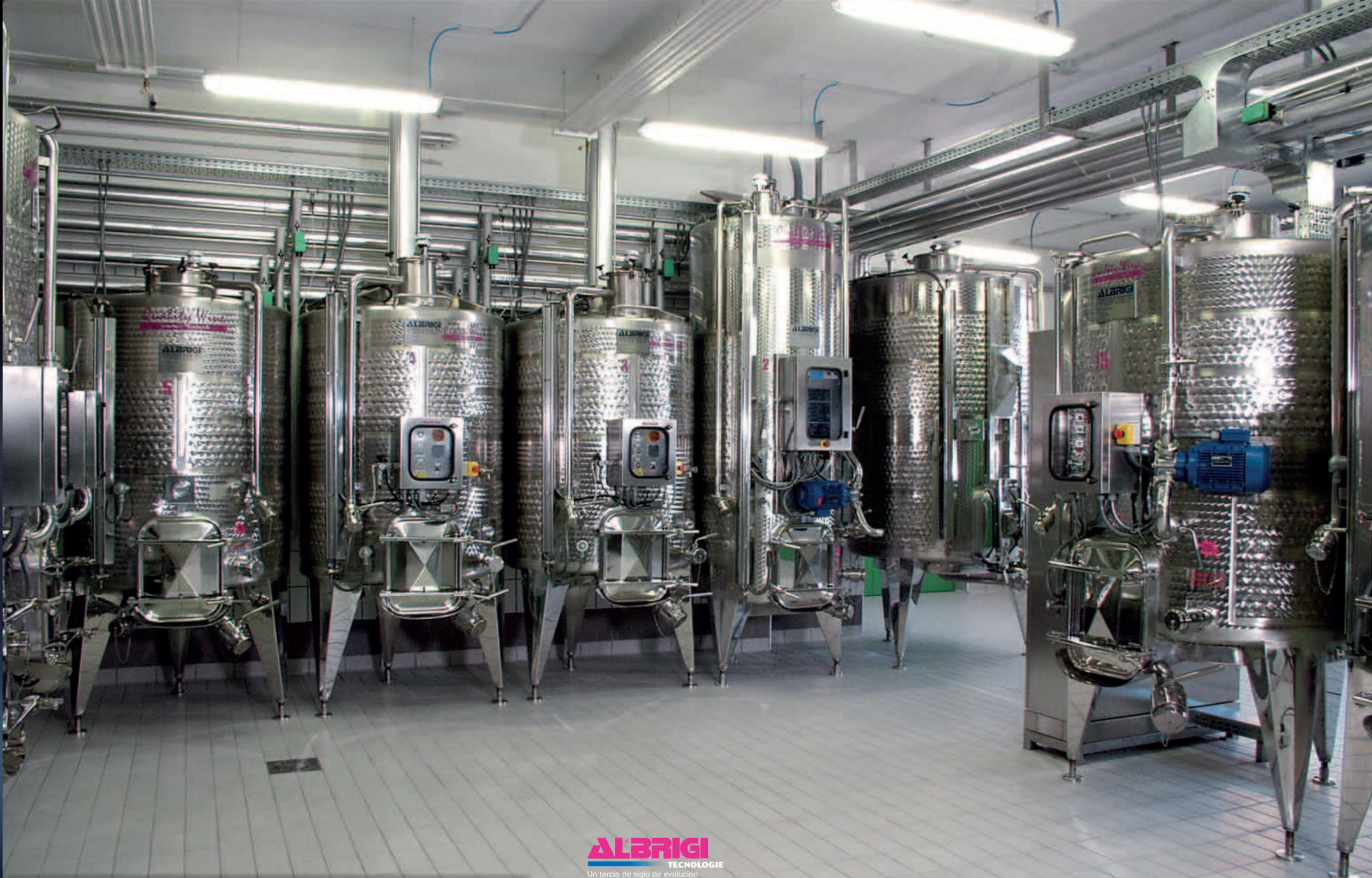
Serie de fermentadores – “Délestage” – Monofol tank – Supertank – Pluviatank, todos termocondicionados con Termostar y equipados de todos los accesorios
