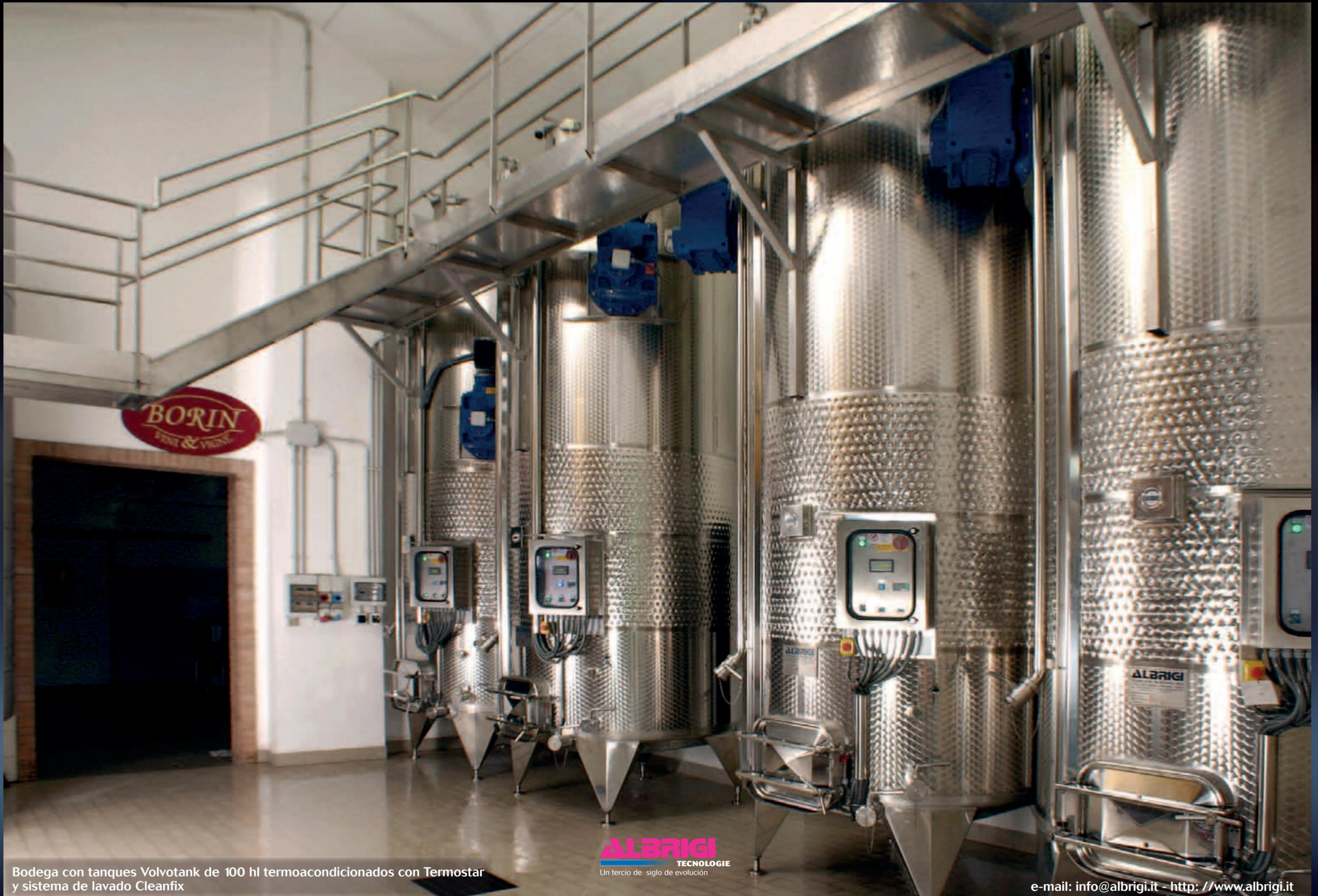
Bodega con tanques Volvotank de 100 hl termocondicionados con Termostar y sistema de lavado Cleanfix
