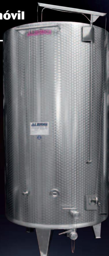
Variotank aislado con Isotank y termocondicionado con Termostar para estabilizar los vinos
