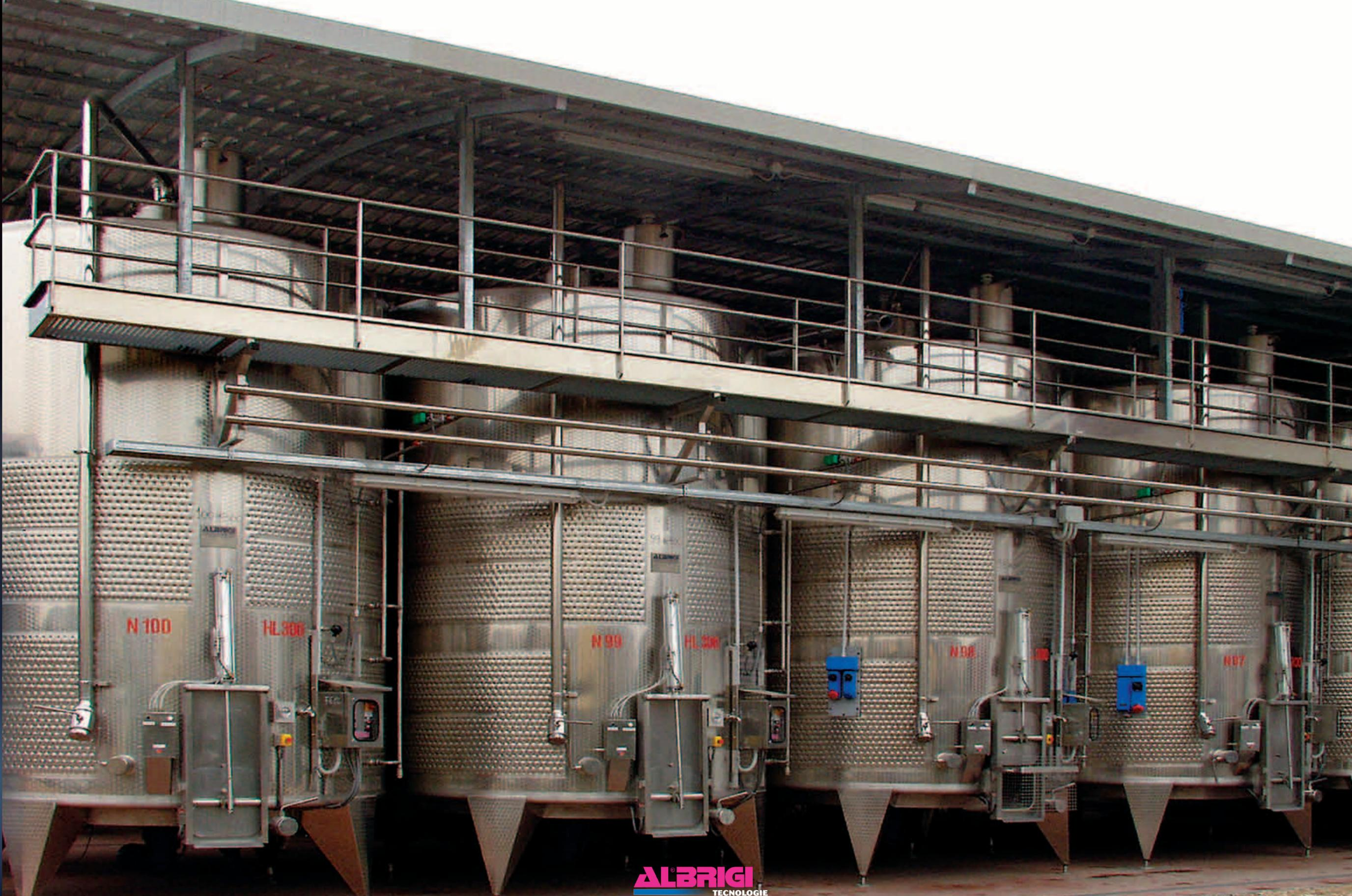
Fermentadores Meccanotank de 300 hl termocondicionados con Termostar double y Palitank para "délestage"
