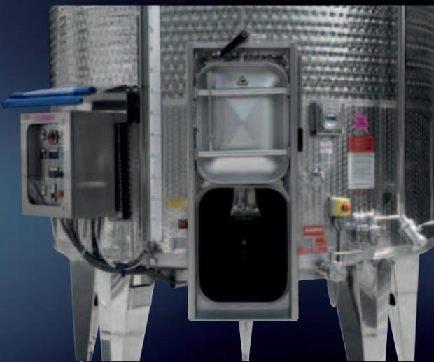
Puerta de guillotina abierta con aspa de extracción del orujo
