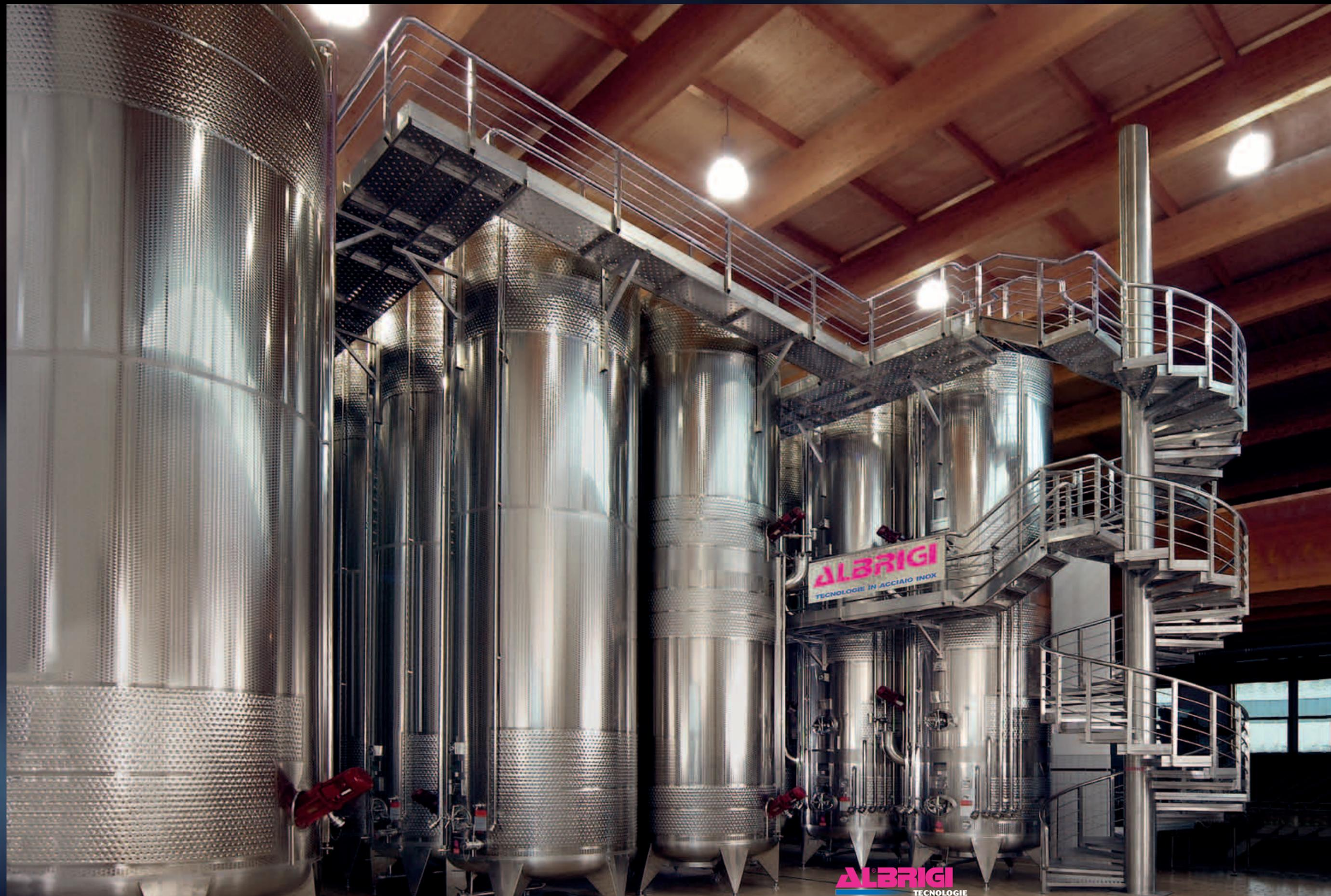
Bodega de almacenamiento equipada de tanques Bigtank Termo de 600 hl y 300 hl y Politank Termo de 150+150 hl, 200+100 hl y 50+50+100 hl, todos termocondicionados con Termostar, sistemas de lavado Cleanfix y sistemas Innergas
