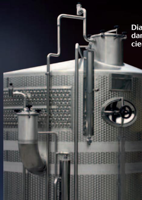
INNERPIPE Diagrama de sistema fijo para mandar desde el suelo la abertura y el cierre del sistema de nitrógeno
