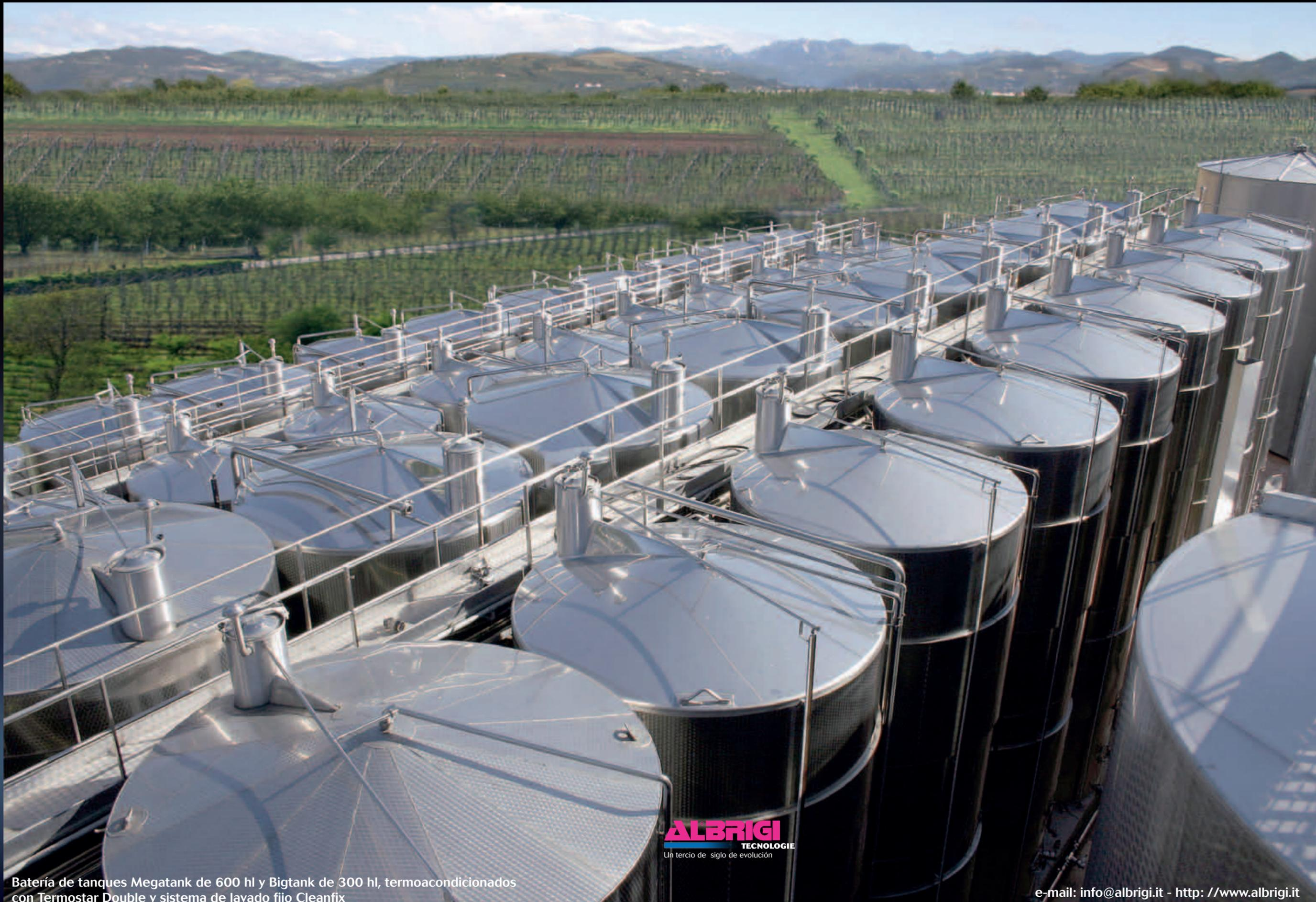
Batería de tanques Megatank de 600 hl y Bigtank de 300 hl, termocondicionados con Termostar Double y sistema de lavado fijo Cleanfix
