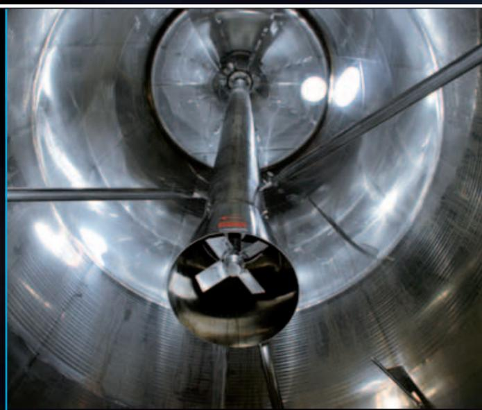
Turbotank aplicado al interior de un fermentador de 1000 hl
