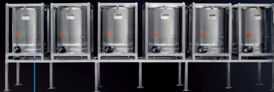
Batería de tanques paletizables de 10 hl, levantados, para la venta de vinos a granel, con sistema de nitrógeno
