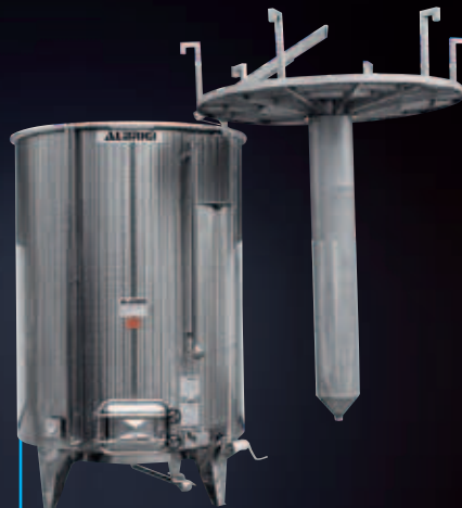
Variotank mit Supertank-Mechanismus zum Eintauchen des Tresterhuts
