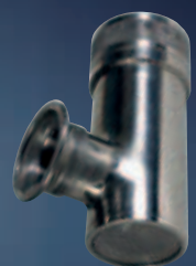
Edelstahlventil mit Zweifachwirkung ø 40 - 50 - 60 - 80 mm, abmontierbar, mit 2 Gewichtstellern für Über- und Unterdruck mit O-Ring-Dichtungen aus Viton und Antihafteflon
