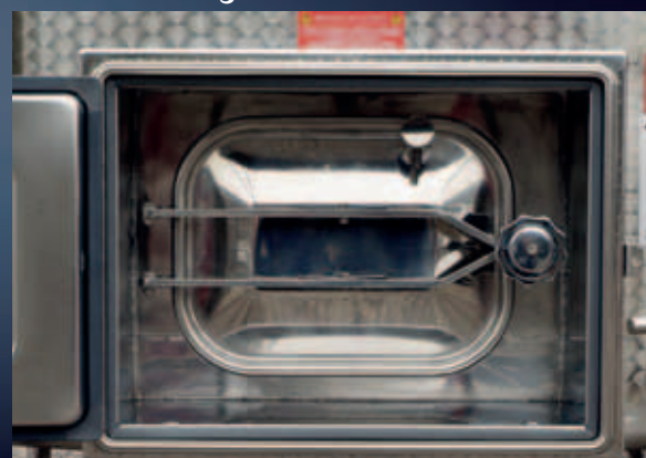
Rechteckige Luke 530x420 mm mit isolierter Gegenluke und Probenentnahmeverrichtung
