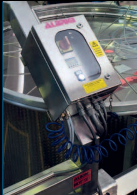
Elektropneumatische Schalttafel für manuellen/automatischen Auf-/Abstieg
