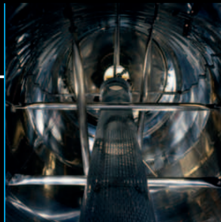
Palitank-Mechanismus mit mittigem Drainagegitter
