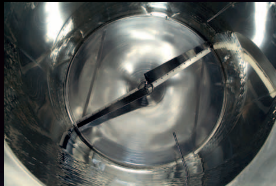
Ansicht der am Boden drehenden patentierten Schaufel
