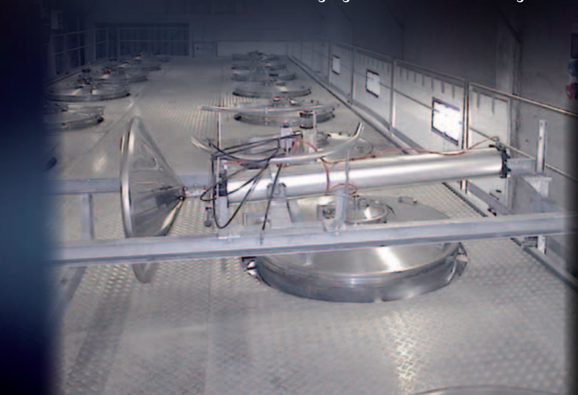
Unterstoßmechanismus mit auf Doppelschiene gleitendem Brückenbalken mit Pigeage-Einzelfuß in Ruhestellung
