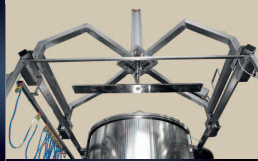
Ansicht der selbstdrehenden, patentierten Schaufel
