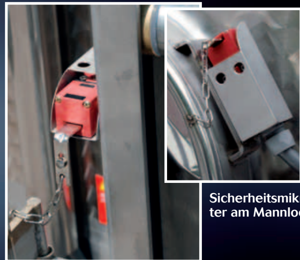
Sicherheitsmikroschalter an der Luke
