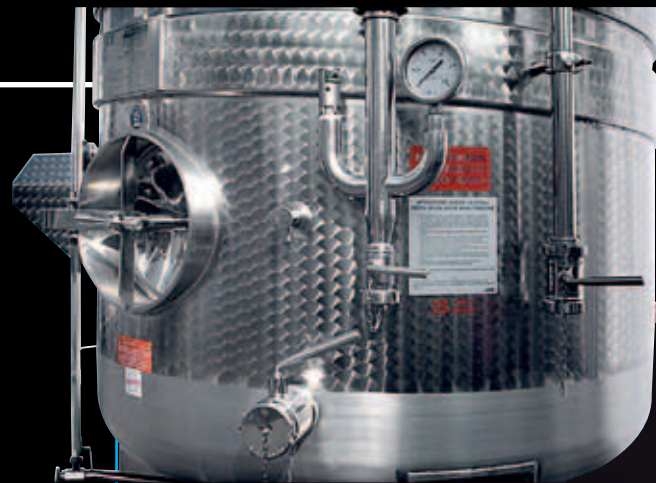
Sicherheitsaggregat mit Ventileinstellung laut PED-Richtlinie
