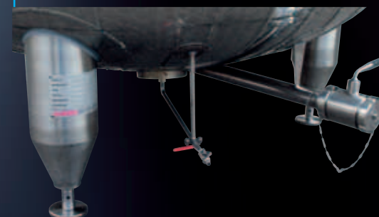
CO2-Einspritzvorrichtung mit überbrückbarem Rückschlagventil aus Edelstahl
