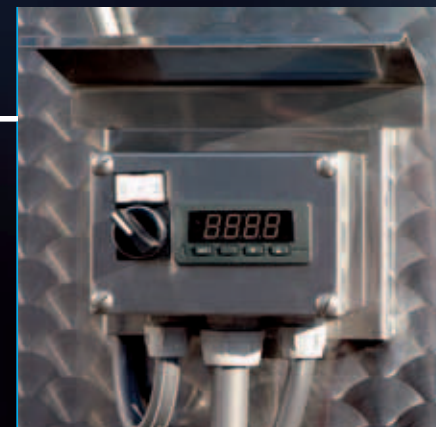
Digitalthermostat mit Schutzdach
