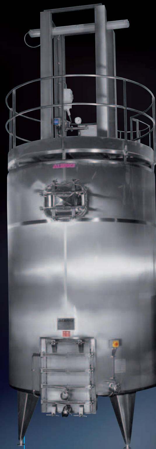
Hydraulischer Unterstoßtank mit 4 Pigeage-Füßen in selbstreinigender Spezialausführung mit SPS zur Steuerung der abwechselnden Unterstoßphasen
