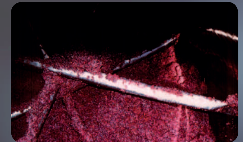
Ansicht des sich teilenden Tresterhuts beim Abstieg unter das Palitank-Gestänge
