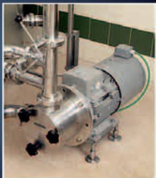
Pumpe aus nichtrostendem Stahl mit niedriger Drehzahl
