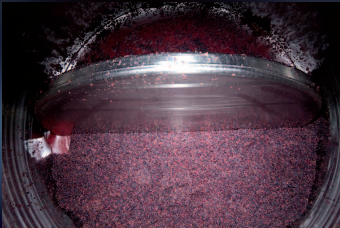
Von Albrigi patentierte senkrechte Drehschaufel mit getrocknetem Trester, in Pausenphase
