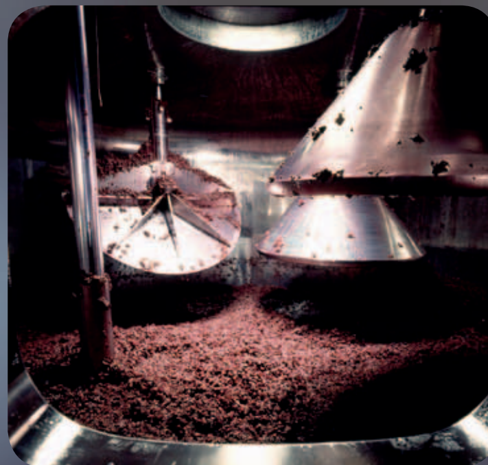
Innenansicht während des Unterstoßens mit 4 pneumatischen Pigeage-Füßen
