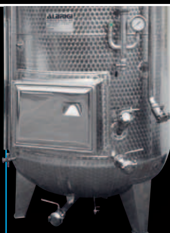
Frigotank mit Ventilreihe für Voll- und Teilabfluss für entnehmbaren Mobilmix-Rührer und CO 2 -Einspritzer von unten
