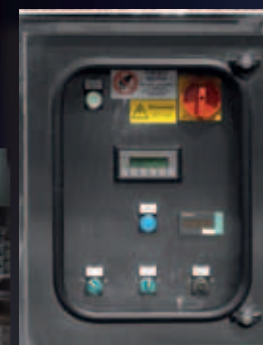
Bedienfeld zur Steuerung der Temperatur und der automatischen Remontage-Abläufe
