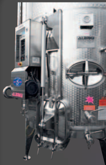
Füllpumpe des oberen Bereichs mit Sauerstoffanreicherungs-gerät und Schalttafel
