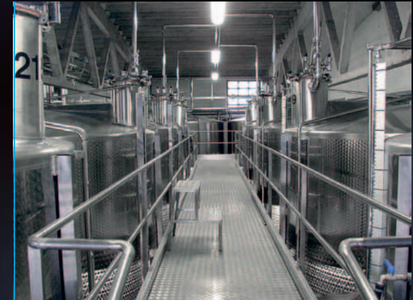
Laufgang mit Tanks 300 hl mit Sicherheitsaggregat und ortsfester Edelstahlrohranlage „Innerpipe“
