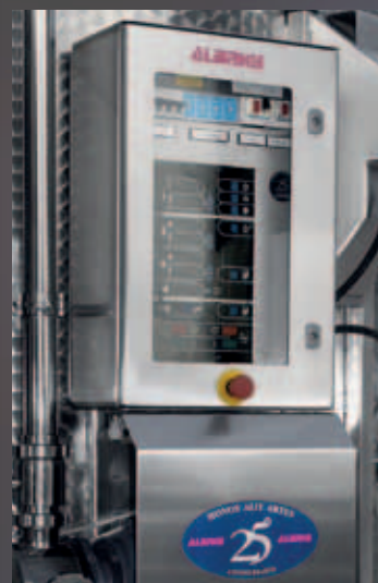
Füllpumpe des oberen Bereichs mit Sauerstoffanreicherungs-gerät und Schalttafel
