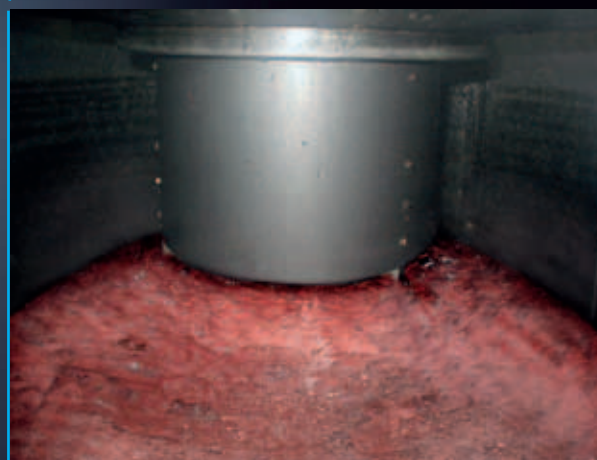
Geöffnetes Überspülventil mit herabfließendem Most
