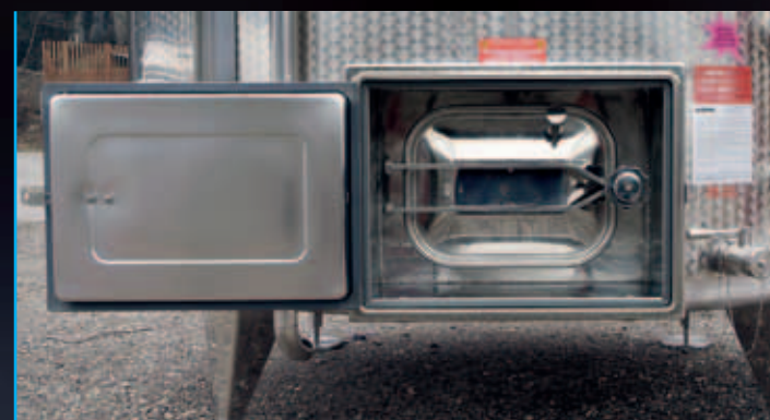
Rechteckige Luke und isolierte Gegenluke mit Kondenswasserabfluss
