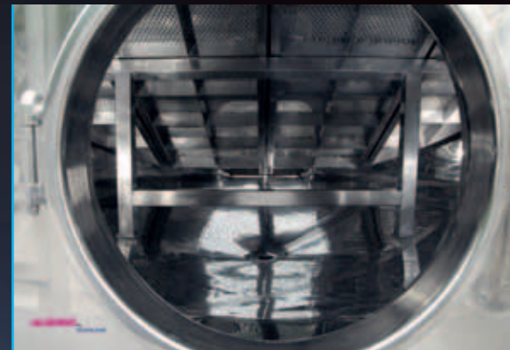
Innenansicht der Unterseite des Abtropfgitters durch die untere Luke
