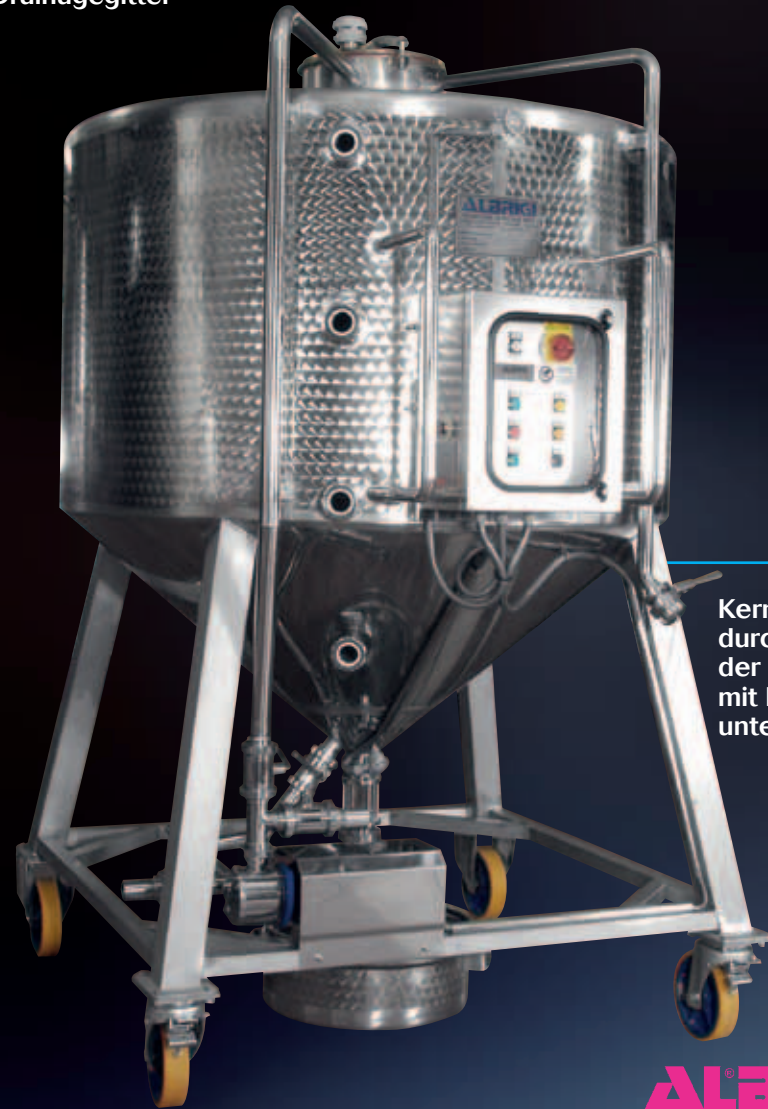
Palitank-Mechanismus mit mittigem Drainagegitter
