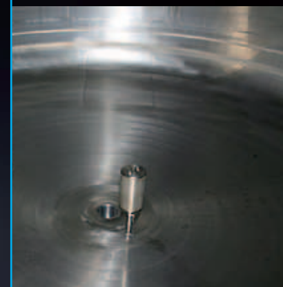
Temperaturfühler mit externer Halterung
