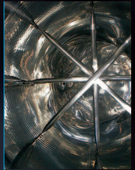
Palitank-Gestänge für das Délestage-Verfahren und zur Teilung des Tresterhuts während der Gärphase, aber auch sehr nützlich für den Abfluss der Maische bei Gärungsende
