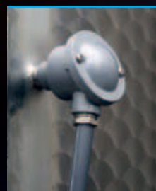
Fühlerhalter zur Temperaturkontrolle
