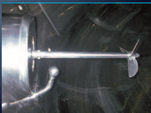
„Sprayball“-Reinigungskugel zur Reinigung des Rührers und der mechanischen Dichtung
