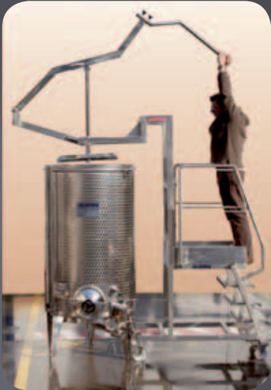
Mit dem von Albrigi patentierten, manuellen Mechanismus wird das Unterstoßen zum Kinderspiel
