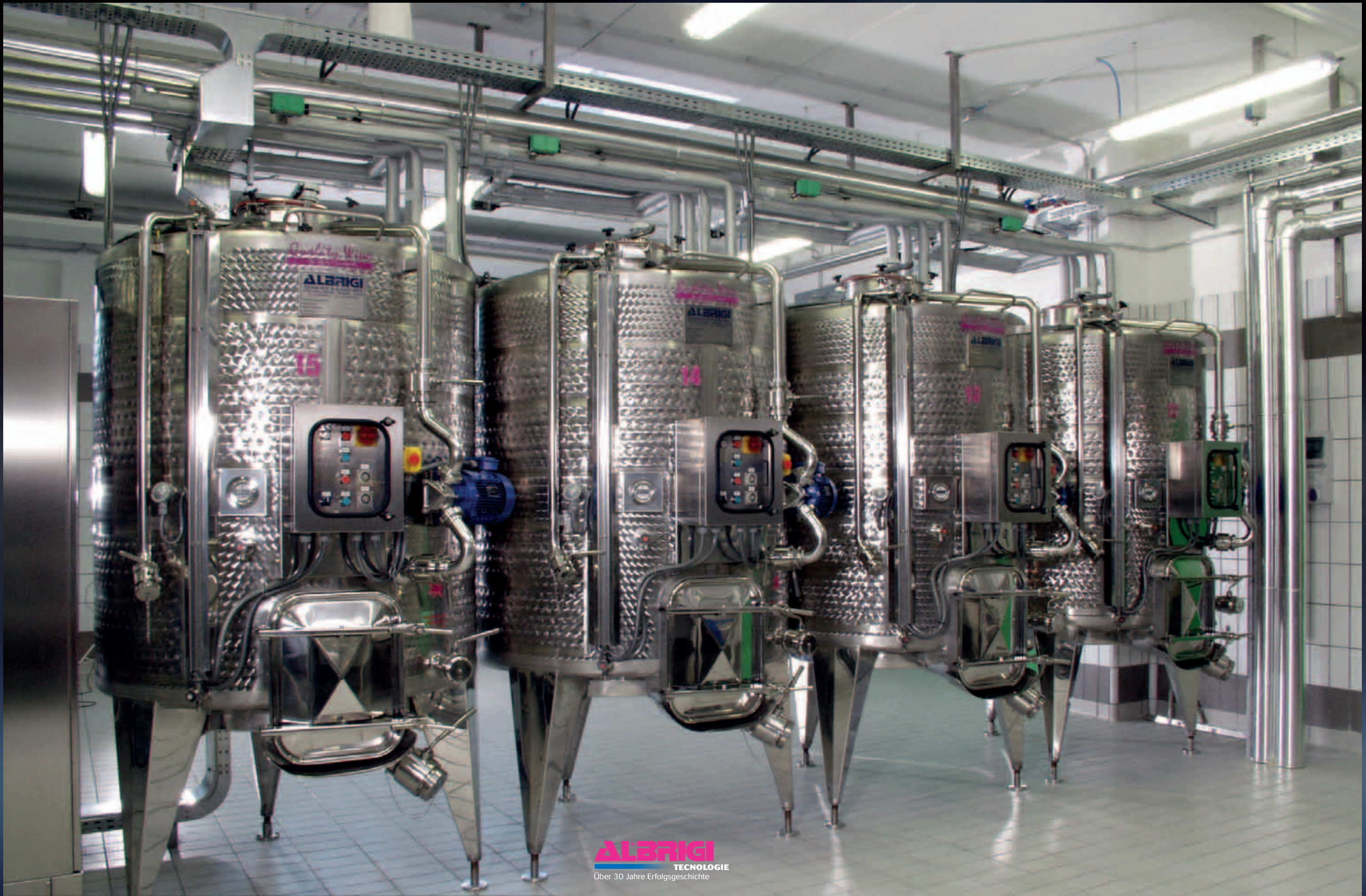
Specialtank-Weinbereitungsgeräte 25 hl und 20 hl, Termostar-Temperatursteuerung mit Délestage und Remontage-Pumpe
