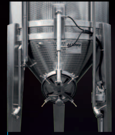
Gravitank mit geschlossener, abgesperrter Luke
