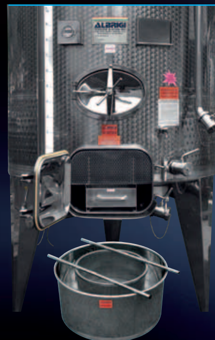
Ansicht der unteren Luke zum Maischeabfluss mit Mechanismus zum Trennen des Mostes von den Schalen
