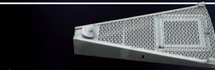
Vom Pigeage-Gitter abmontiertes Element mit Maischeeinfüllluke
