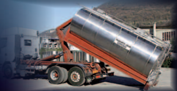
Droptank Abrollbarer, isolierter Tank mit 15.000 l Fassungsvermögen für Lebensmittel
