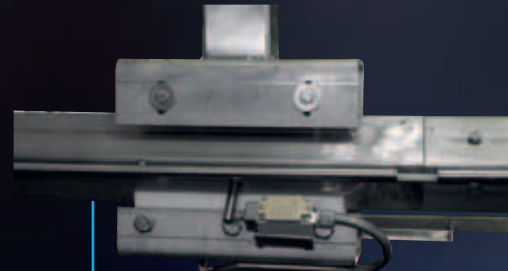
Ansicht des Blockiersystems mit normgerechter Sicherheitsvorrichtung
