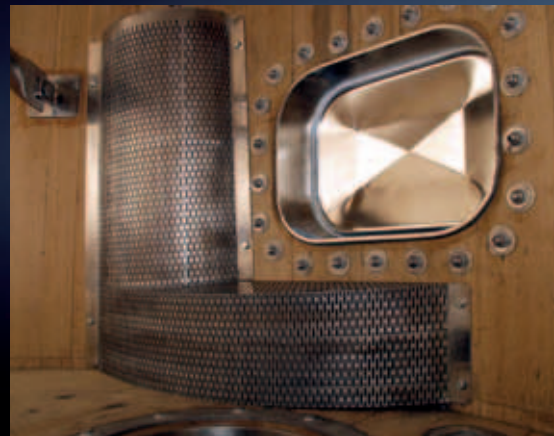
Drainagegitter, in Holzfässern am Komplettabflussventil montiert
