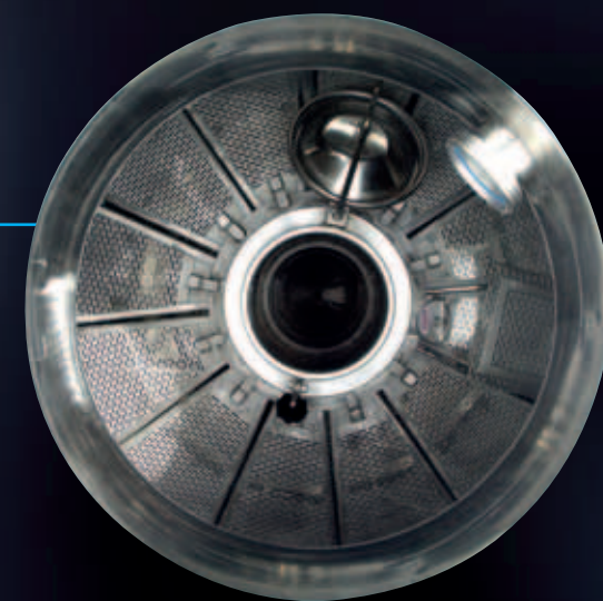
Bei geöffneter Luke läuft die natürliche Most-Remontage ab, bei geschlossener Luke der Zwangsumlauf mit Pumpe und Remontage-Rohr
