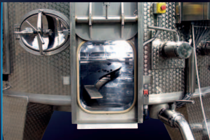
Schiebeluke mit mechanischem Maischeabflussmechanismus „Meccanotank“
