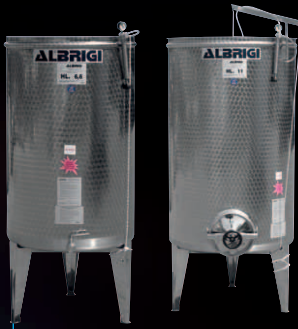
Mini-Schwimmdeckeltanks, 290-535-660-1.100-1.470 l, mit Öl- und Luftschwimmer, Luke ø 300 und beweglichen Standfüßen
