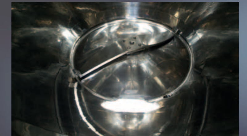
Innenansicht der Entnahmeschafel mit Hochglanzoberfläche
