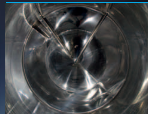
Ansicht von unten des patentierten Albrigi Superbottom-Bodens mit Entlüftungskanälen am Mannloch
