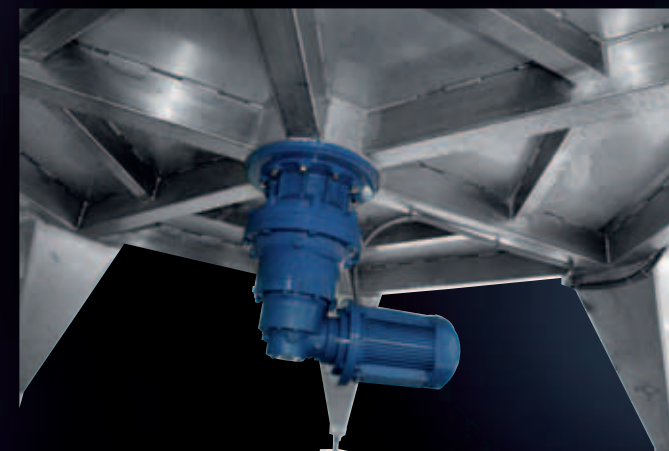
Meccanotank-Gärtank 600 hl mit geradem, schrägem Boden, Entnahmeschaufel, Remontage-Pumpe und Palitank-Gestänge
