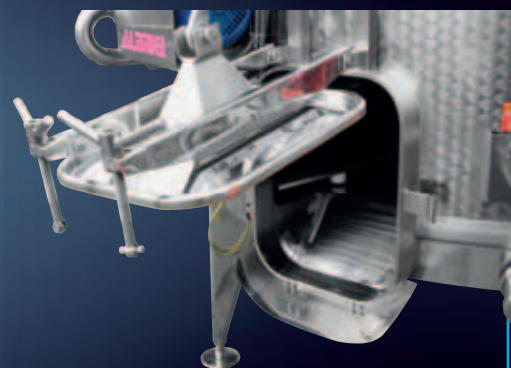
Rechteckige Luke, geöffnet, mit praktischer Abflusssrutsche
