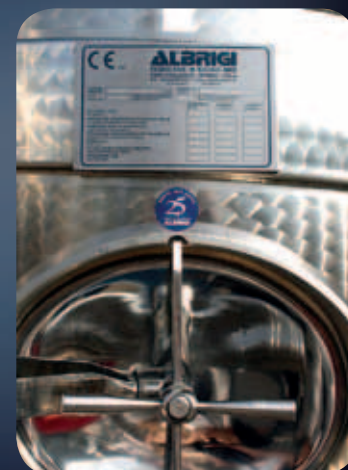
Edelstahlschild mit Bescheinigung der Abnahme nach PED
