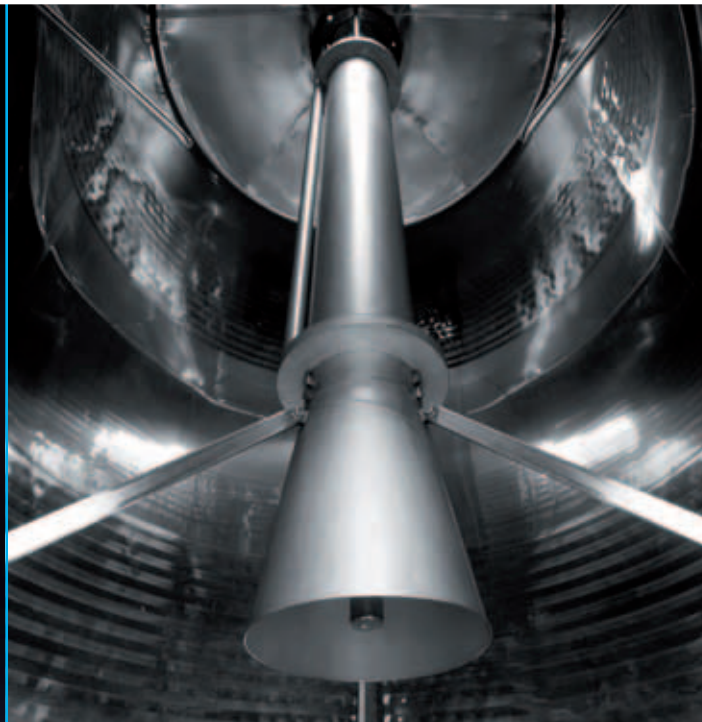
Von Albrigi patentierter Turbo-tank „Termo“ im Inneren eines Gärtanks mit 600 hl Fassungsvermögen
