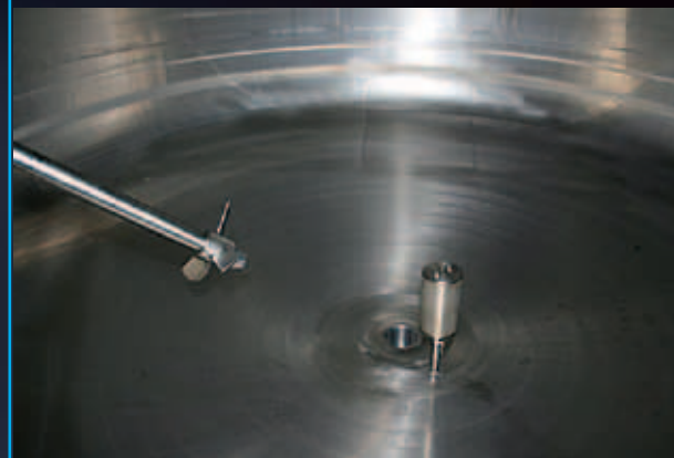
Poröses Element aus Edelstahl Aisi 316L, gesintert, zur Moussierung
