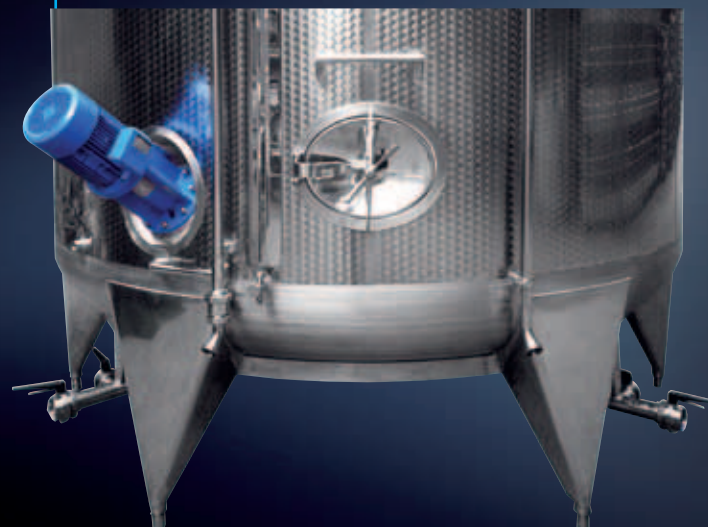
Ortsfeste Cleanfix-Reinigungsanlage zur internen Reinigung des seitlichen Sidemix-Rührers
