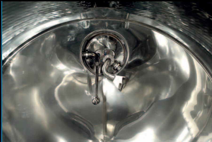
Innenansicht der selbstdrehenden Mostrieselanlage und Reinigungskugel
