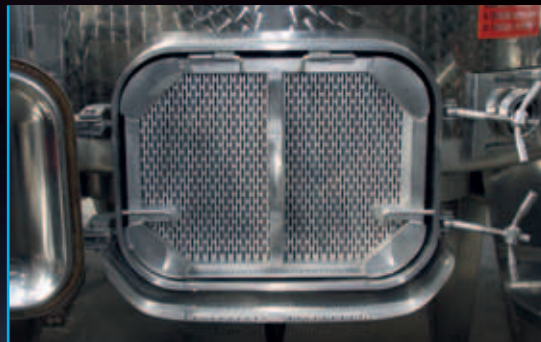
Bewegliches Gitter an rechteckiger Luke, 530x420 mm, bündig mit dem Boden
