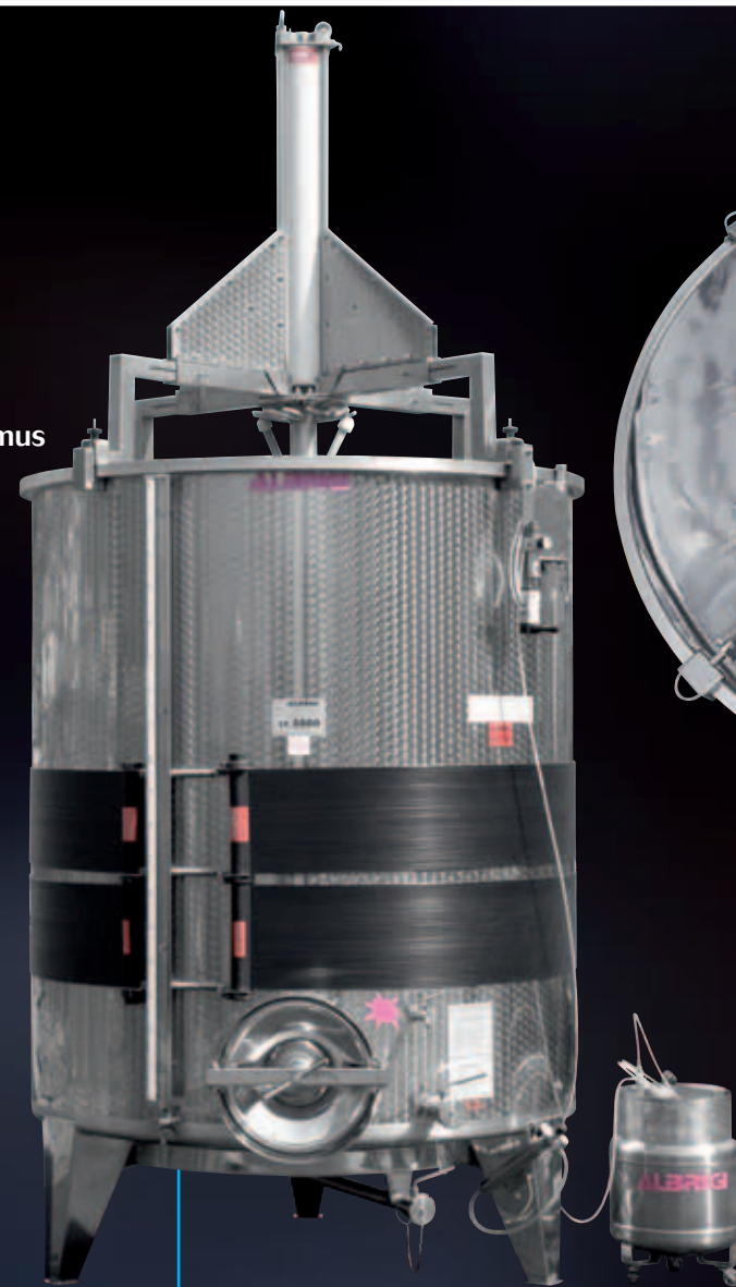
Außen- und Innenansicht des Unterstoßmechanismus Variofolltank an Schwimmdeckeltank mit 50 hl Fassungsvermögen
