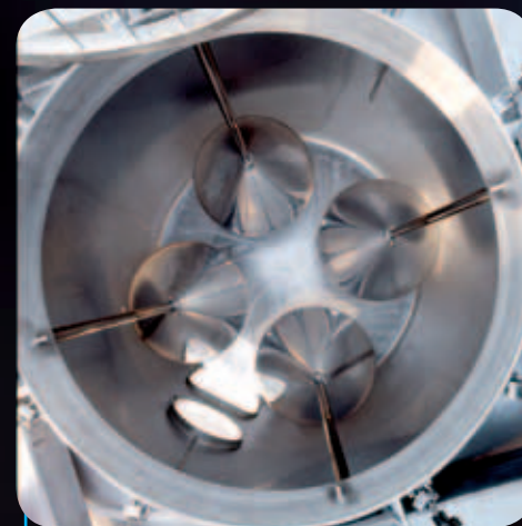
Ansicht von oben des selbstreinigenden Pigeage-Fußes
