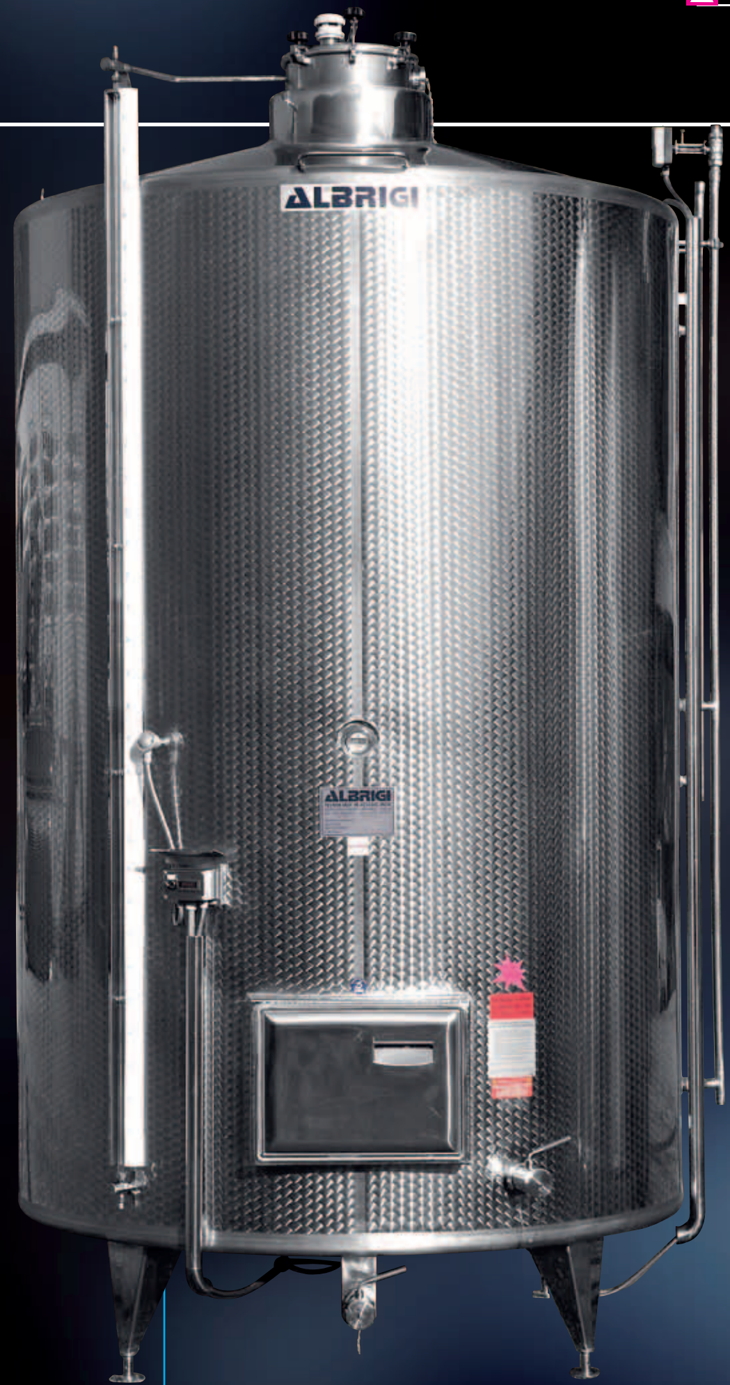
Frigotank, 100 hl, „Termostar“-Doppelwandung, „Isotank“-Isolierung, Temperatursteuerungsaggregat mit motorbetriebenen „Motorwave“-Steuerventil
