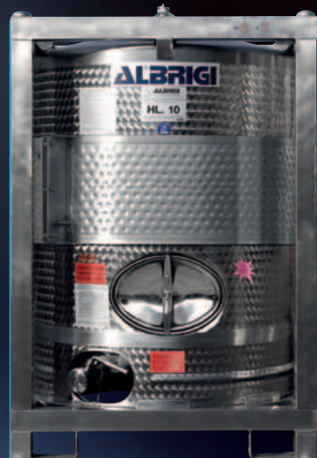
Enopalet 1.070 I mit Termofascia-Doppelwandung aus Edelstahl zur Temperatursteuerung, an bereits vorhandenen, palettierbaren Tanks anzubringen
