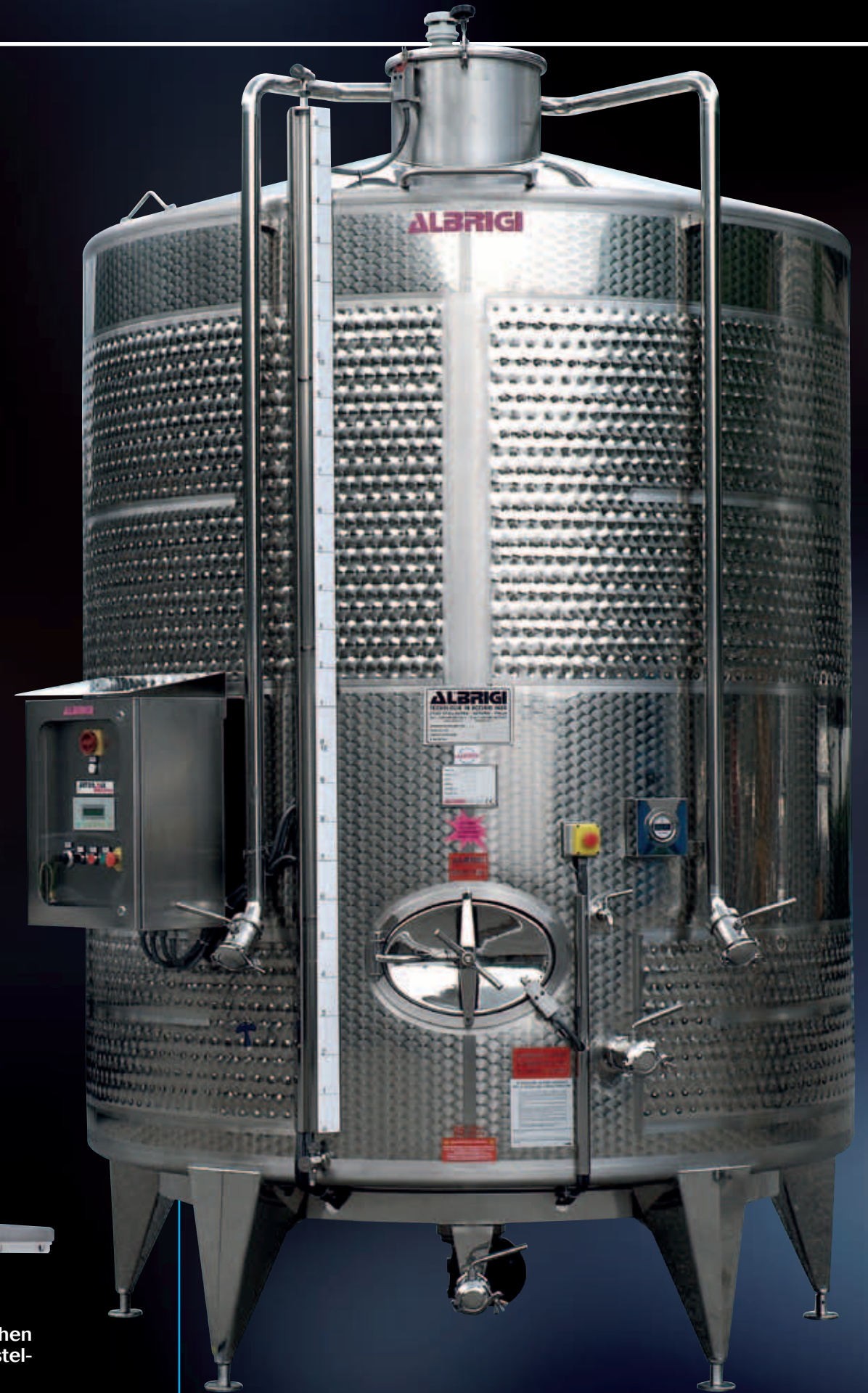
Termotank - Bâtonnage-Tank für die Behandlung der natürlichen Hefen nach der Gärung – ein Patent von Albrigi
