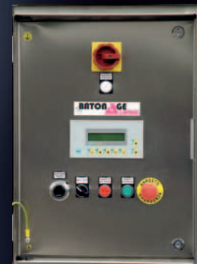
Schalttafel mit SPS mit Drehungsprogrammen, die im Laufe der Zeit individuell angepasst wurden.
