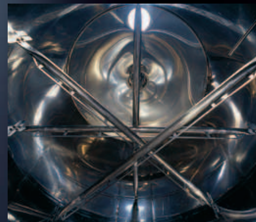
Verstärktes Palitank-Gestänge für Gärtank 600 hl für rote Trauben
