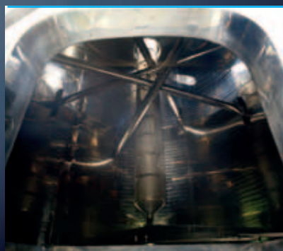
Palitank mit seitlichem, abmontierbarem Abtropfgitterrohr
