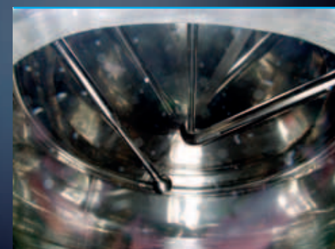
Patentierter Albrigi Superbottom-Boden und Gegenboden mit Sprayball-Reinigungskugel
