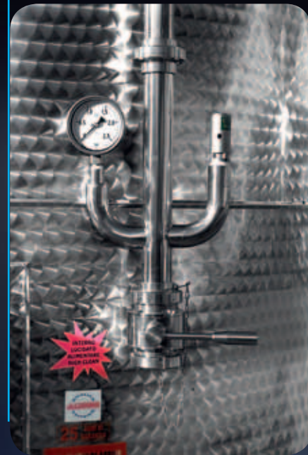
Sicherheitsaggregat mit Manometer und laut PED eingestelltem Sicherheits-ventil
