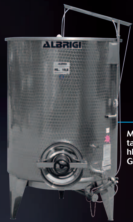
Minitank, 300-550-800-1000-1550 hl, für Lagerung und Gärung, mit Luke ø 300, Mannloch ø 400 und beweglichen Standfüßen
