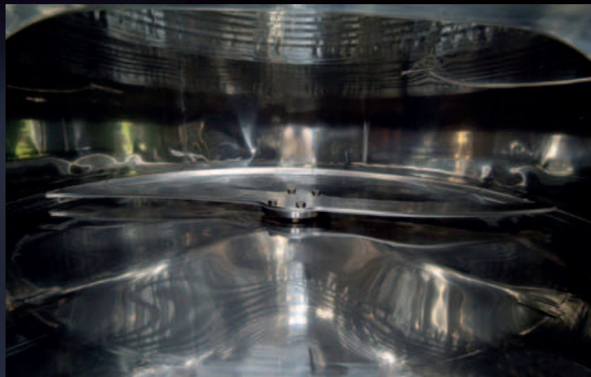
Maischeabflussmechanismus am ebenen Boden mit 3% Schräge nach vorn
