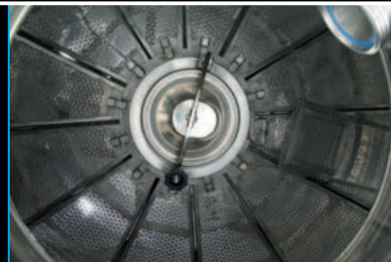
Ansicht von oben mit Abzugsöffnung für den Druck des gärenden Mostes
