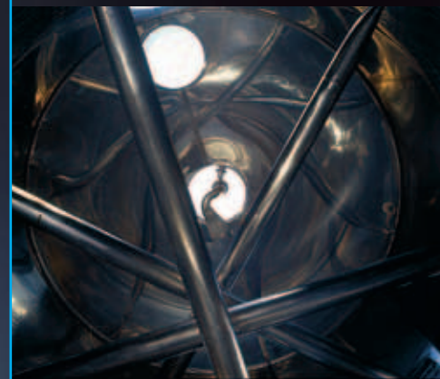
Verstärktes Palitank-Gestänge für Gärtank 600 hl für rote Trauben
