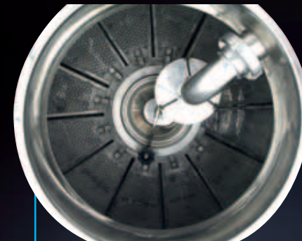
Mostverteilerscheibe über dem Mechanismus zum Eintauchen des Tresterhuts
