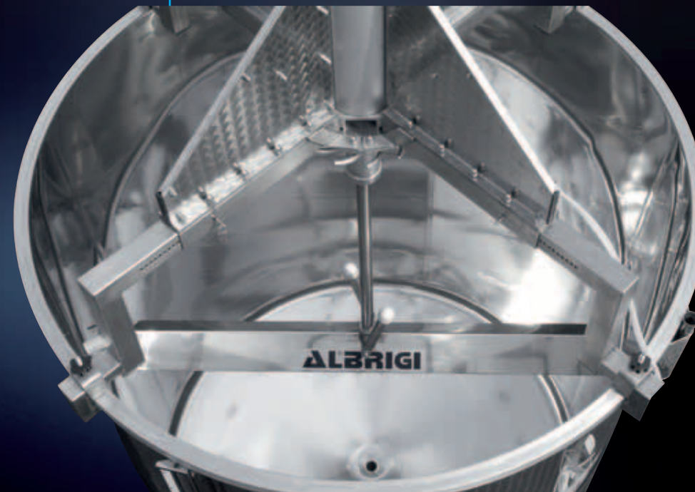
Variofolltank mit verstellbarer Halterung
