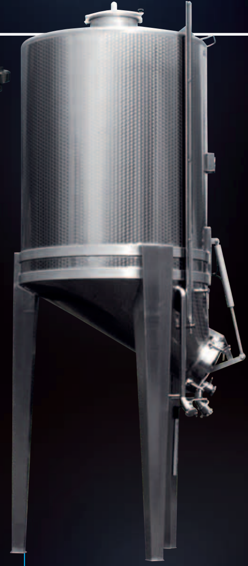
Der Boden in dezentrierter Stumpfkegelform fördert den Abfluss der Maische durch Einwirkung der Schwerkraft
