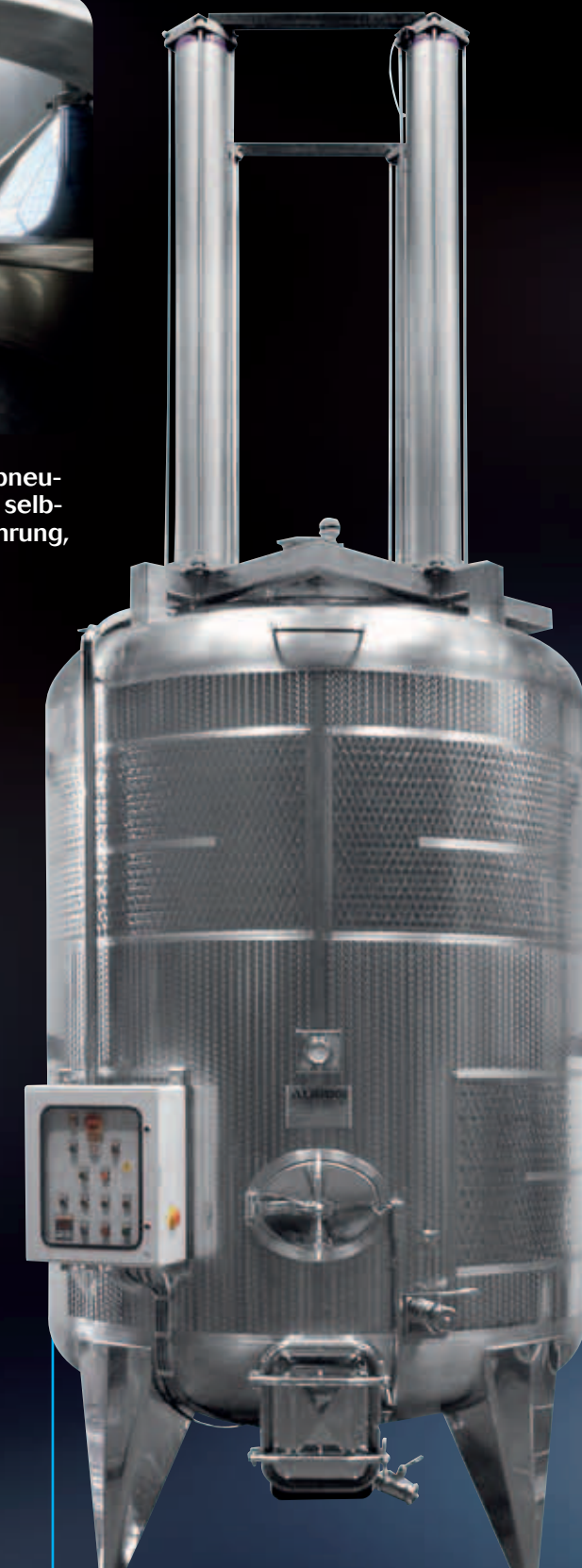
Unterstoßtank mit 4 Pigeage-Füßen in selbstreinigender Spezialausführung mit Druckluftkolben mit langem Hub
