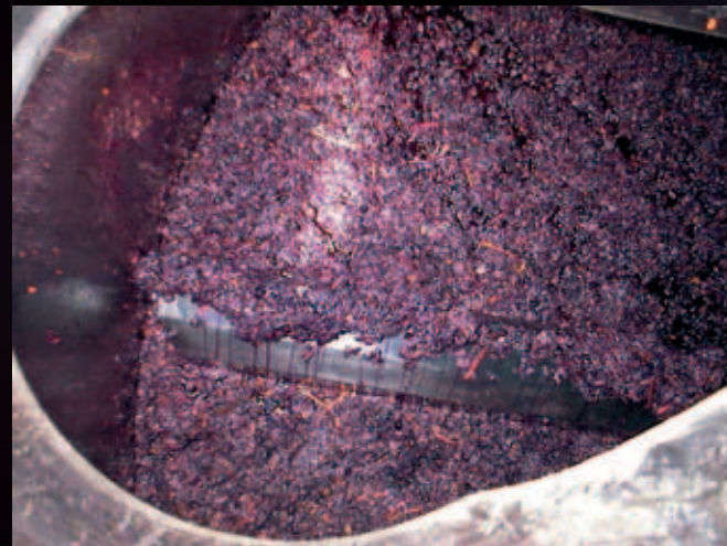
In die Maische eintauchende Unterstoßschaukel, selbstreinigend, Albrigi-Patent
