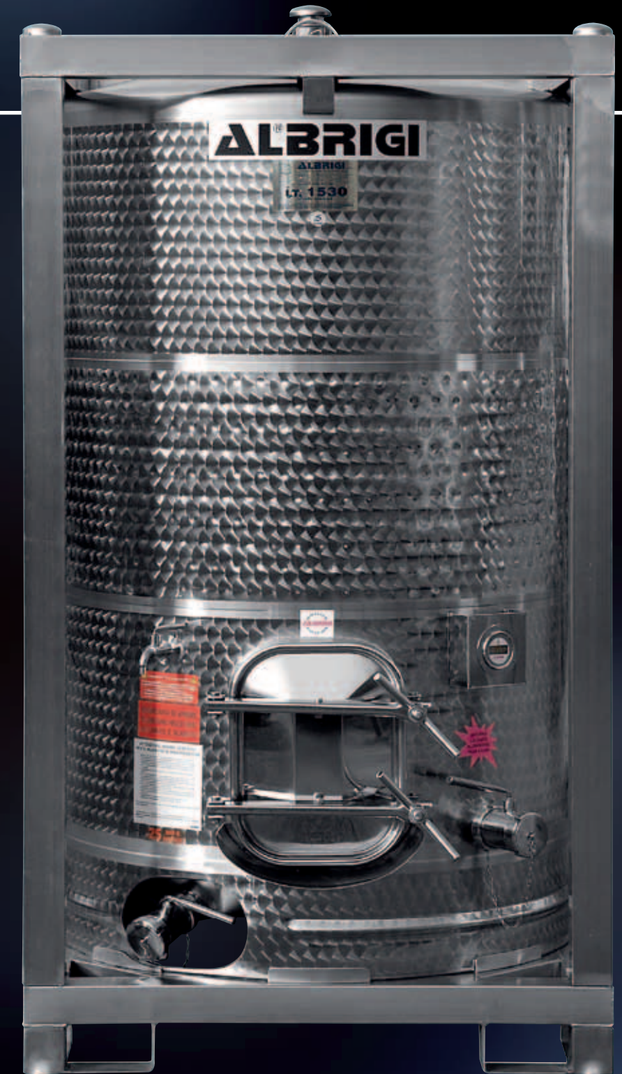
Enopalet-Tank 1.530 I mit rechteckiger Luke und Doppelwandung zur Temperatursteuerung, Thermometer und Temperaturfühler mit 2 Ventilen, ideal für Mikrogärungen
