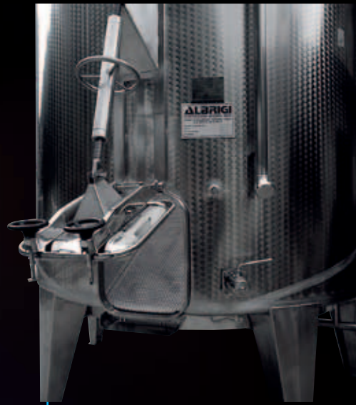
Rechteckige Luke an der Vorderseite mit Öffnungsmechanismus nach oben zum Maischeabfluss
