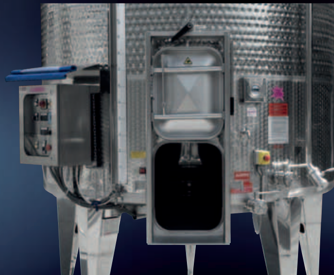
Offene Schiebeluke mit Maischeentnahme-schaukel
