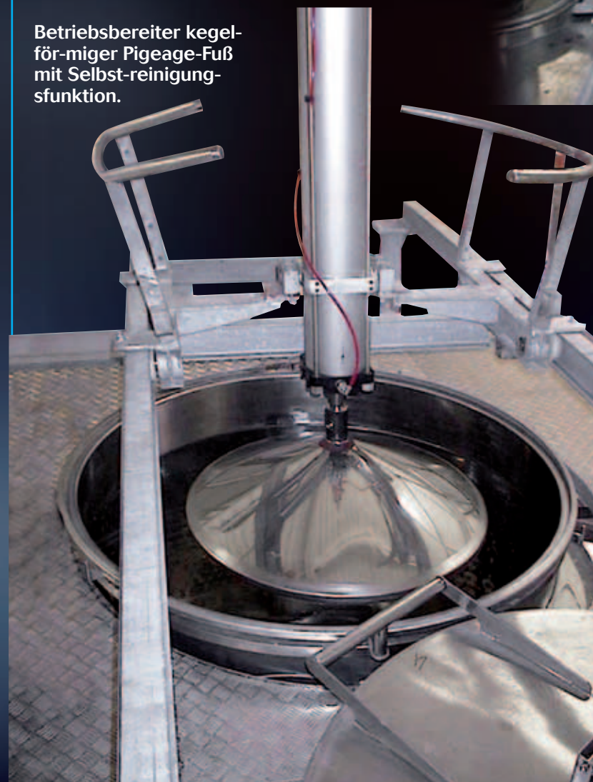
Ansicht Superfollrail mit 20 Gärtanks mit 200 hl Fassungsvermögen und Pigeage-Einzelfuß in Ruhestellung
