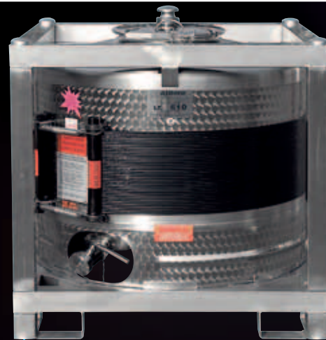
Enopalet-Tank 610 I mit Polifascia-Ummantelung
