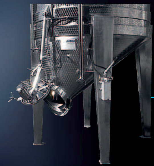
Gravitank - Seitenansicht mit geöffneter Luke, hydraulische Öffnung
