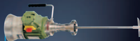
Beweglicher Mobilmix-Rührer, der in das Teilabflussventil einzusetzen ist.
