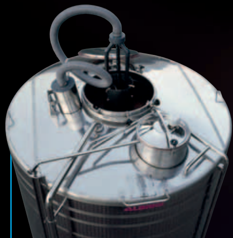
Überspülventil, Anbringung mit internem Sauerstoffanreicherungsgerät und Lüftungsturbine
