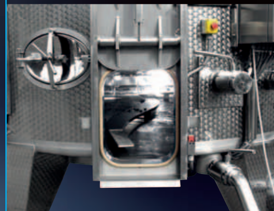
Schiebeluke mit Innenansicht der Entnahmeschaufel
