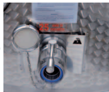
I Valvola con rinforzo anti vibrante
