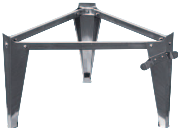
I Cavalletto inox a 3 piedi alto 500 mm, mobile, per fondi piani dei GB Minitank e Semprepiani Mini da lt 300 a lt 1500, smontabile D F E
