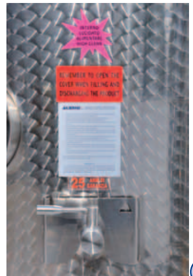
I Valvola di scarico parziale con rinforzo GB D F E
