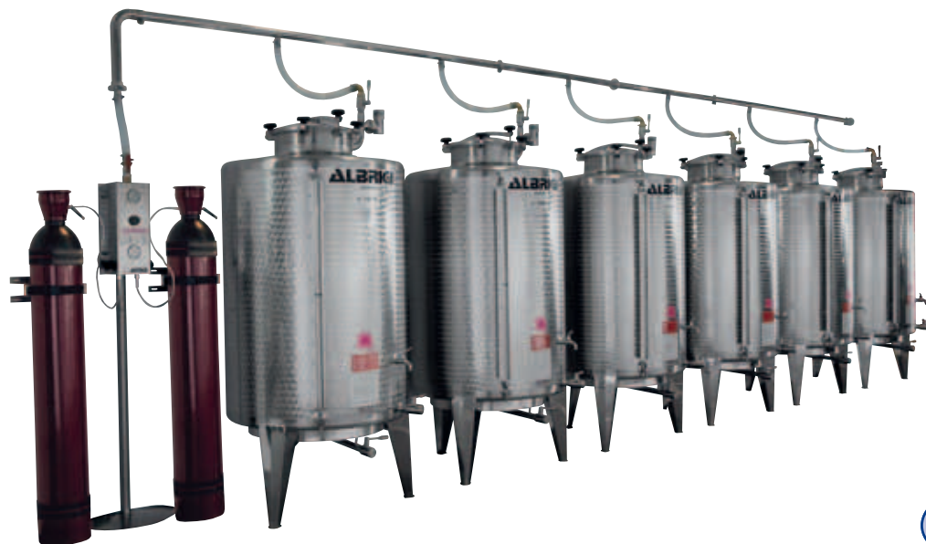
I Batteria di serbatoi da lt 1500 sotto azoto con centralina innergas per lo stoccaggio
