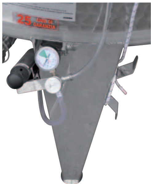
I Pompa per galleggiante, e gancio per fermare la corda di sollevamento
