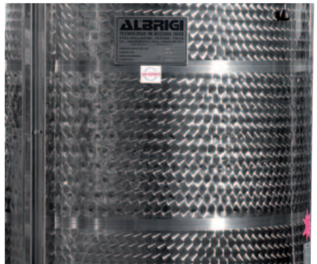
I Intercapedine di condizionamento Termostar posta al centro del fasciame
