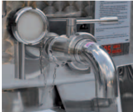
I Valvola di scarico parziale con curva GB Partial drain valve with bend D Teilauslassventil mit Kurve F Vanne de tirage au clair avec coude E Válvula de descarga parcial con curva.
