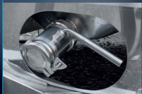
Valvola di scarico totale in acciaio inox, protetta, di Enopalet
