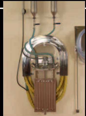
Piastra mobile termoplastra per il chiusino di Enopalet
