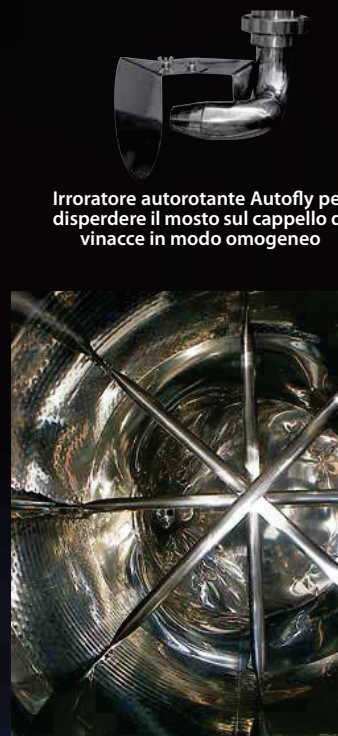
Palitank per fare il délastage e rompere il cappello durante la fase di fermentazione, ma molto utile per favorire lo scarico delle vinacce a fine fermentazione
