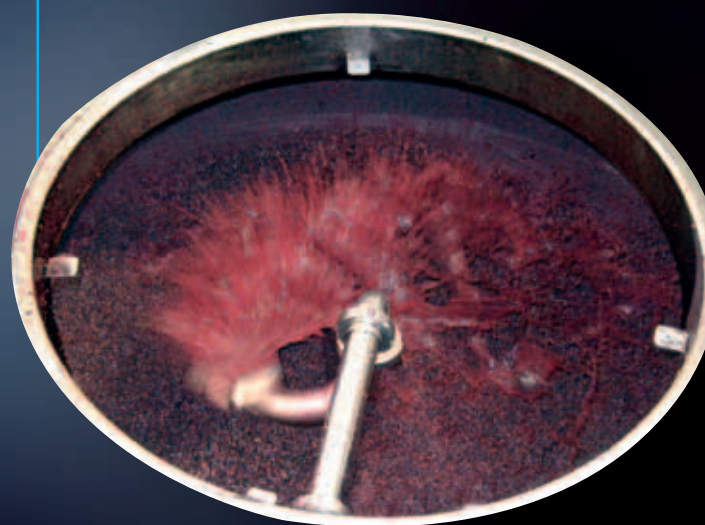
Irratore Autofly autorotante tipo Mono con il mosto
