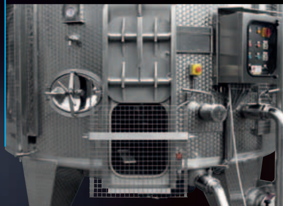
Porta a ghigliottina con vista interna della pala di estrazione
