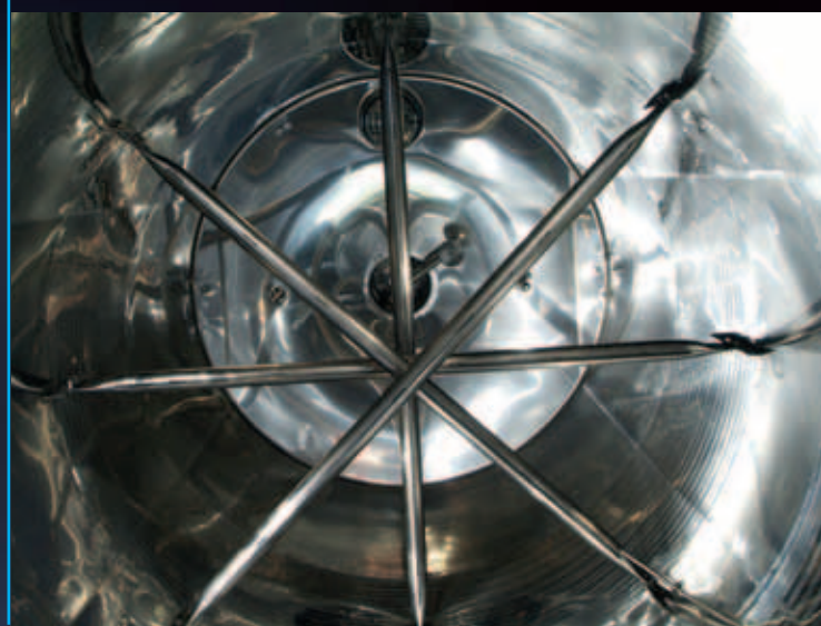
Irratore Autofly autorotante tipo Mono con il mosto
