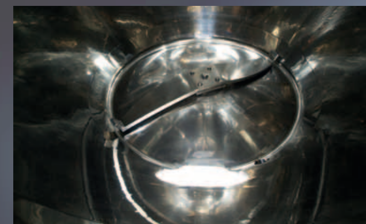
Vista interna di pala di estrazione lucida a specchio
