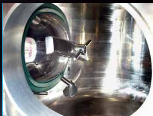
Portella aperta con braccio di sostegno interno
