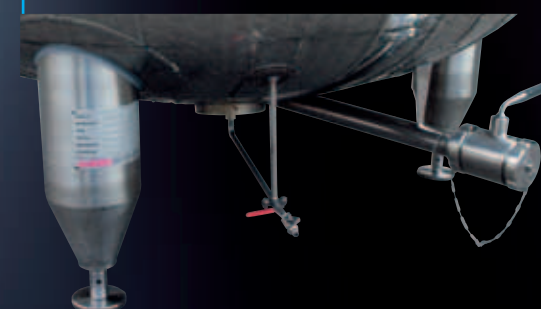
Dispositivo di iniezione della CO 2 con valvola di non ritorno inox di esclusione
