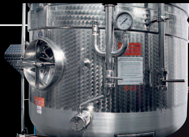
Gruppo di sicurezza con valvola tarata PED
