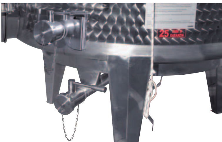
I Fondo conico a scarico totale centrale e scarico parziale entrambi con valvola sfera piena inox
