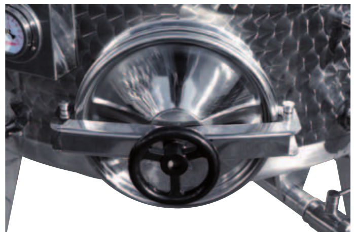
I Portello \varnothing 300 apertura esterna posta a filo fondo poco sporgente
