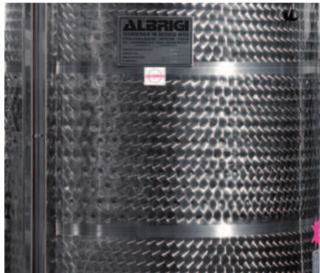
I Intercapedine di condizionamento Termostar posta al centro del fasciame
