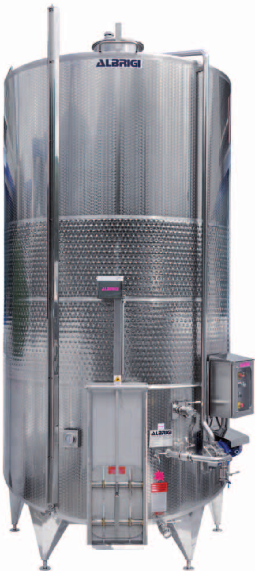
T Fermentatore SPECIALTANK "S", completo di tutti gli accessori per fare la fermentazione, con intercapedine, rimontaggio automatico e porta a ghigliottina elettrica
