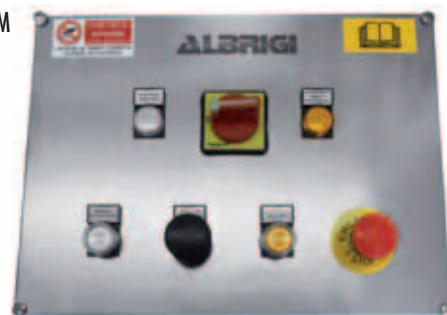
I Quadro elettrico con variatore elettronico di velocità del motore
