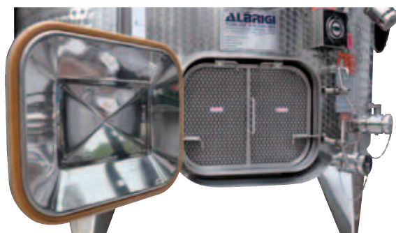
I Porta rettangolare a filo fondo inclinato, con la griglia fermabuccia montato GB D F E
