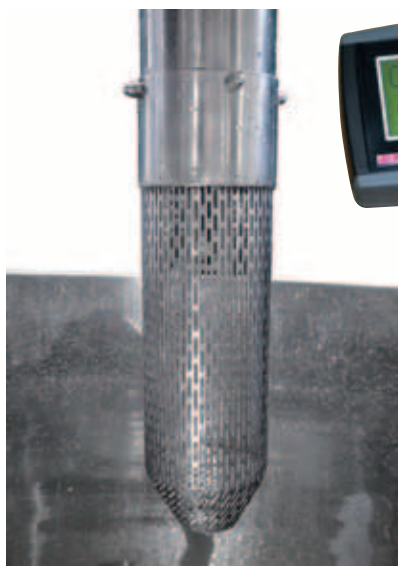
I Filtro inferiore per fermare le vinacce e i vinaccioli GB Lower filter to hold back marc and grape-stones D Unterer Filter um Trester und Traubenkernen zurückzuhalten F Filtre inférieur pour arrêter le marc et les pépins E Filtro inferior para detener los orujos y las pepitas
