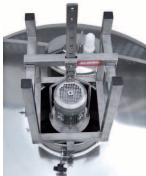
I Meccanismo di sostegno e di bloccaggio sul chiusino di MOBILSYSTEM regolabile
