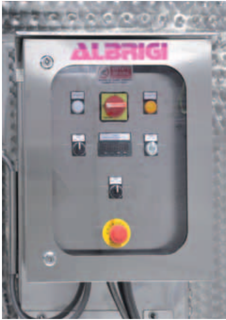
I Quadro elettrico di comando delle fasi di rimontaggio della pompa GB D F E
