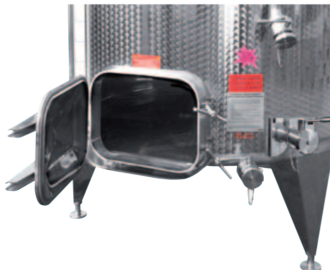
I Portello rettangolare da mm 530 x 420 posto in orizzontale a filo fondo apertura esterna con il bavero antigoccia inferiore, doppio traverso e volantini inox GB D F E
