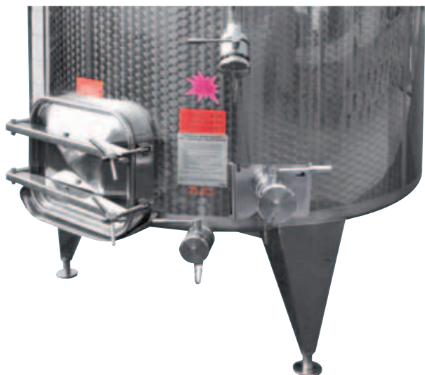
I Portello rettangolare da mm 530 x 420 posto in orizzontale a filo fondo apertura esterna con il bavero antigoccia inferiore, doppio traverso e volantini inox GB D F E
