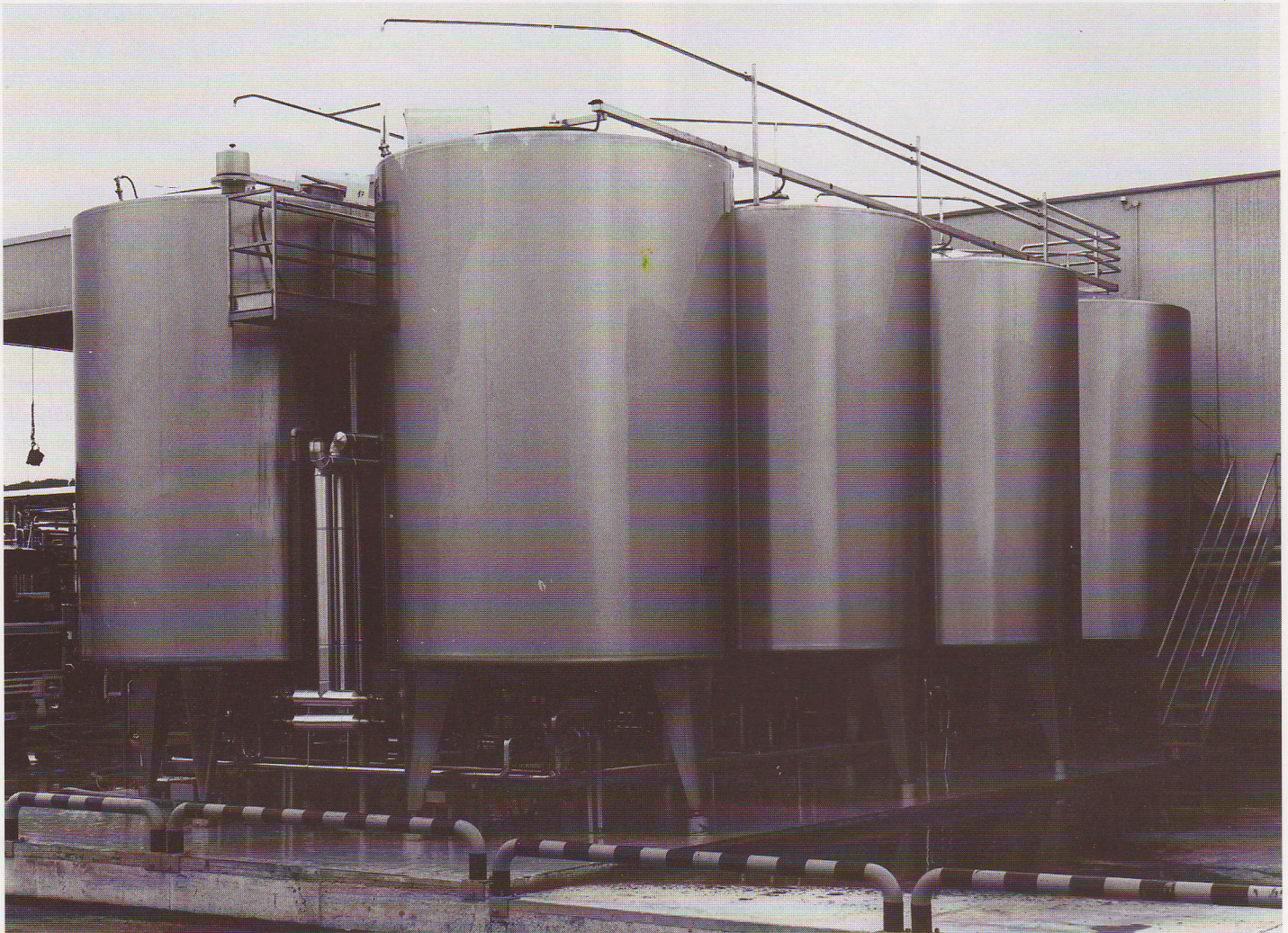
Impianto di stoccaggio per prodotti alimentari, termocondizionato e isolato Storage plant for food product, temperature controlled and insulated Isolierte Lagerungsanlage für Lebensmittel mit Temperaturregelung
