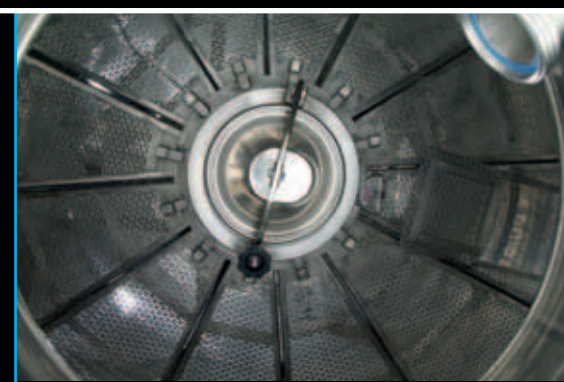
Vista superiore con portella di sfiato della pressione del mosto in fermentazione
