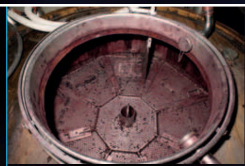
Meccanismo di cappello sommerso su tino in legno, smontabile dall'esterno
