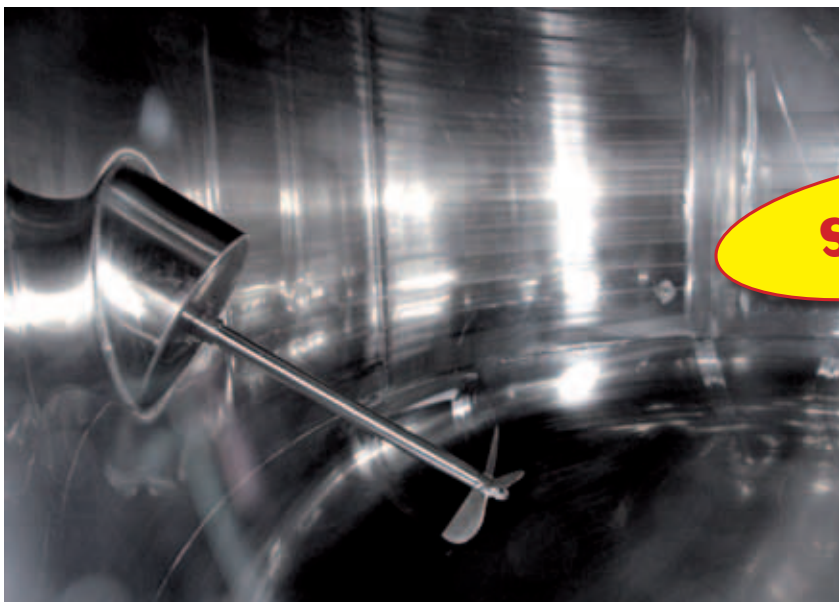
I Vista interna di agitatore laterale SIDEMIX con elica profilo marino ELIMIX
