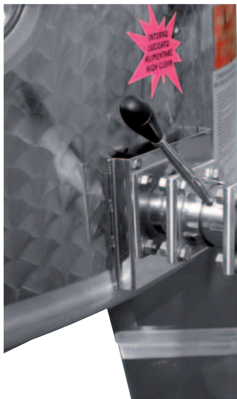
I Valvola decantatrice applicata su scarico parziale
