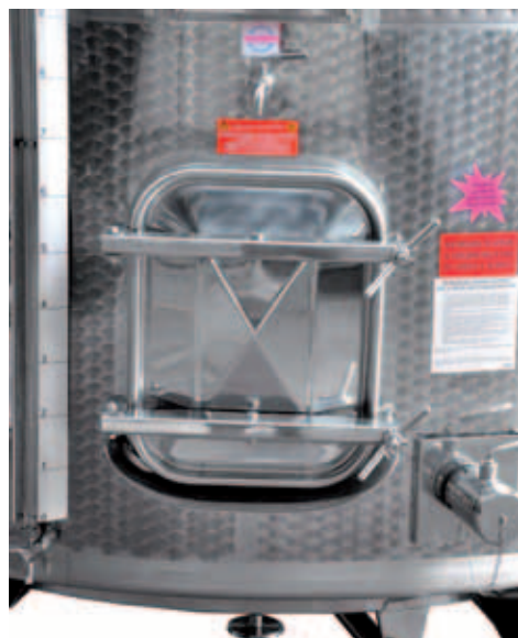
I Portello rettangolare da mm 530x420 verticale apertura esterna
