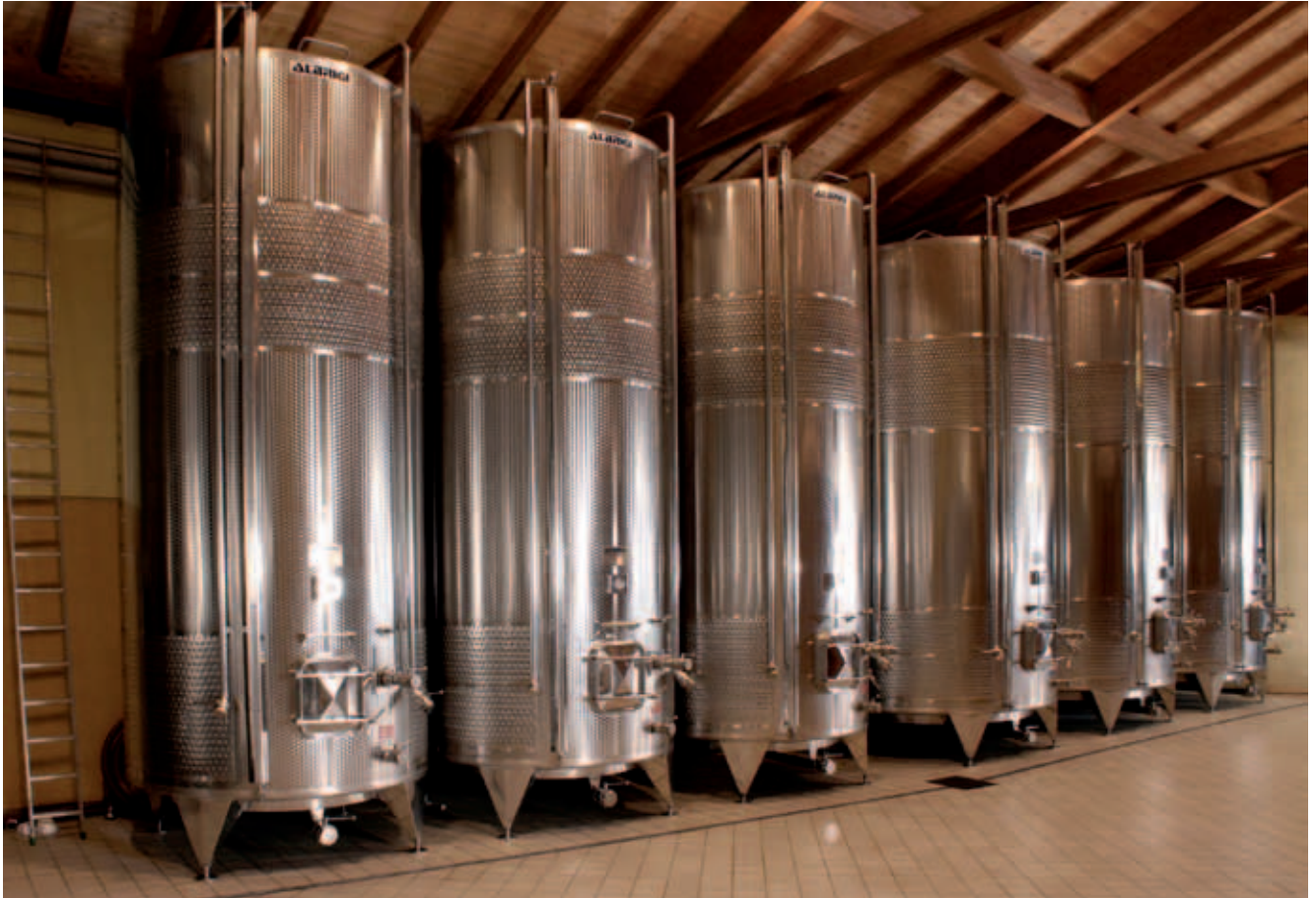
TERMOTANK con doppio intercapedine TERMOSTAR da lt 20.000
