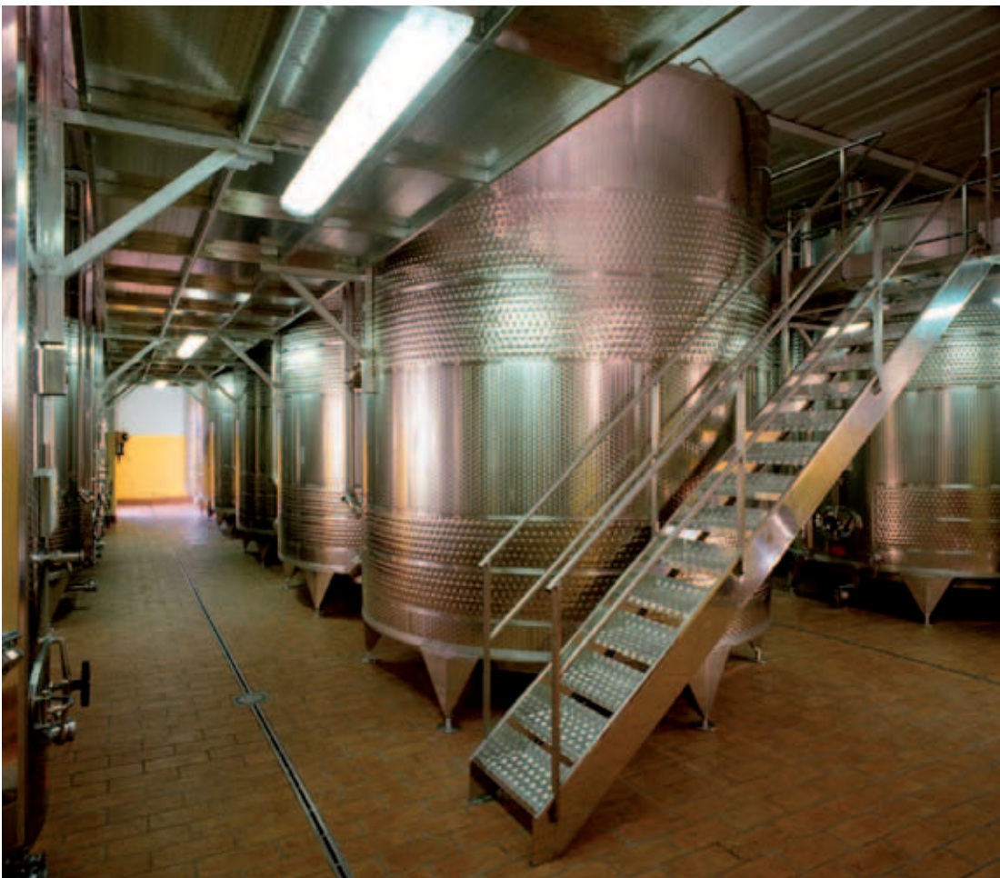
TERMOTANK con doppia intercapedine TERMOSTAR da lt 30.000
