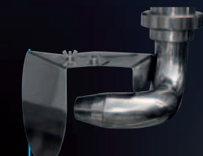
Irroratore autorotante Autofly per disperdere il mosto sul cappello di vinacce in modo omogeneo
