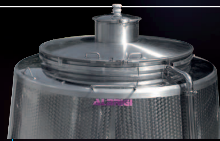
Chiusino ermetico molto grande con la chiusura a fascetta regolabile con sgancio rapido
