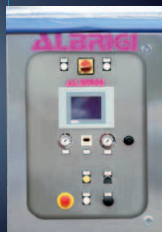
Quadro elettrico in acciaio inox con tenda di protezione in Pvc arrotolabile e Plc che programma tutte le fasi di pausa/lavoro
