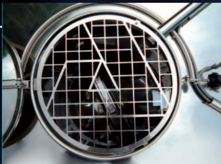
Chiusino superiore con gabbia di protezione e micro di sicurezza
