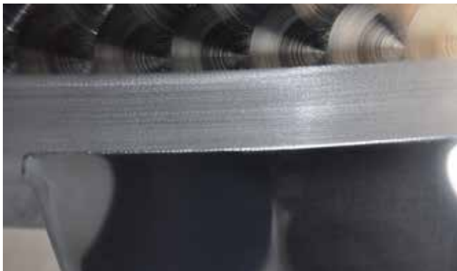
TIG welding of foot to bottom of tank Saldatura a TIG di piede sul fondo
