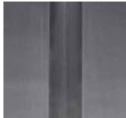
Rolled and mirror polished interior Tig/plasma welding on mirror polished sheet metal 2R finish 0.06 Micron roughness Saldatura a Tig/plasma interna rullata e lucidata a specchio su lamiera lucidata a specchio finitura 2R rugosità 0,06 Micron
