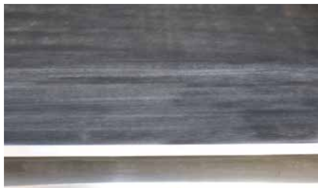
Trimmed and mirror polished interior welding of door Saldatura interna di portella rasata e lucidata a specchio.
