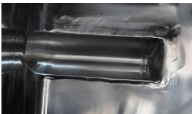
Interior welding of total drain, flute mouth polish Saldatura interna di scarico totale, lucida a bocca di flauto
