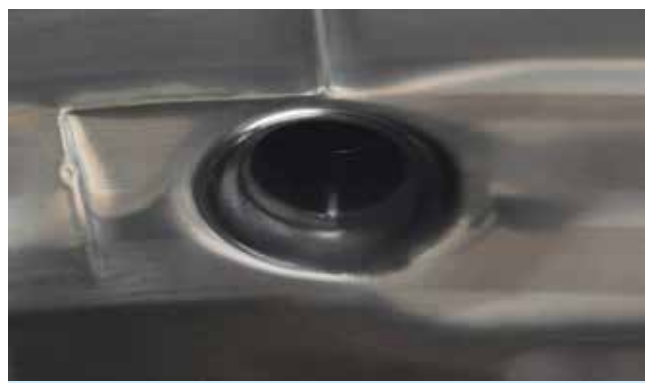
Din welding on inside of sleeve, trimmed and mirror polished. Saldatura interna di manicotto din, rasata e lucidata a specchio
