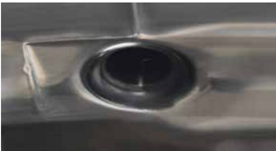
Saldatura interna di un manicotto din, rasata e lucidato a specchio
