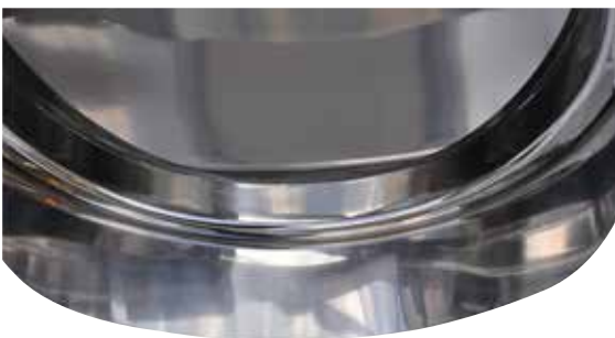
Saldatura interna, rasata e lucidata, di una portella tonda
